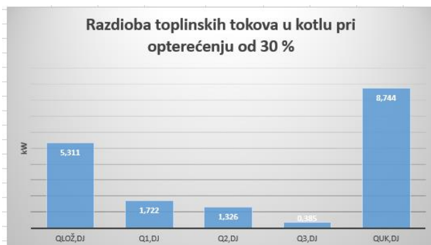
Slika 9. Razdioba toplinskih tokova kotla pri djelomičnom opterećenju
