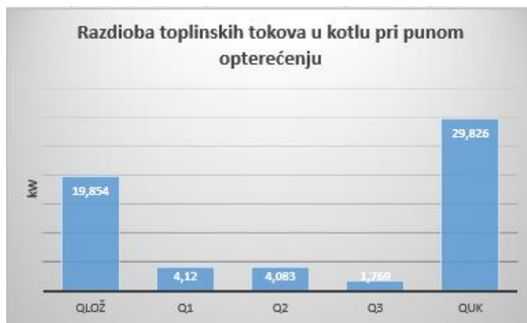
Slika 8. Razdioba toplinskih tokova
