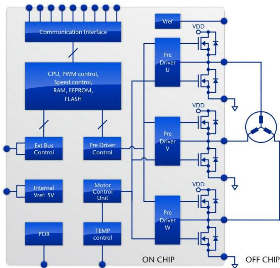
**Slika 5. Principijelna shema kontrolera BLDC elektromotora [18]**
