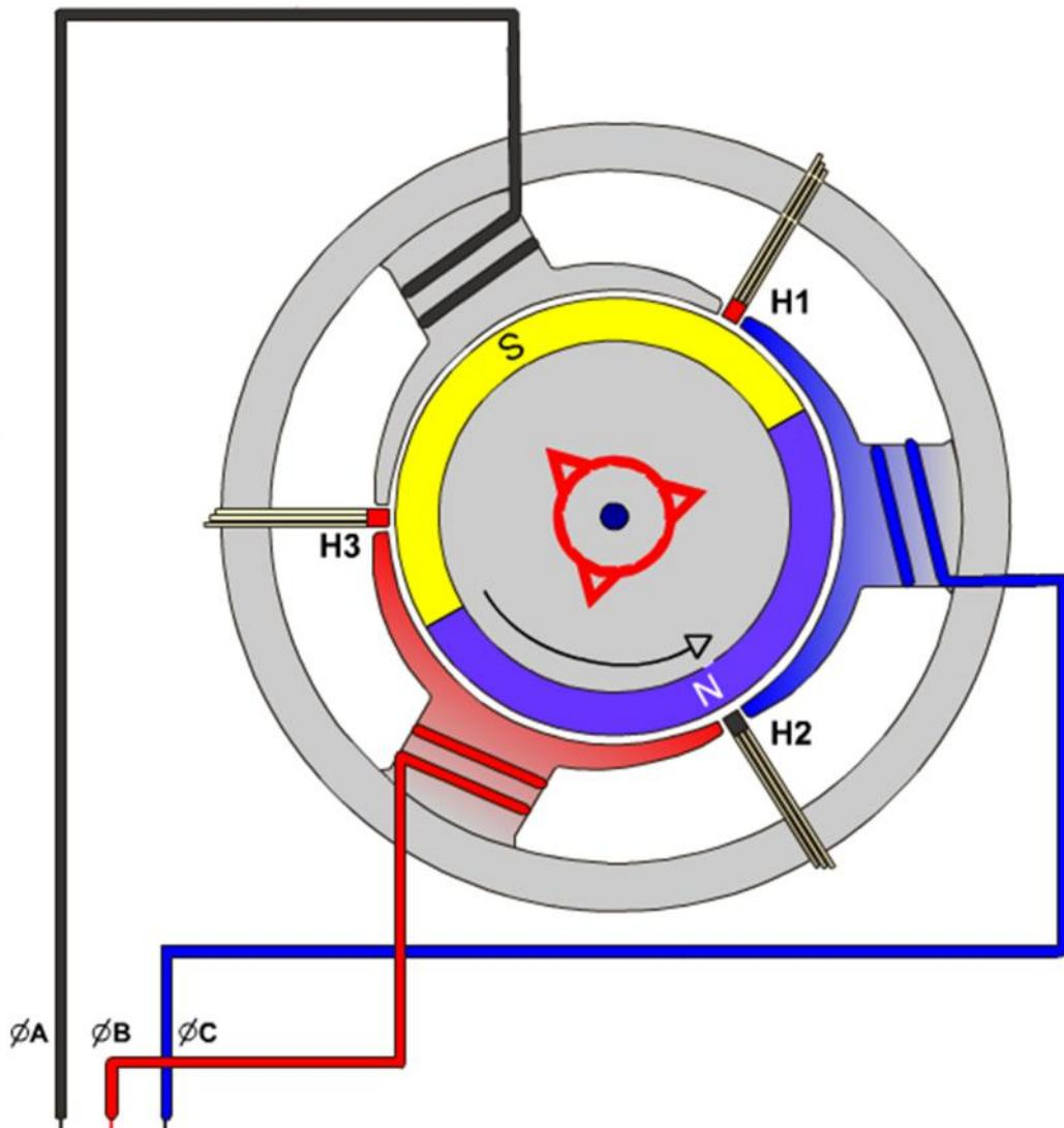
**Slika 4. Principijelna shema dvopolnog BLDC elektromotora [13]**
