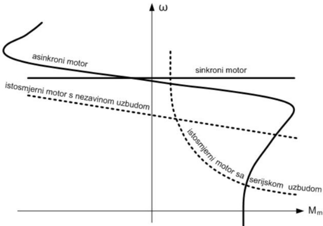
**Slika 3. Vanjske karakteristike različitih tipova elektromotora [8]**
