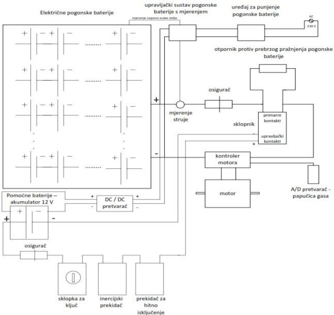
Slika 2. Blok-shema elemenata vozila na elektri ni pogon [8]
