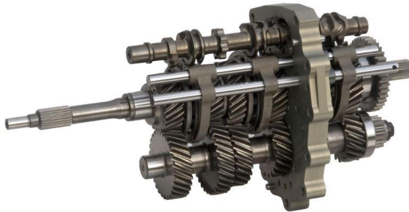
Slika 4. Prijenosnik sa skokovitom promjenom prijenosnog omjera
