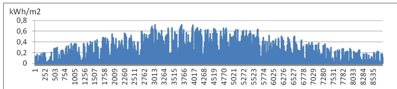
**Dijagram 26.** Satna proizvodnja toplinske energije na ravnoj površini u godini, kWh/m<sup>2</sup>
