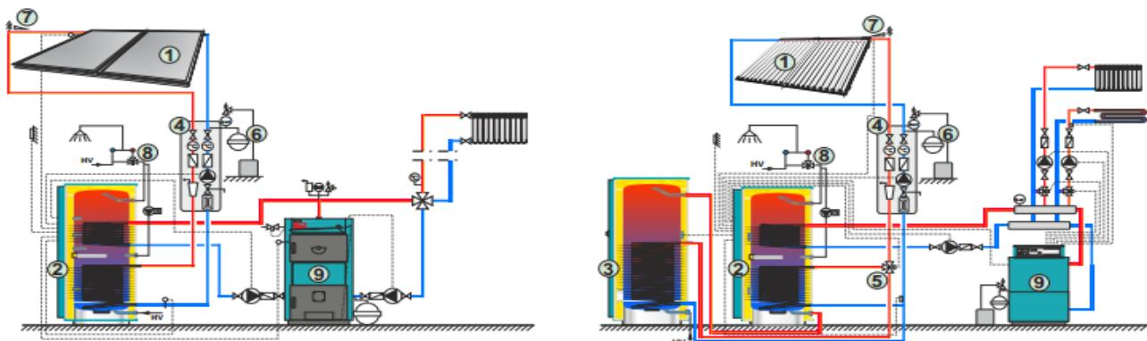
**Slika 9.** Načelna shema solarnog sustava za zagrijavanje PTV za obiteljsku kuću(lijevo), za veće objekte(desno), 1) kolektori, 2) solarni bojler, 3) akumulacijski bojler, 4) solarne pumpe, 5) ventili, 6) ekspanzijska posuda solarnog kruga, 7) solarni lončić, 8) ventil za PTV, 9) kotao
