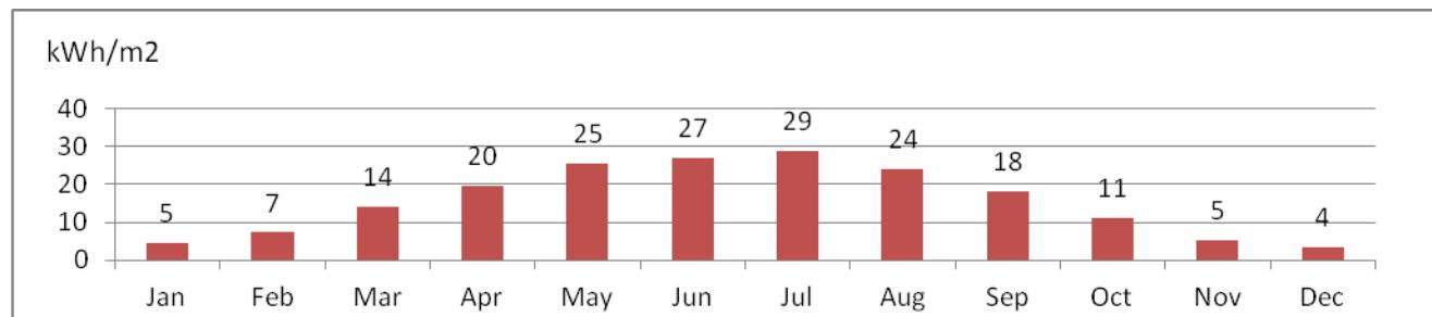
**Dijagram 25.** Mjesecačna proizvodnja električne energije na površini  $30^\circ$ , kWh/m<sup>2</sup>
