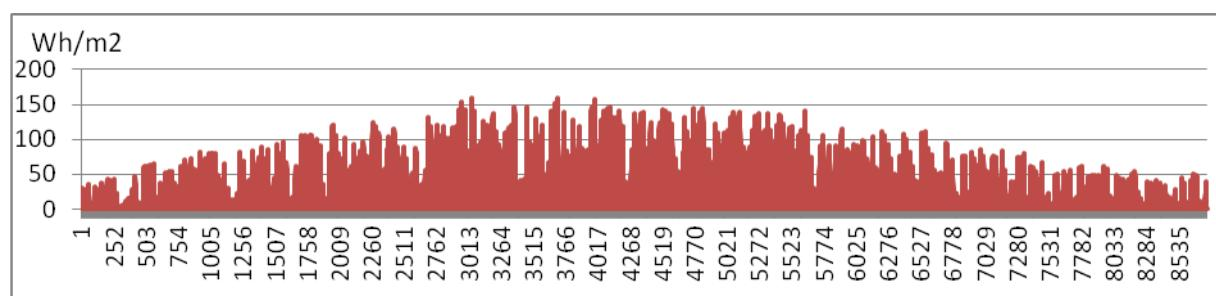
**Dijagram 24.** Satna proizvodnja električne energije na ravnoj površini u godini,  $\text{Wh}/\text{m}^2$
