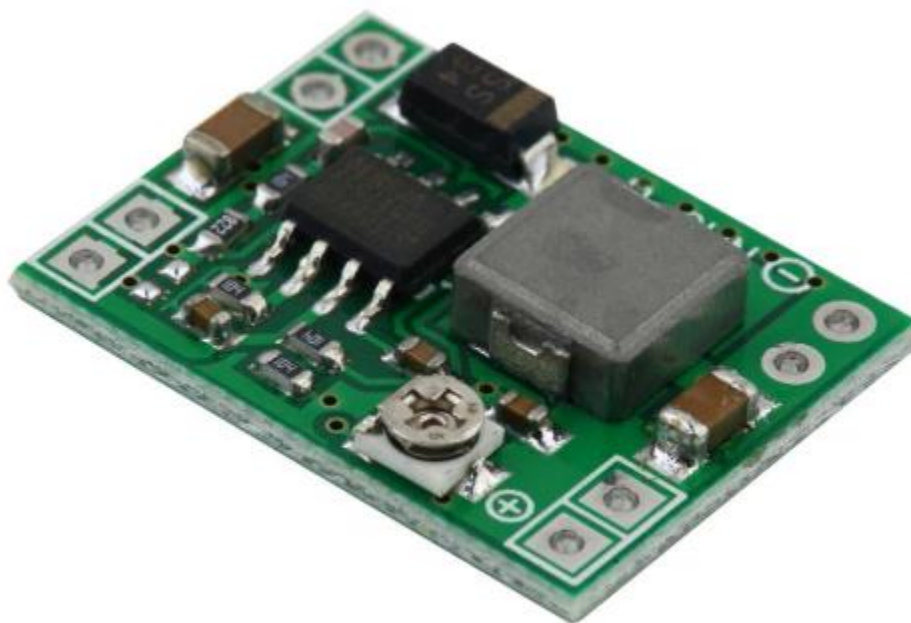
Slika 14. DC-DC modul napajanja
