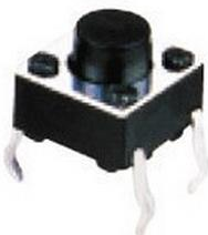
Slika 22. Taster za pločicu
