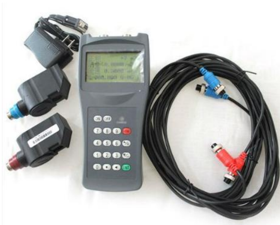
Slika 11. Ispitivano ultrazvučno mjerilo protoka [7]
