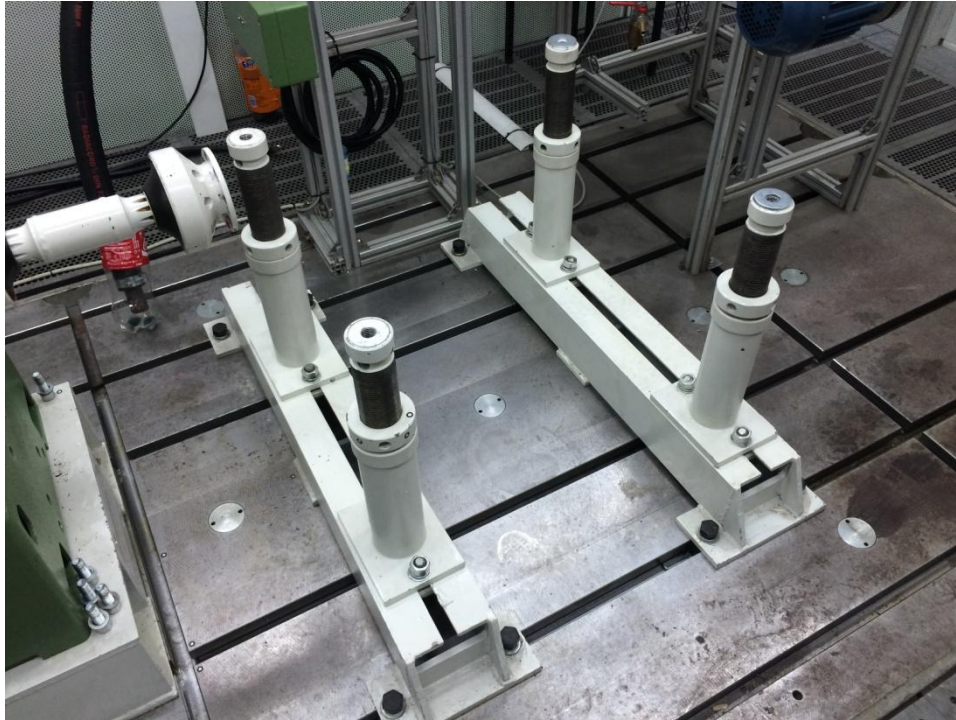
Slika 22: Podesivi stupovi za prihvat motora, Laboratorij za motore i vozila
