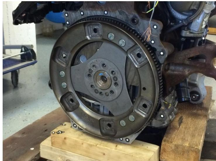
Slika 18: Zamašnjak motora PSA DW10C
