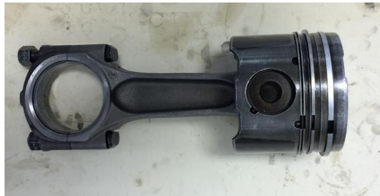
Slika 5: Klipni mehanizam
