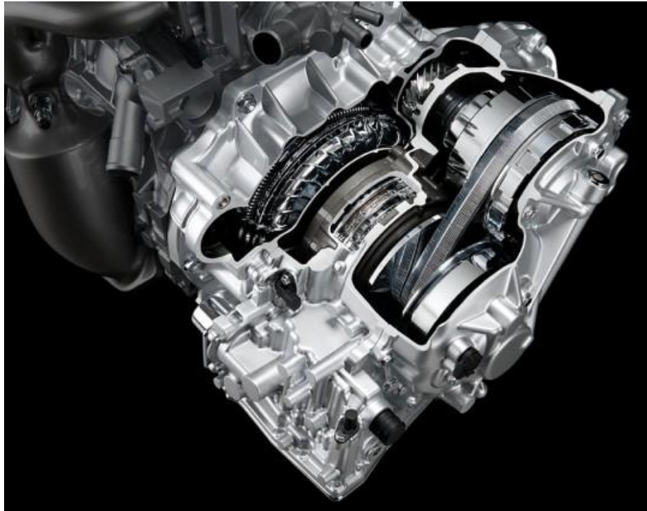
Slika 3 - Remenski varijator ugrađen u Nissan Murano
