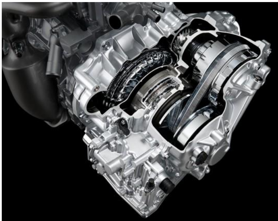
Slika 3 - Remenski varijator ugrađen u Nissan Murano
