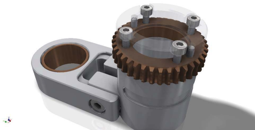
Slika 25. Prihvata i pozicioniranje pužnog kola na sklop čeljusti za rotaciju
