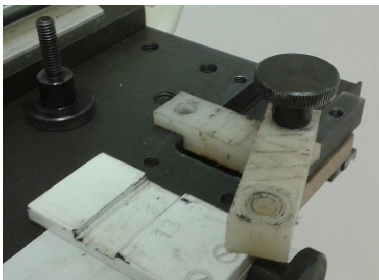
Slika 5: Polimerne pločice za pritezanje trake
