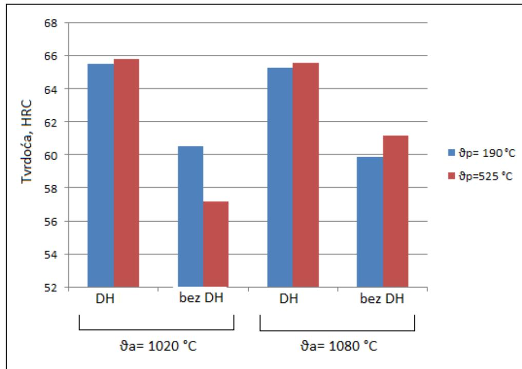
Slika 26. Izmjerene tvrdoće uzorka za abrazijsko ispitivanje[13]
