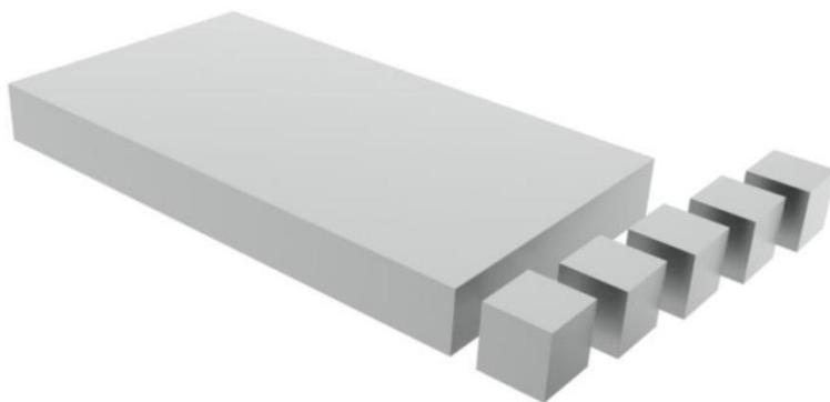
**Slika 12. Skica izrade uzorka za erozijsko ispitivanje [11]**
