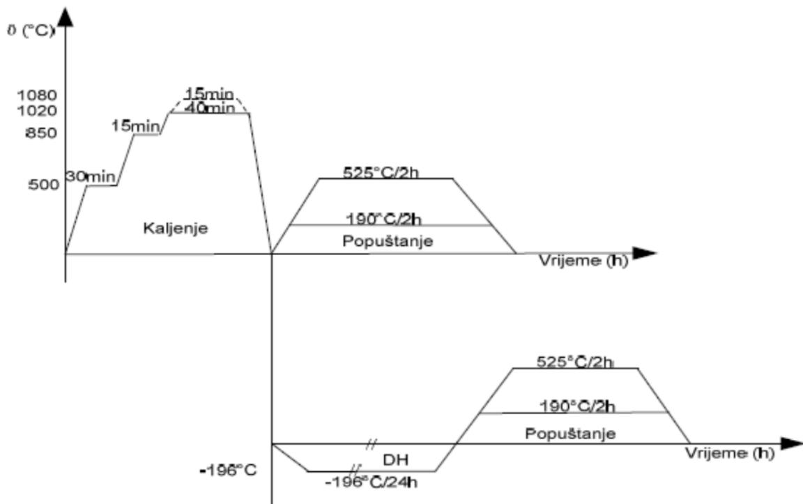
Slika 14. Dijagram toplinske obrade uzorka za abrazijsko i erozijsko ispitivanje
