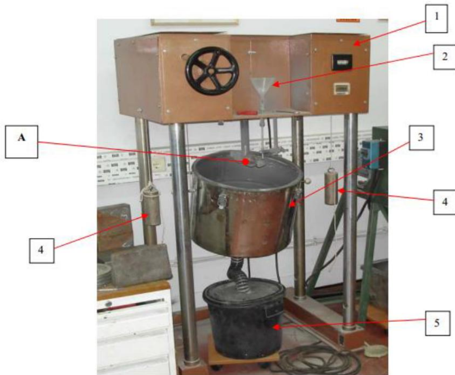
Slika 15. Uređaj za ispitivanje otpornosti na eroziju[11]
