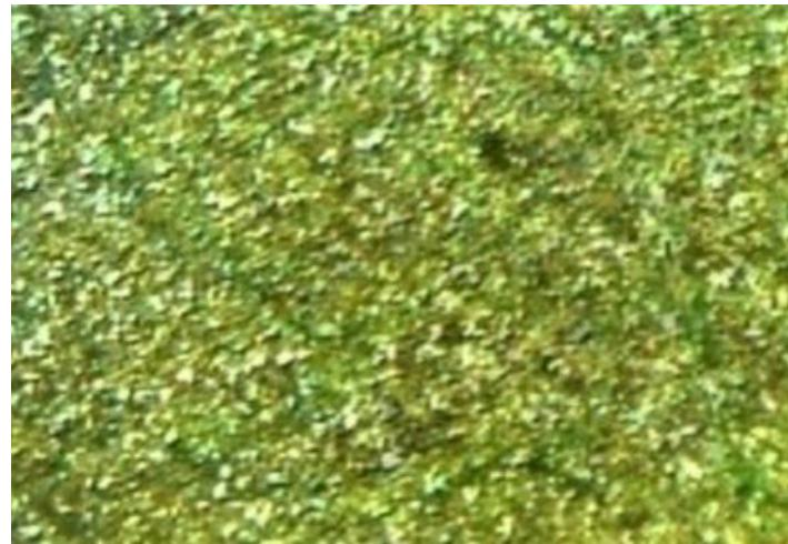
Slika 6. Mikrostruktura konvencionalno obrađenog alatnog čelika (kaljenje+popuštanje) [8]
