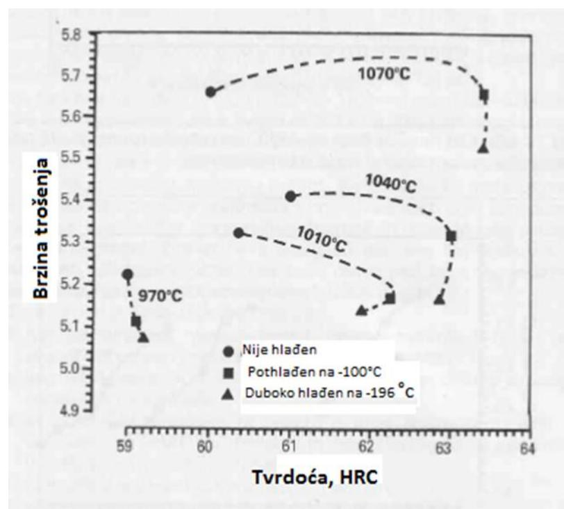
Slika 11. Međuvisnost tvrdoće, brzine trošenja i režima ohlađivanja alatnog čelika[10]
