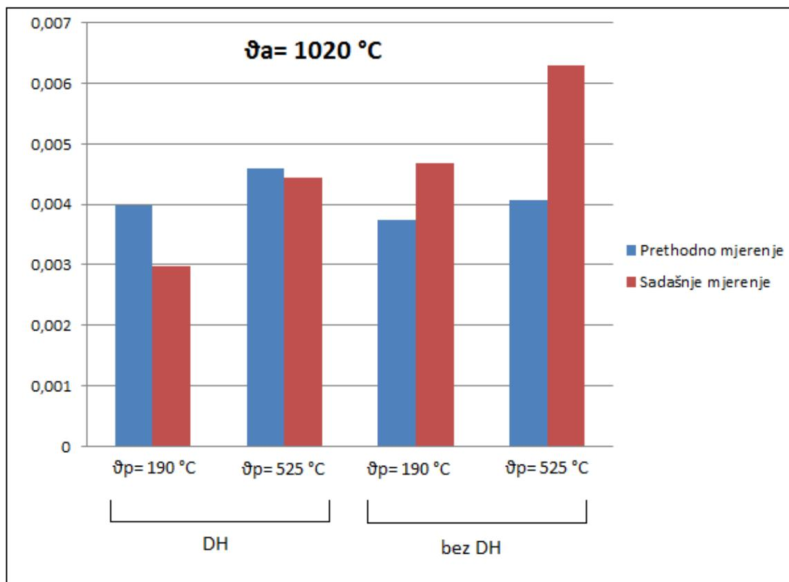
**Slika 20. Usporedba rezultata prethodnih i vlastitih ispitivanja erozijskog trošenja u trajanju od 15 minuta za skupine uzoraka od čelika X155CrNiVMo 12-1 sa temperaturom austenitizacije  $\theta_a= 1020\text{ }^\circ\text{C}$**
