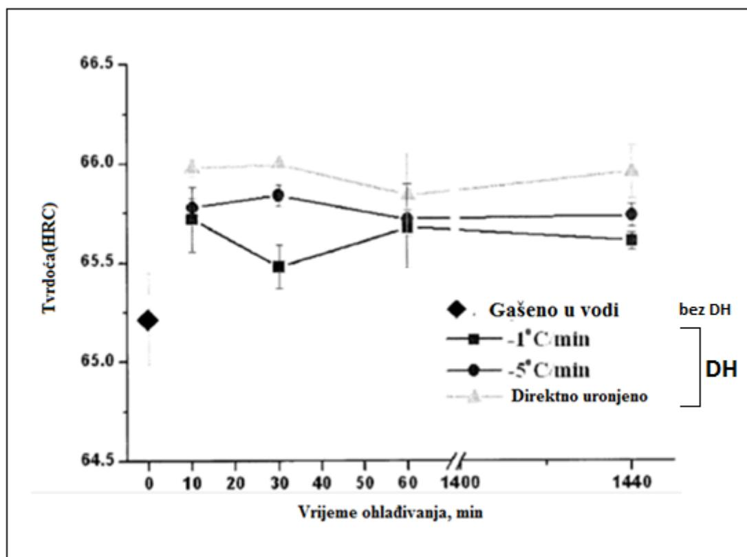
Slika 8. Utjecaj brzine gašenja i vremena držanja na temperaturi hlađenje na tvrdoću alatnog čelika X155CrNiVMo 12-1 [3]
