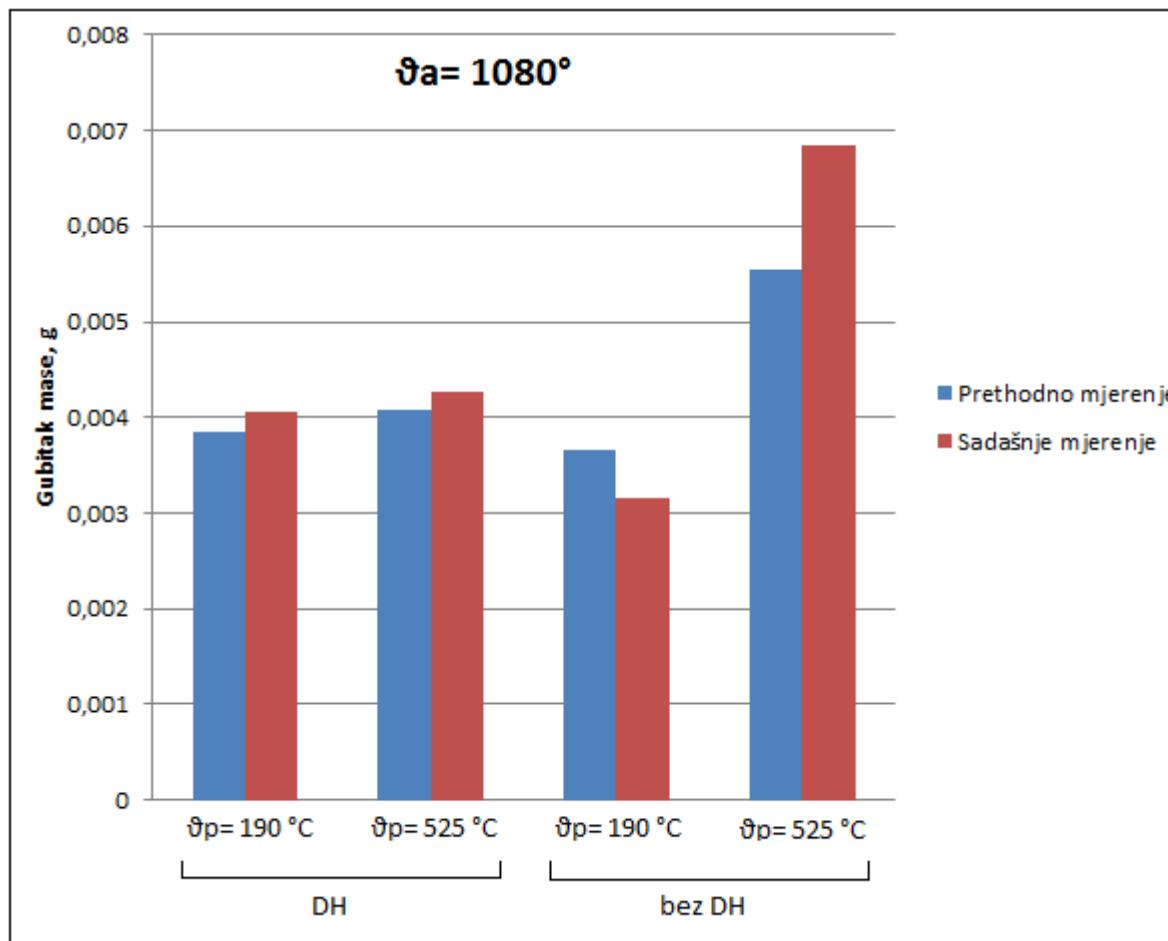
**Slika 21. Usporedba rezultata prethodnih i vlastitih ispitivanja erozijskog trošenja u trajanju od 15 minuta za skupine uzoraka od čelika X155CrNiVMo 12-1 sa temperaturom austenitizacije  $\vartheta_a= 1080\text{ }^{\circ}\text{C}$**
