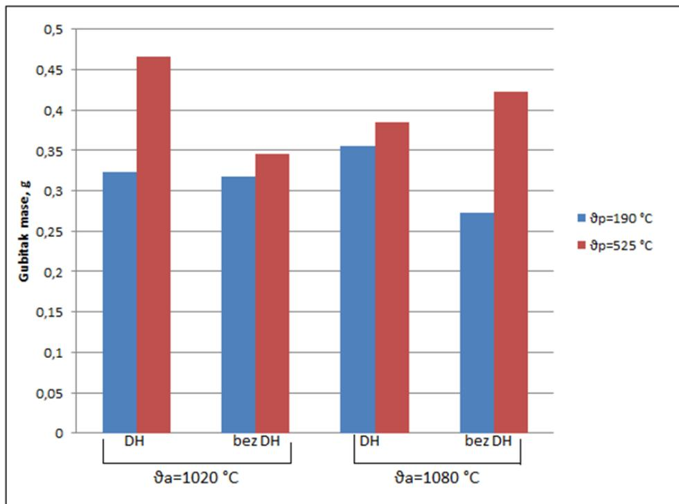
Slika 25. Prosječni ukupni gubici masa (nakon 3000 okretaja) za svaku skupinu uzorka nakon provedenog abrazijskog ispitivanja
