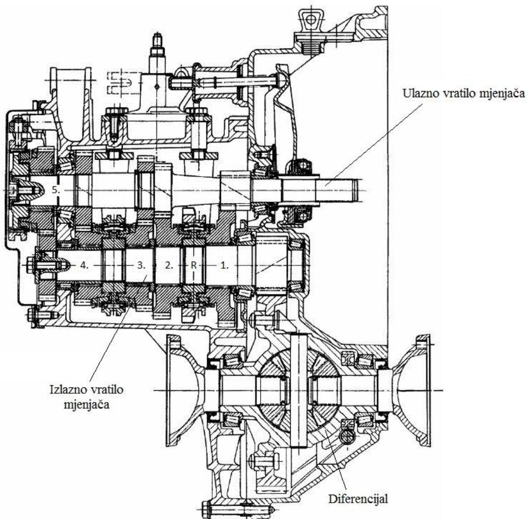
**Slika 4      5 – stupanjski ručni mjenjač VW MQ**
