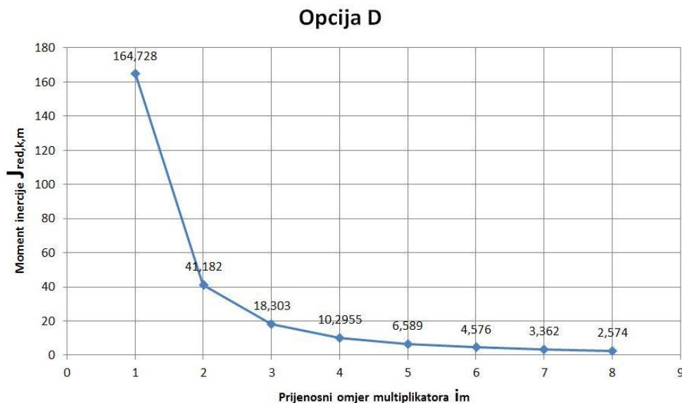
Slika 19 Vrijednosti reduciranog momenta inercije za različite prijenosne omjere multiplikatora
