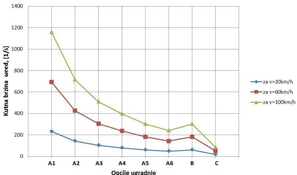
Slika 16 Vrijednosti kutne brzine zamašnjaka za različite opcije ugradnje i različite brzine vožnje vozila
