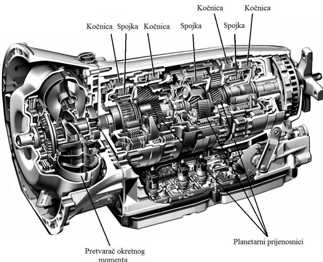
**Slika 9 – stupanjski automatski mjenjač za putničke automobile Mercedes – Benz W7A 700**
