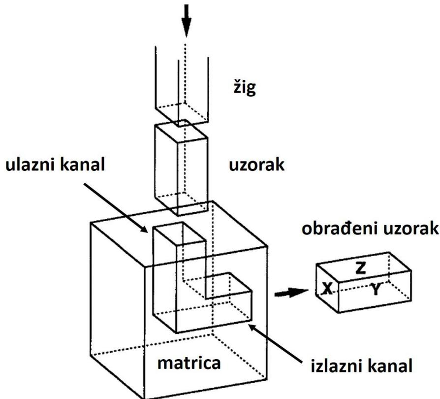
Slika 9 - Shematski prikaz alata za kutnu ekstruziju [15]
