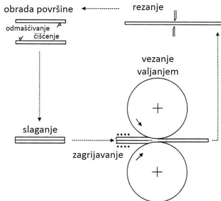
Slika 5- Dijagramski prikaz procesa kumulativnog valjanja [10]
