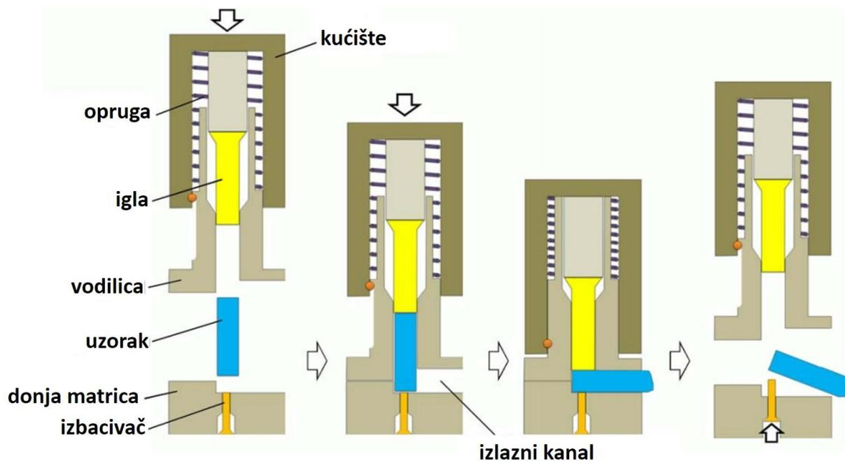
Slika 21 - Shematski prikaz principa kontinuirane kutne ekstruzije [23]
