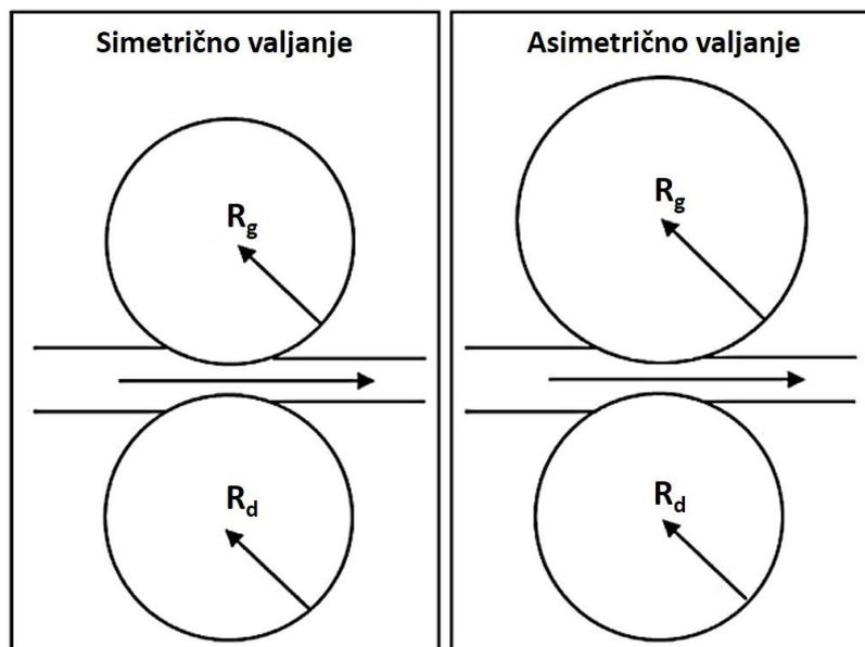
Slika 7 - Shematski prikaz procesa simetričnog i asimetričnog valjanja [12]
