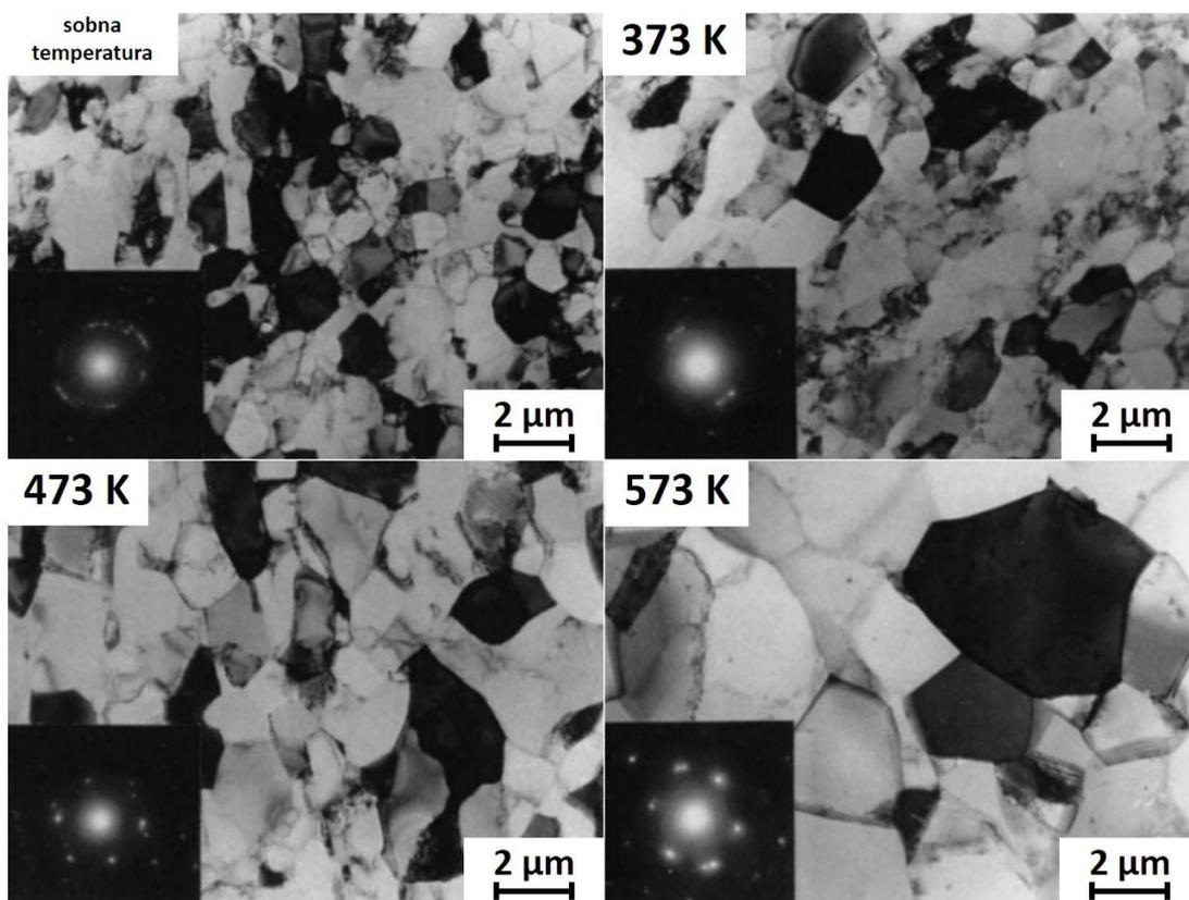
Slika 16 - Snimke mikrostrukture i strukture difrakcije elektrona čistog aluminija nakon ECAP - a sa šest faza i različitim radnim temperaturama [15]
