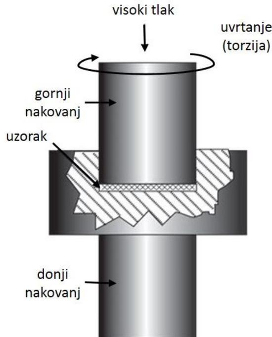
Slika 3- Princip visoko - tlačne torzije [9]
