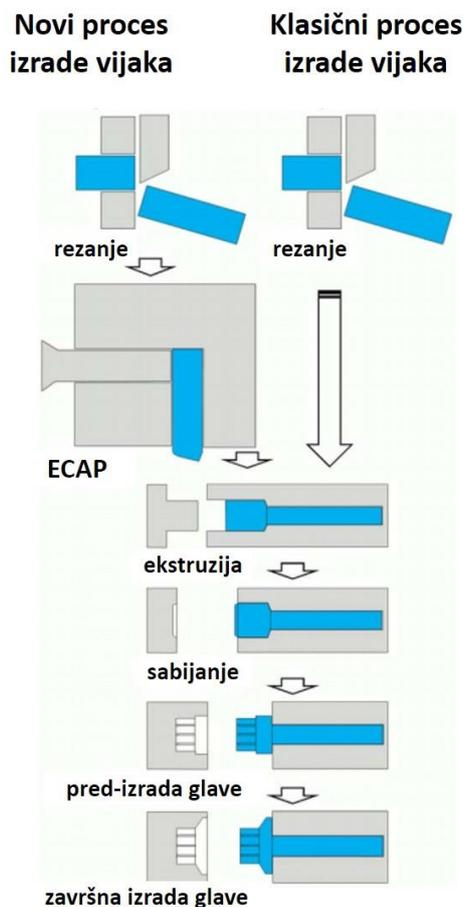
Slika 22 - Usporedni shematski prikaz novog i klasičnog procesa izrade vijaka [23]
