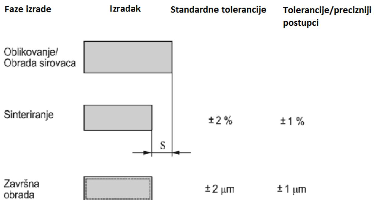
Slika 13. Tolerancije mjera nakon sinteriranja i nakon tvrde obrade[3].
