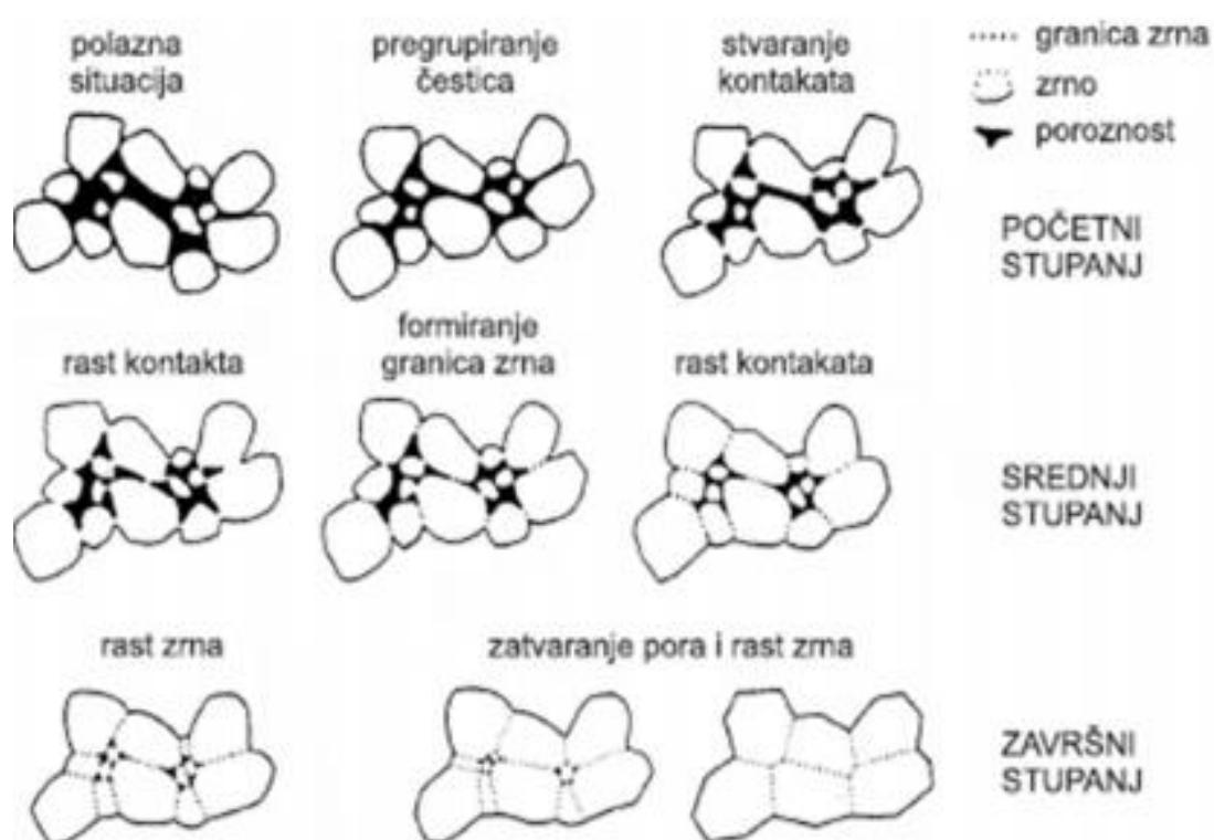
Slika 11. Rast zrna tokom sinteriranja[3]
