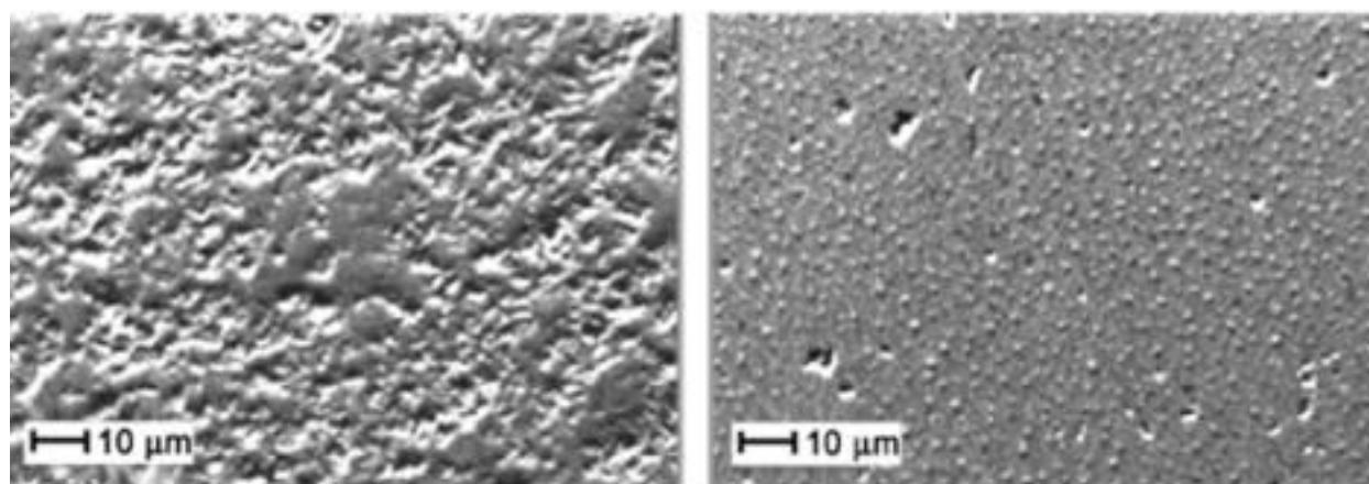
Slika 14. Površina silicijevog karbida polirana 9  $\mu m$  i 25  $\mu m$ [3]
