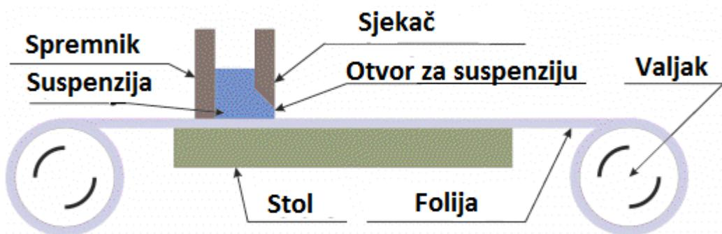
Slika 10. Postupak lijevanja suspenzija na foliju[11]
