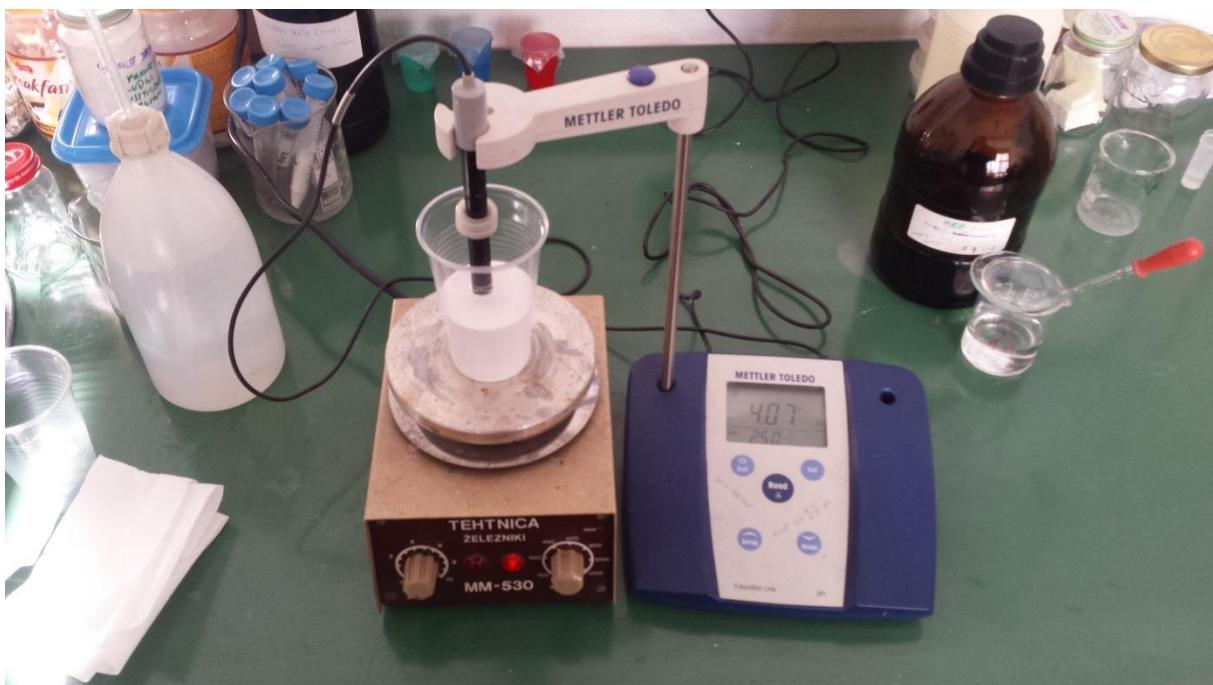
Slika 19. Mjerenje pH-vrijednosti suspenzije
