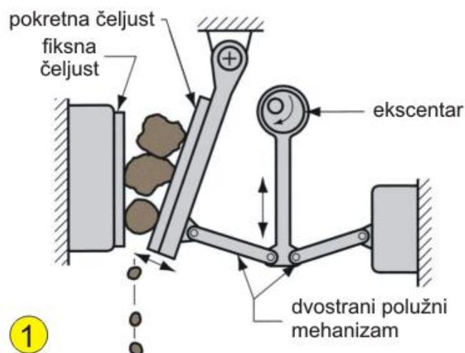
Slika 5. Drobilica za usitnjavanje sirovine za pripravu praha[8]
