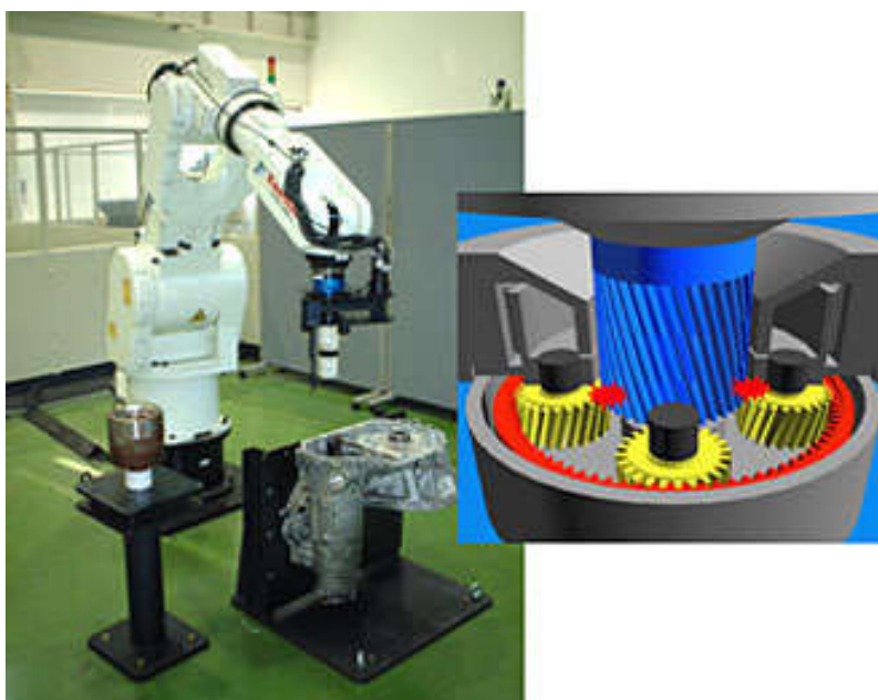
Slika 7. Sklapanje mjenjača motornog vozila
