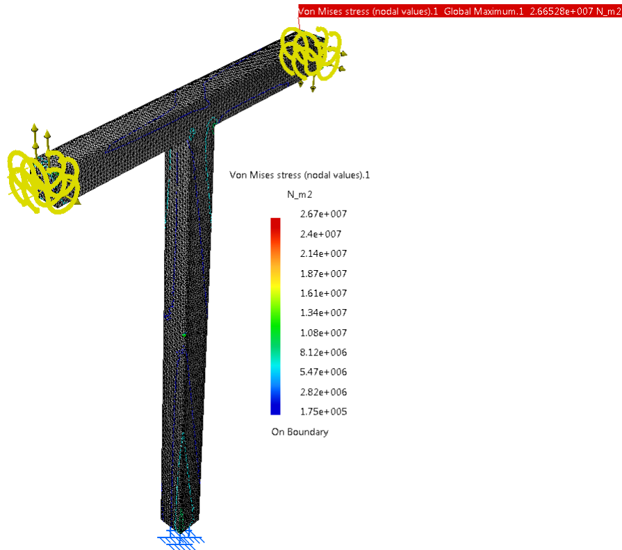
Slika 10: Puni profil - raspodjela naprezanja kod djelovanja dva robota sa suprotno usmjerenim vertikalnim silama
