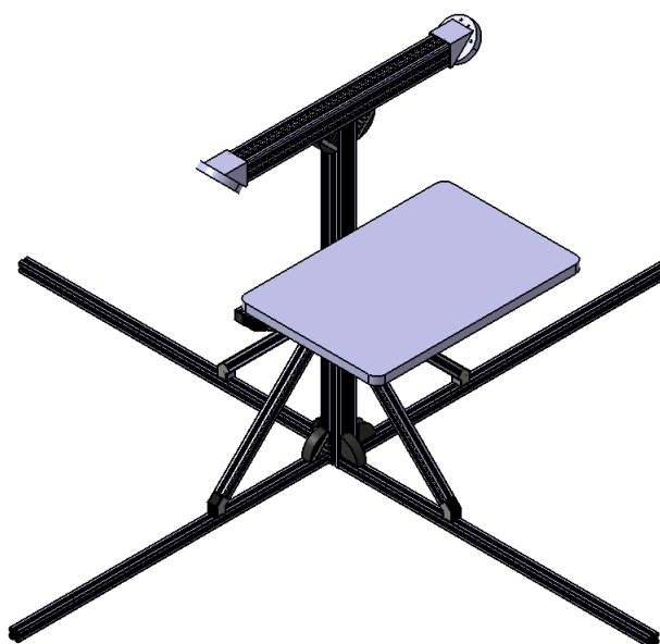
Slika 66: Postolje sa spojnim elementima
