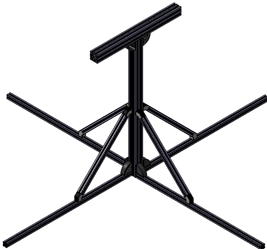
Slika 33: Postolje s dodanom potporom
