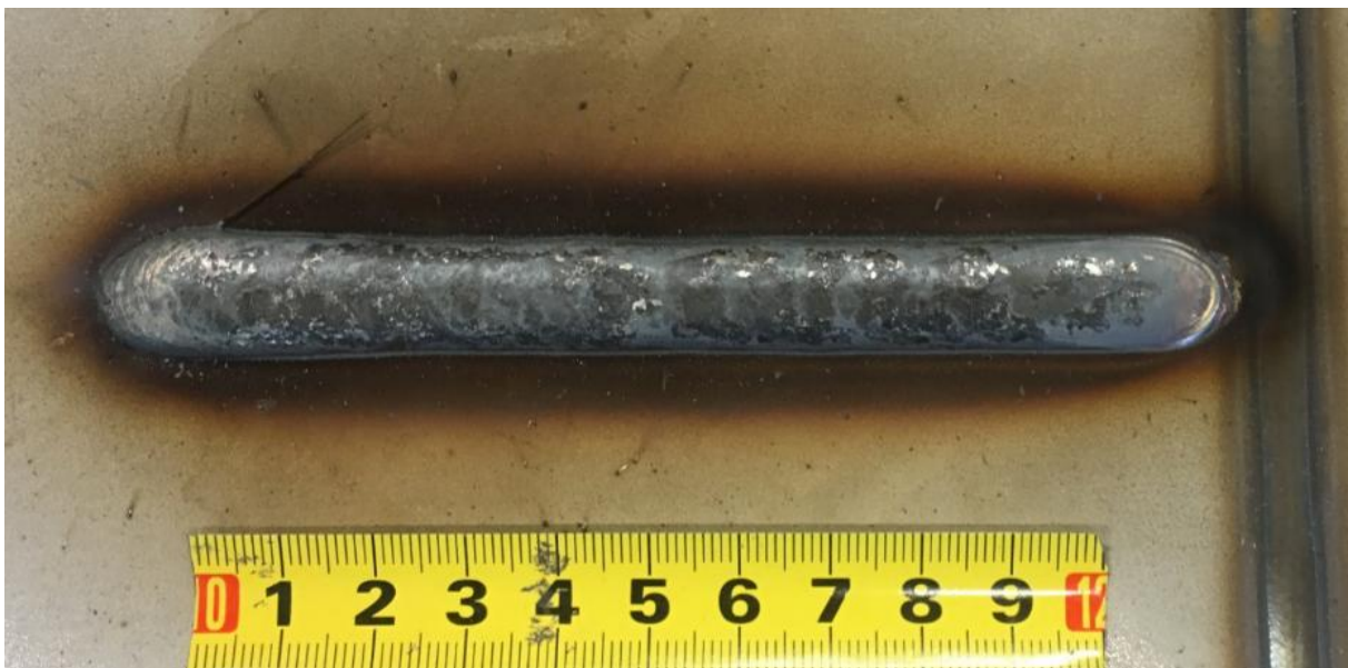
Slika 25 Rezultat navarivanja uzorka 2B
