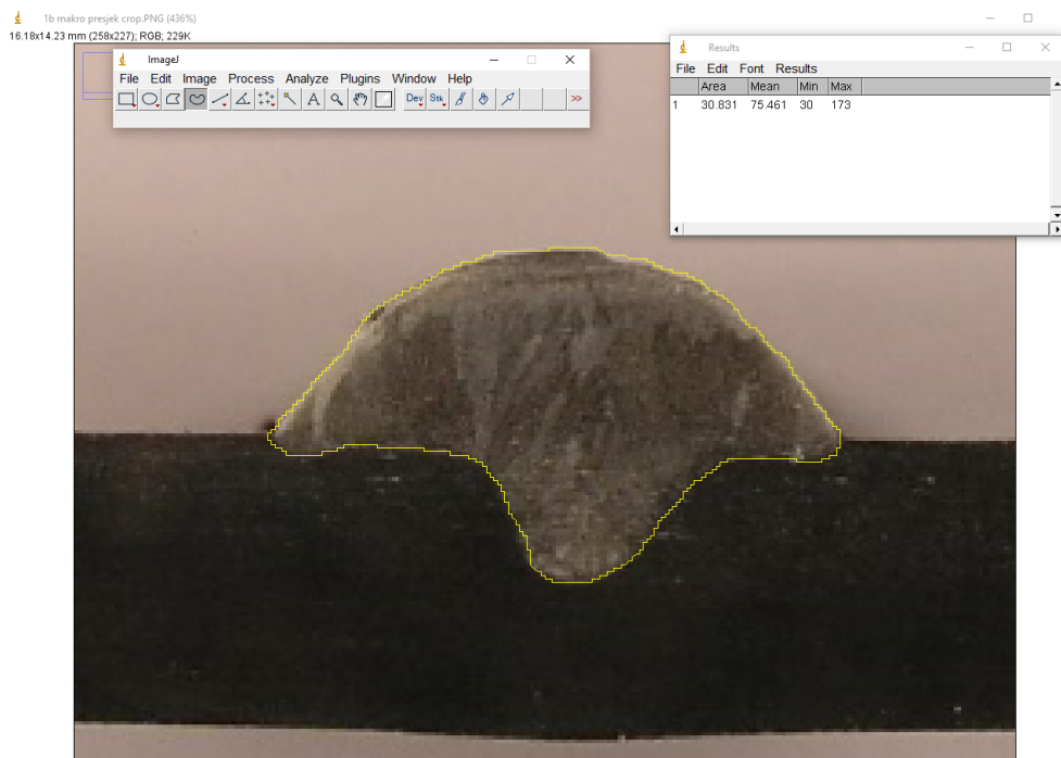
Slika 31 Mjerenje penetracije pomoću programa ImageJ
