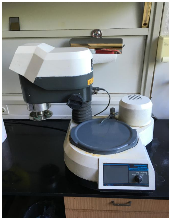
Slika 27 Uređaj za brušenje makro uzoraka Phoenix Alpha Grinder/Polisher
