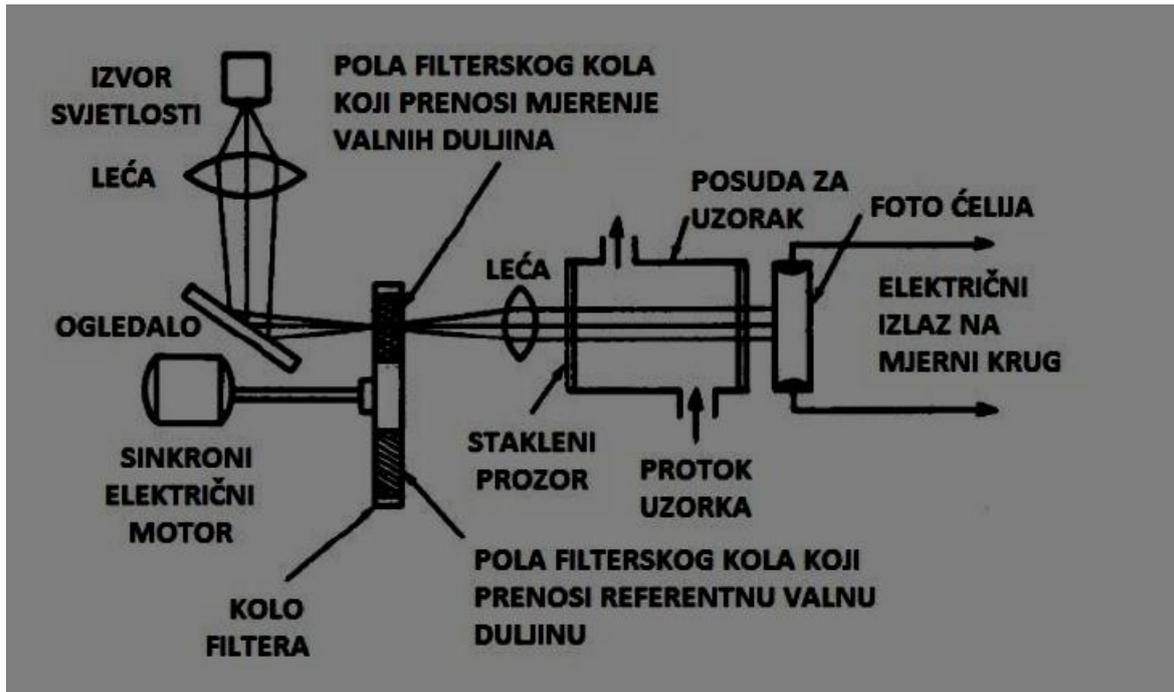
Slika 8. Shema mjerila relativne vlažnosti na principu infracrvenog zračenja
