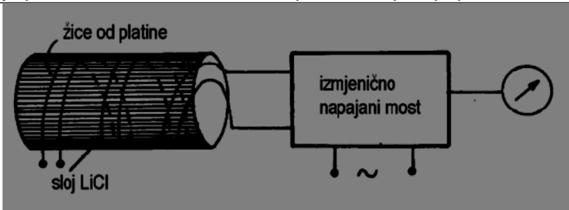
Slika 6. Otpornički pretvornik vlage s valjkastim izolatorom
