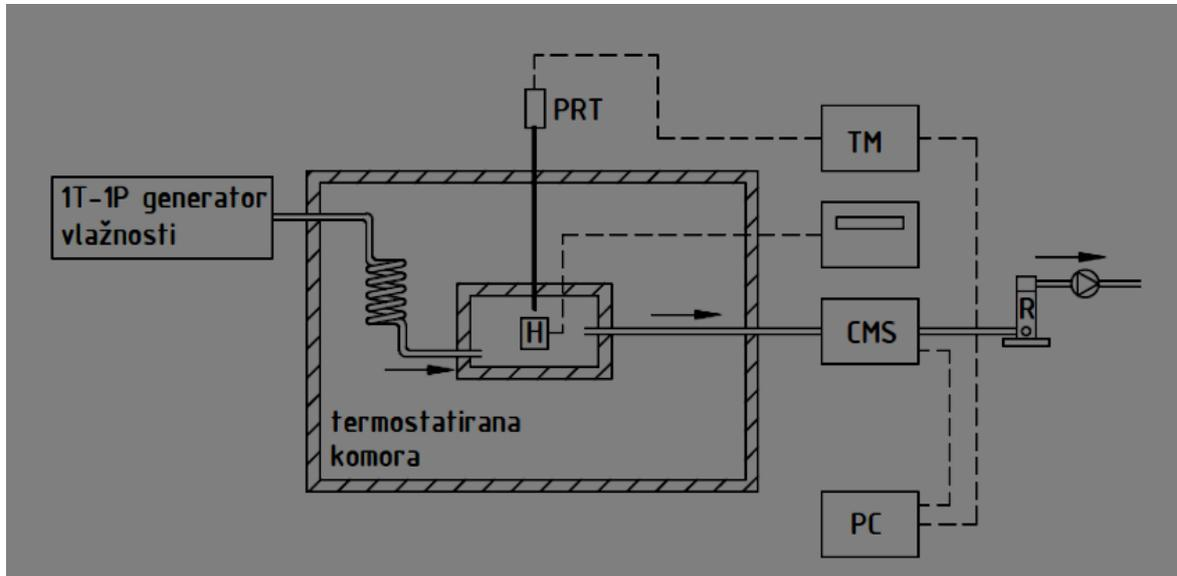
Slika 13. Umjeravanje generiranjem relativne vlažnosti u termostatisanoj komori
