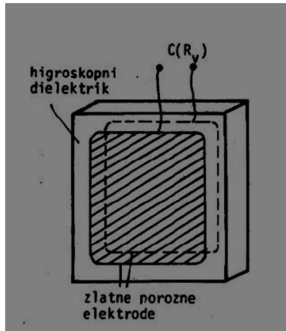
Slika 5. Kapacitativni pretvornik vlage
