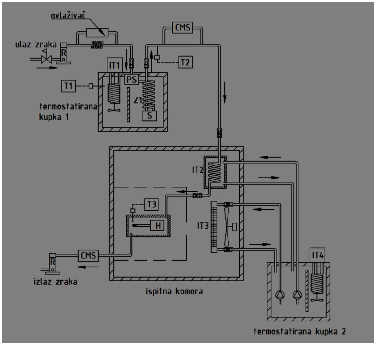
Slika 16. Funkcionalna shema spajanja u sustav umjeravanja
