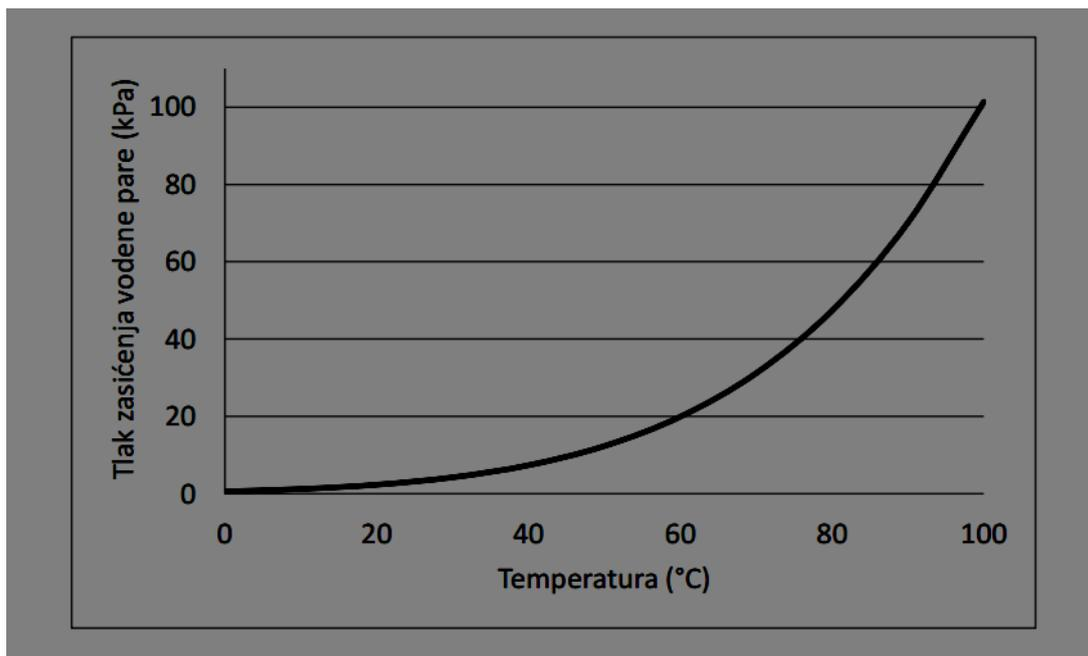
Slika 1. Ovisnost tlaka zasićenja vodene pare o temperaturi
