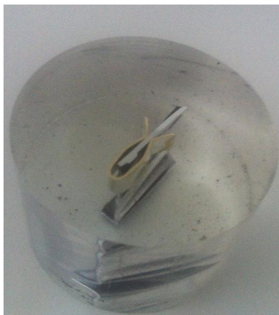
Slika 25. Pripremljeni i uliveni uzorak metalnog kućišta za daljnu analizu
