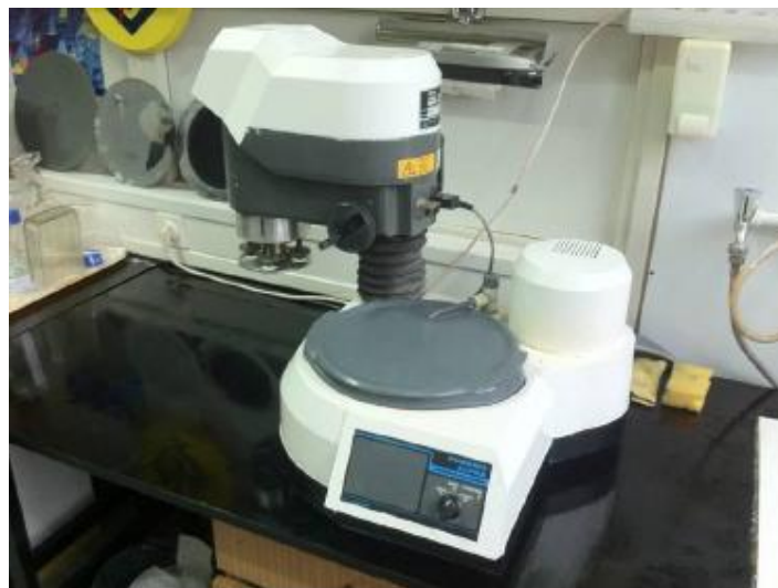
Slika 16. Uređaj za brušenje uzoraka Buehler - Phoenix Alpha
