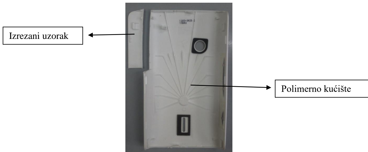
Slika 32. Izrezani uzorak polimernog kućišta
