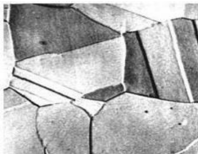
Slika 9 – Austenitna mikrostruktura kod čelika
