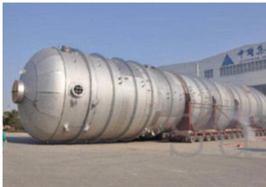
Slika 23 – Tlačni spremnik izrađen od dupleks nehrđajućeg čelika
