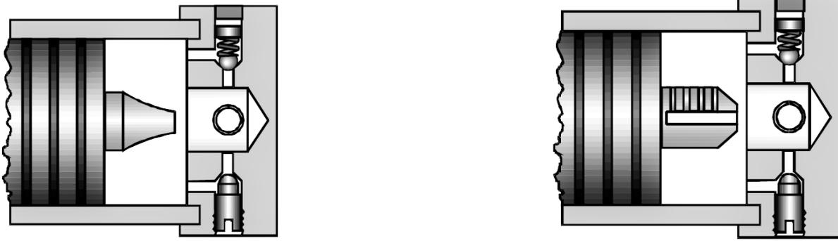
Slika 17. Prigušni klip s dvostrukom parabolom i kratki prigušni klip
