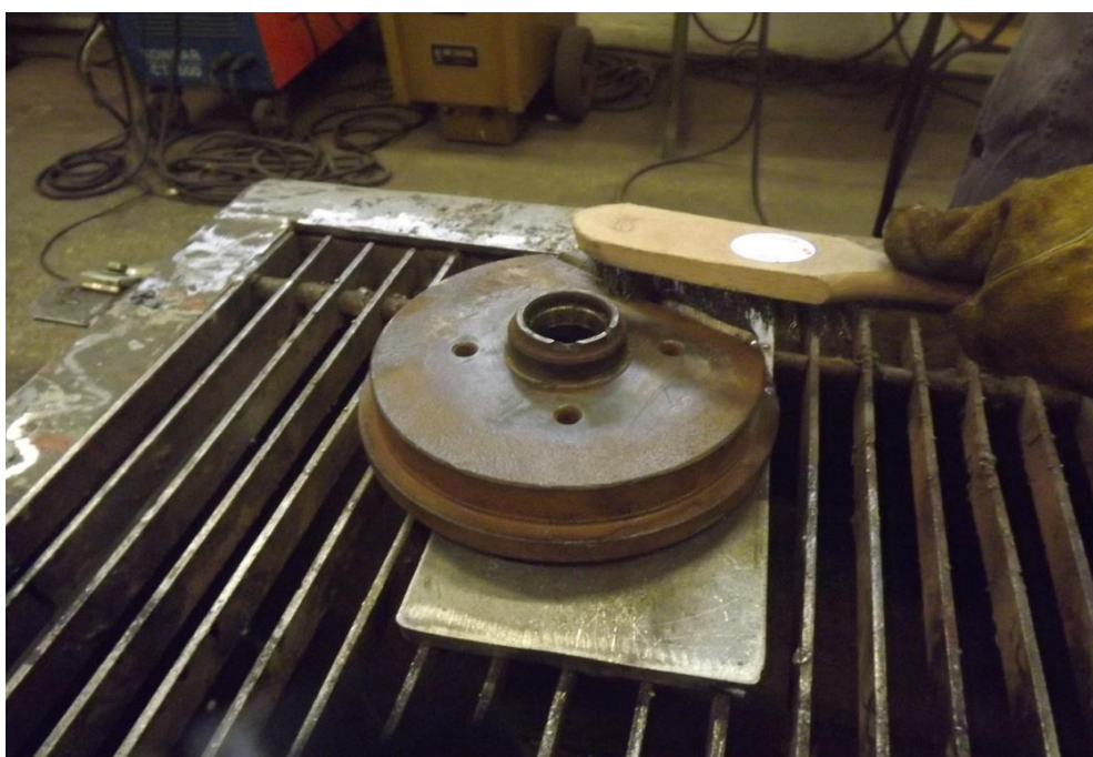
Slika 40. Čišćenje zavara čeličnom četkom
