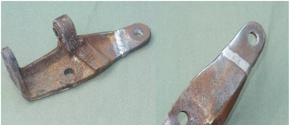
Slika 17. Držač zavaren na hladno [16]
