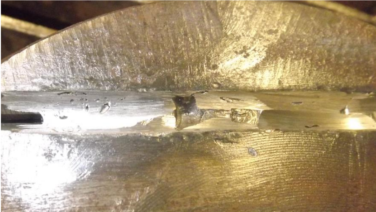
Slika 42. Pore u zavaru
