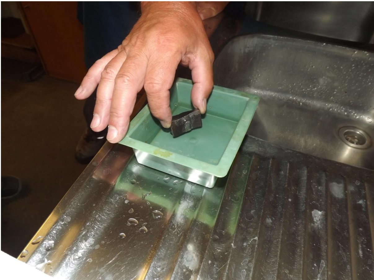
Slika 50. Uranjane makroizbruska u otopinu nital
