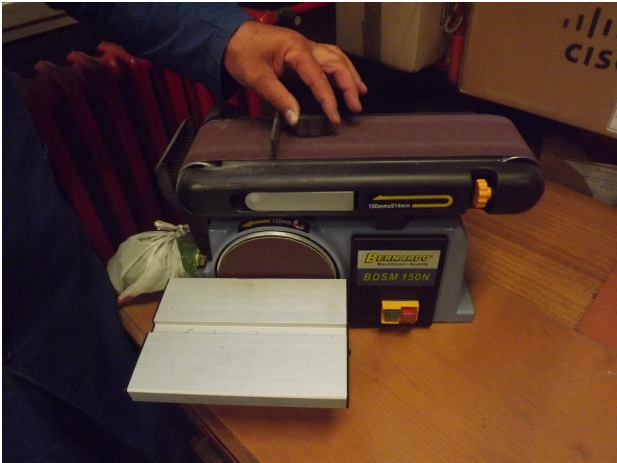
Slika 49. Brušenje makroizbruska na traci
