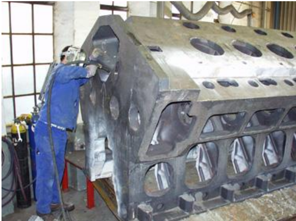
Slika 19. Blok motora zavaren na hladno [16]
