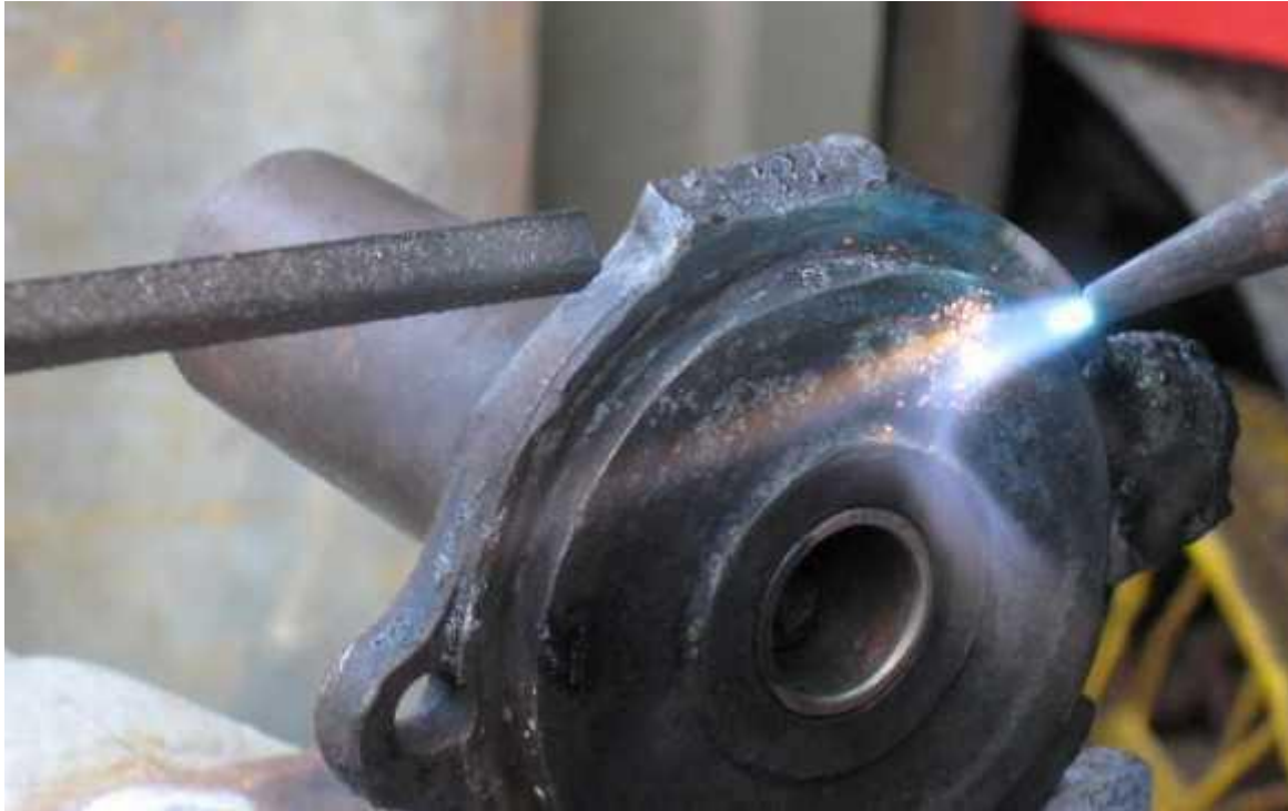
Slika 14. Zavarivanje plinskim plamenom tuljka hidranta [15]
