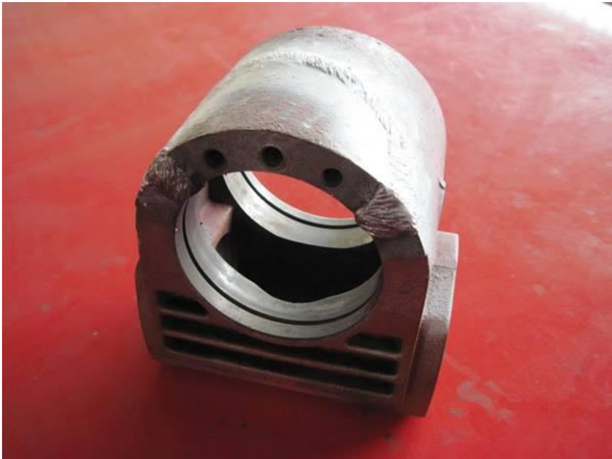
Slika 16. Kućište cilindra preše zavarena na hladno [10]
