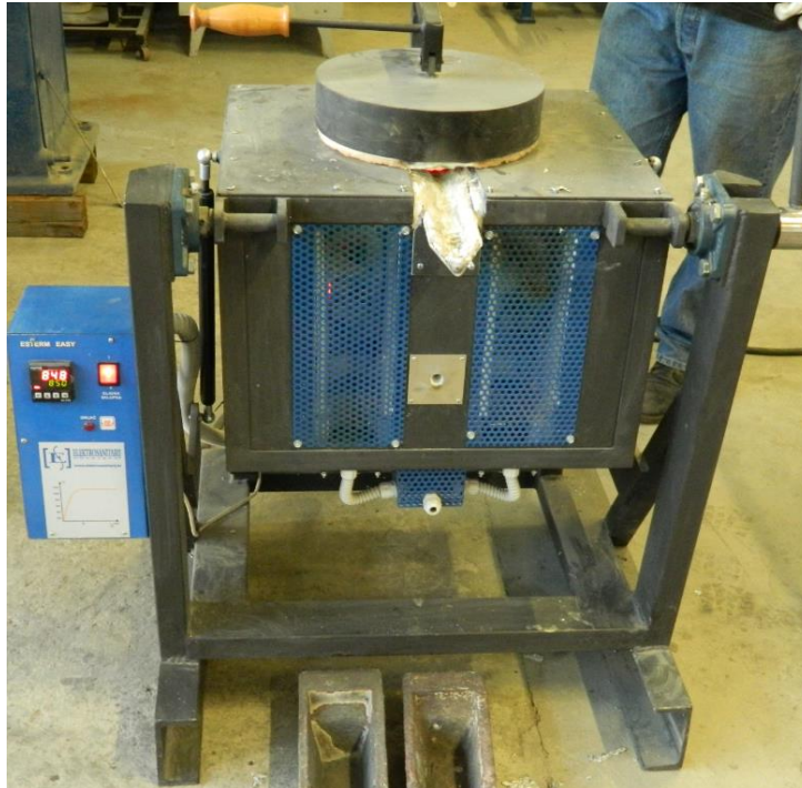
Slika 44. Elektrootporna peč za taljenje
