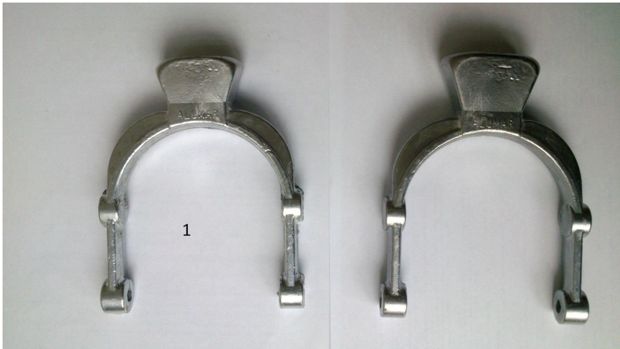
Slika 59. Prvi odljevak- hladniji kalup (lijevo) i topliji kalup (desno)
