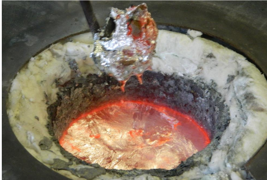
Slika 46. Skidanje troske s površine taljvine
