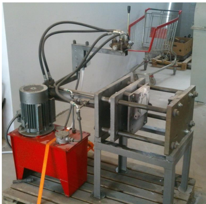
Slika 48. Kokilni stroj za lijevanje, otvoren kalup
