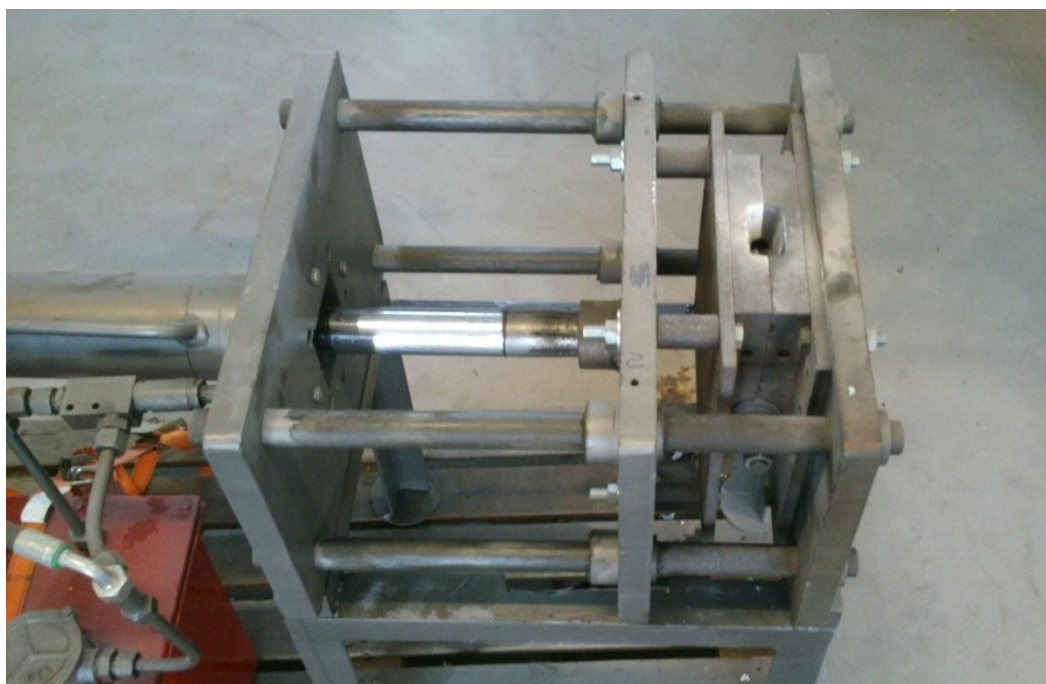
Slika 49. Mehanizam za otvaranje i zatvaranje kokile, zatvoren kalup
