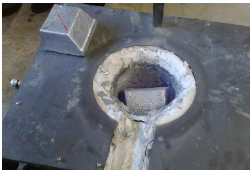
Slika 45. Taljenje aluminijskih ingota
