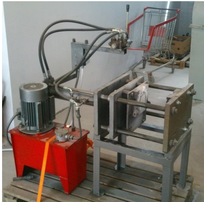
Slika 48. Kokilni stroj za lijevanje, otvoren kalup
