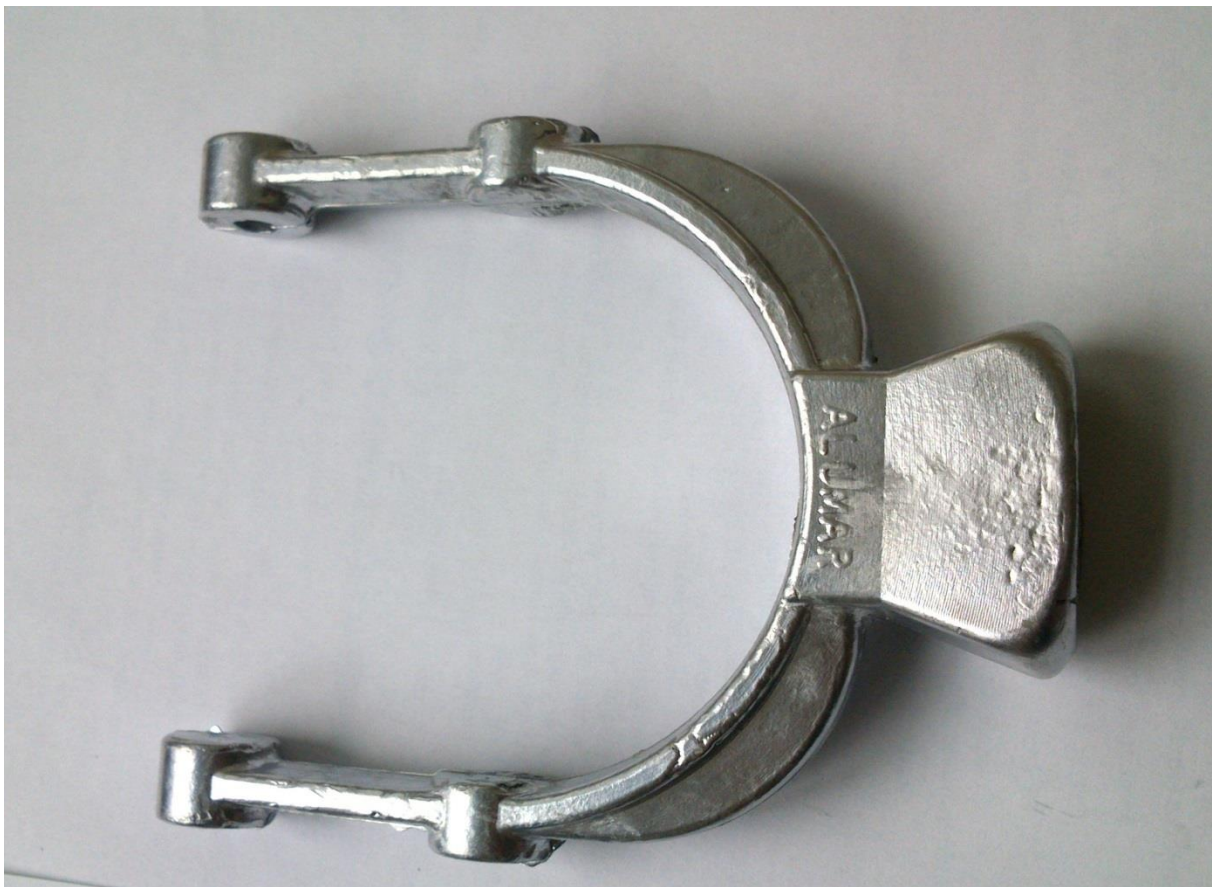
Slika 56. Prvi odljevak, lijevanje u kokilu predgrijanu na 150 °C
