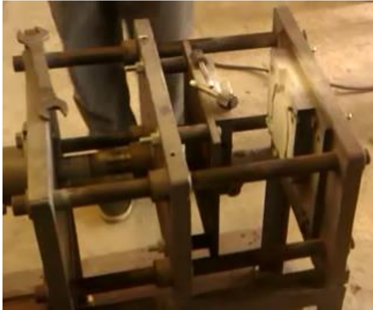
Slika 54. Otvaranje kokile nakon lijevanja
