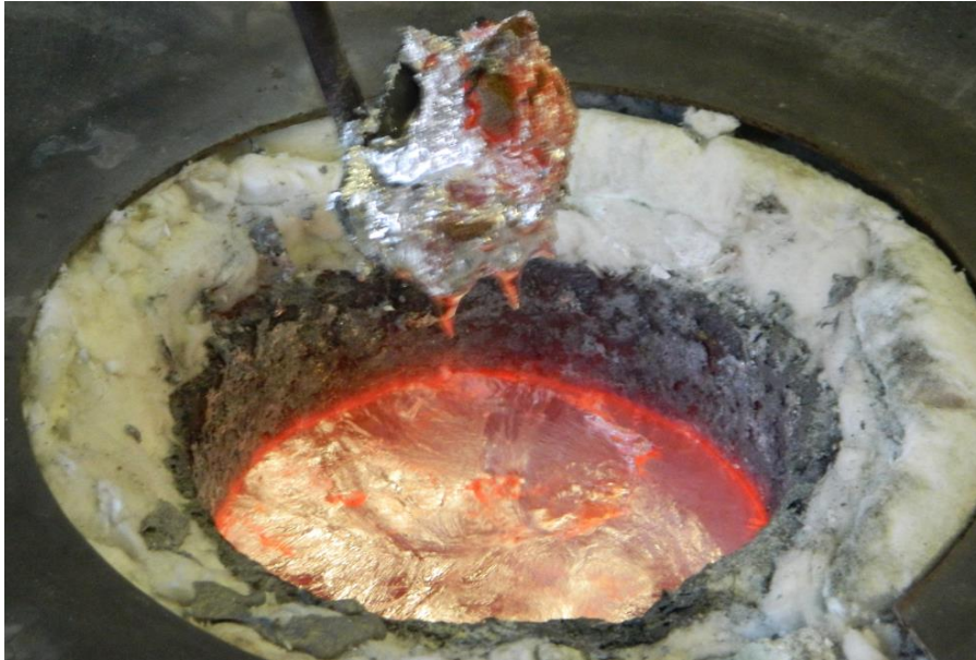
Slika 46. Skidanje troske s površine taljvine
