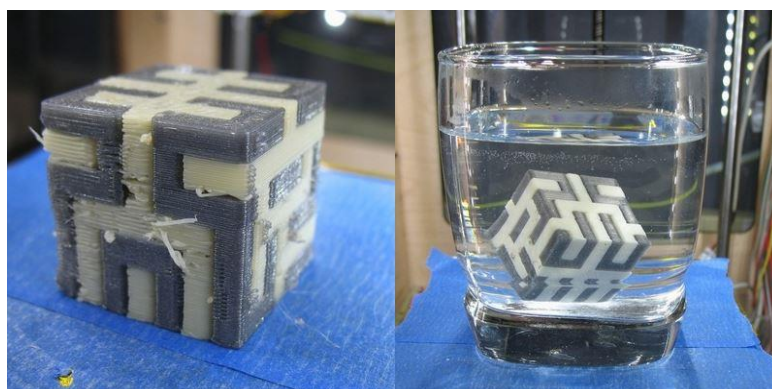
Slika 2.10. Tvorevina s potpornom strukturom od poli(vinil-alkohola) – PVAL [14]
