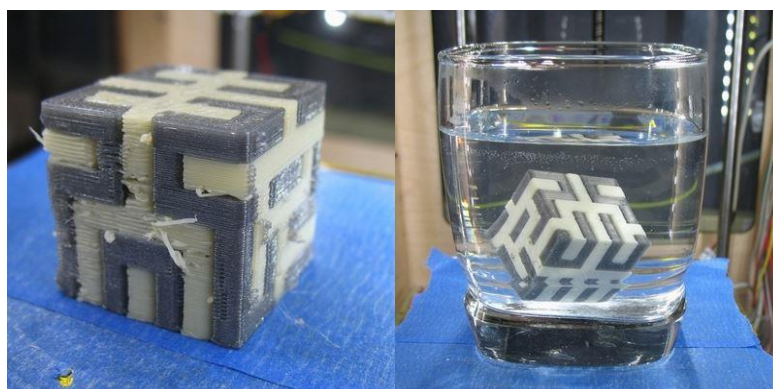
Slika 2.10. Tvorevina s potpornom strukturom od poli(vinil-alkohola) – PVAL [14]
