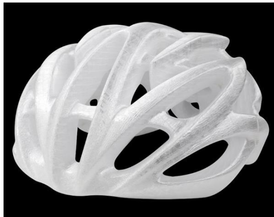
Slika 2.9. Tvorevina izrađena od polikarbonata – PC [14]
