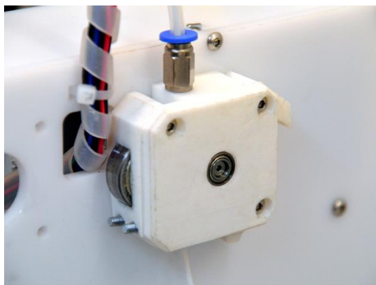
Slika 3.12. Bowden izvedba ekstrudera - mehanički sustav provlačenja žice [33]
