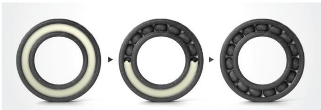
Slika 2.11. Tvorevina s potpornom strukturom od polistirena visoke žilavosti – PS-HI [14]
