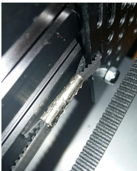
Slika 3.5. Prikaz remenskog zatvarača
