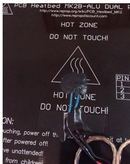
Slika 3.21. Montaža termistora na grijanoj radnoj podlozi
