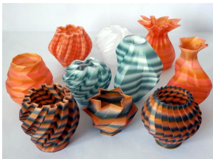
Slika 2.8. Tvorevine izrađene od poliamida – PA [14]
