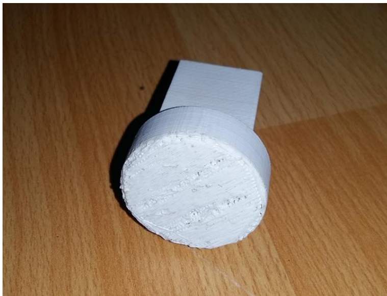
Slika 6.2. Prvi sloj izrađene tvorevine
