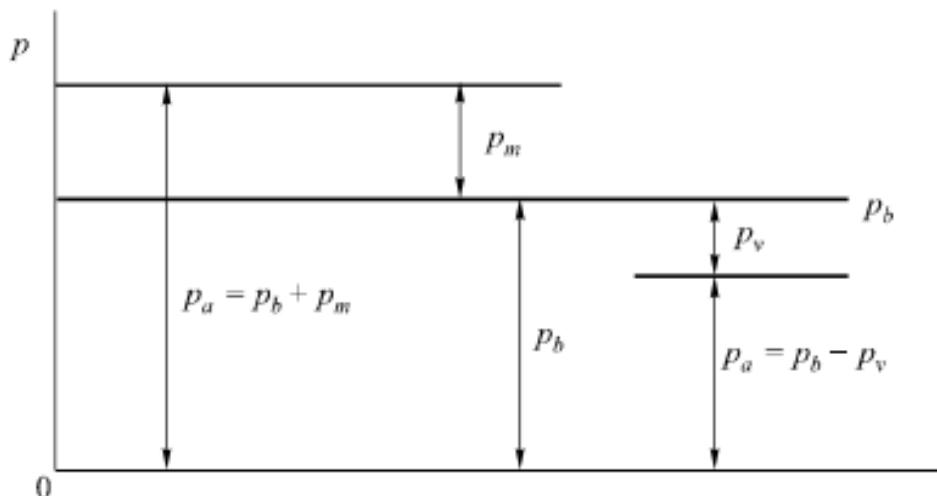
Slika 1-1. Prikaz mjerjenja absolutnog i relativnih tlakova
