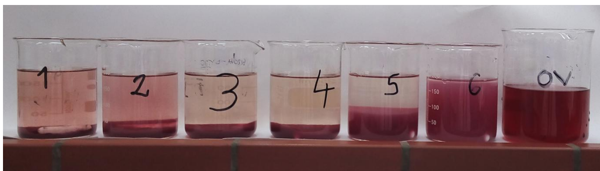
Slika 24. Rezultati jar testa za uzorak otpadne vode A
