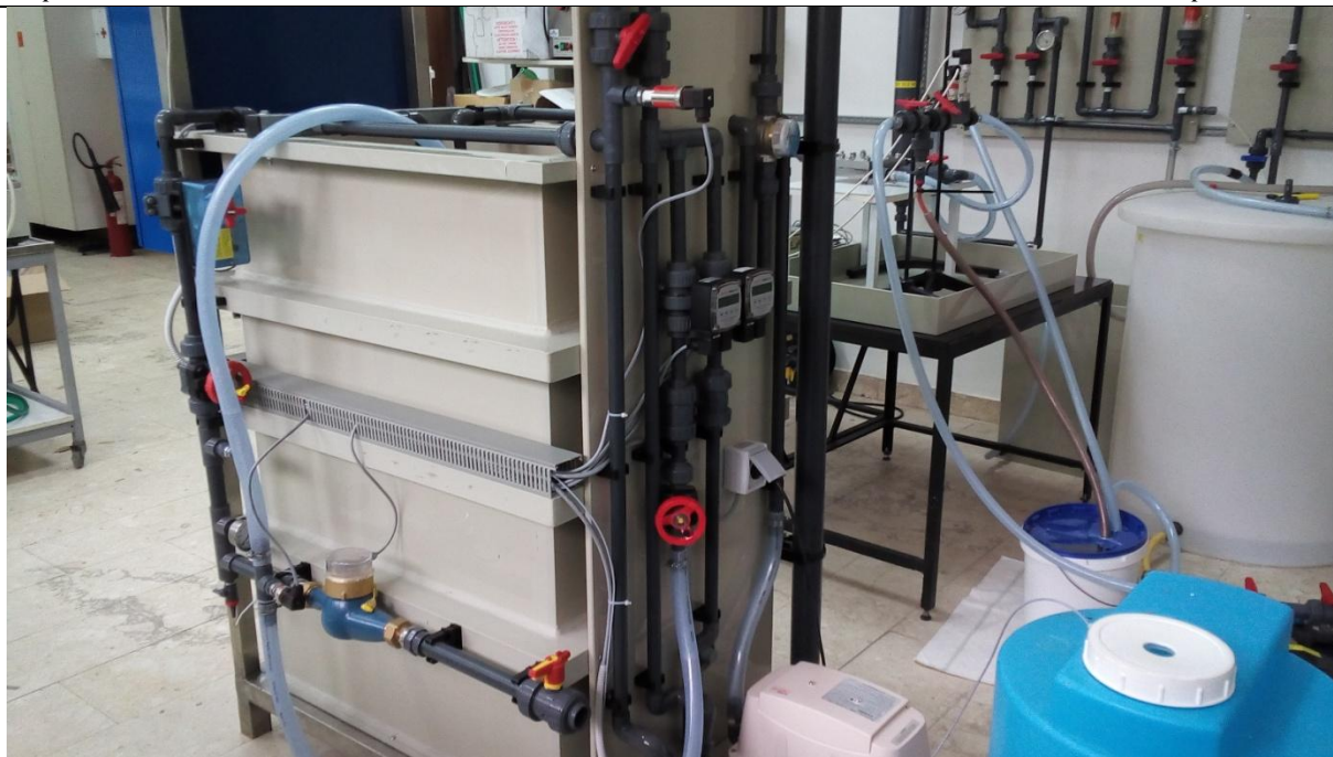
Slika 11. Laboratorijski uređaj sa UF/MF vakuumskom membranom
