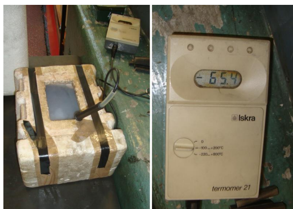
Slika 49. Termostabilna kupka etilnog alkohola i suhog leda
