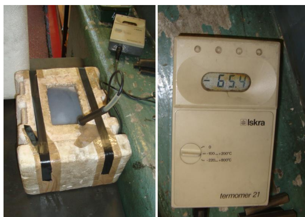
Slika 49. Termostabilna kupka etilnog alkohola i suhog leda
