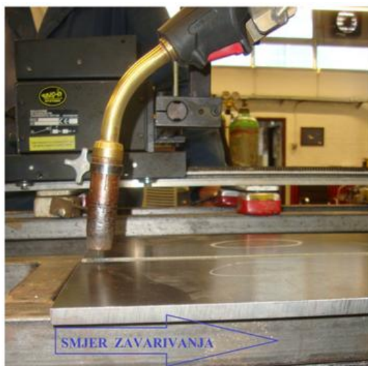
Slika 37. Položaj pištolja, desna tehnika rada
