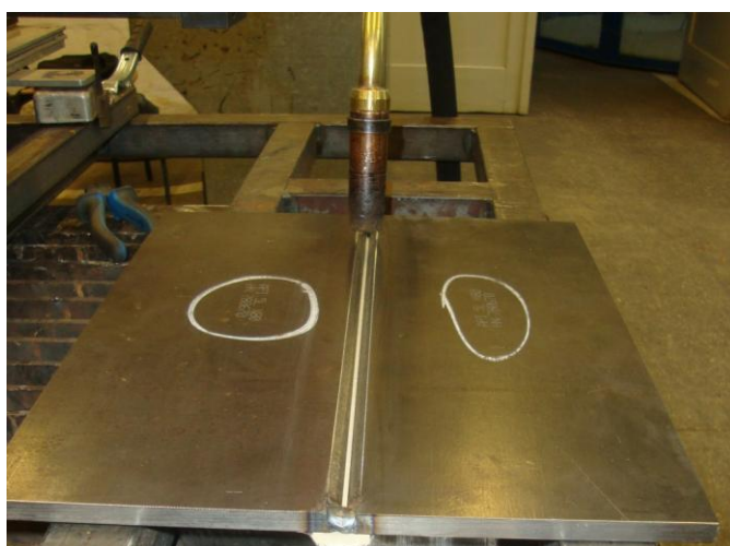
Slika 41. Ploča spremna za zavarivanje
