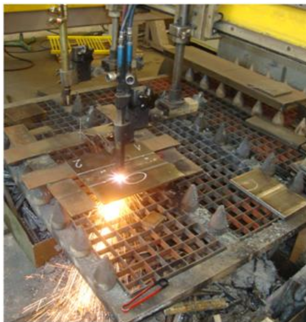
Slika 44. Izrezivanje ploča plinskim postupkom
