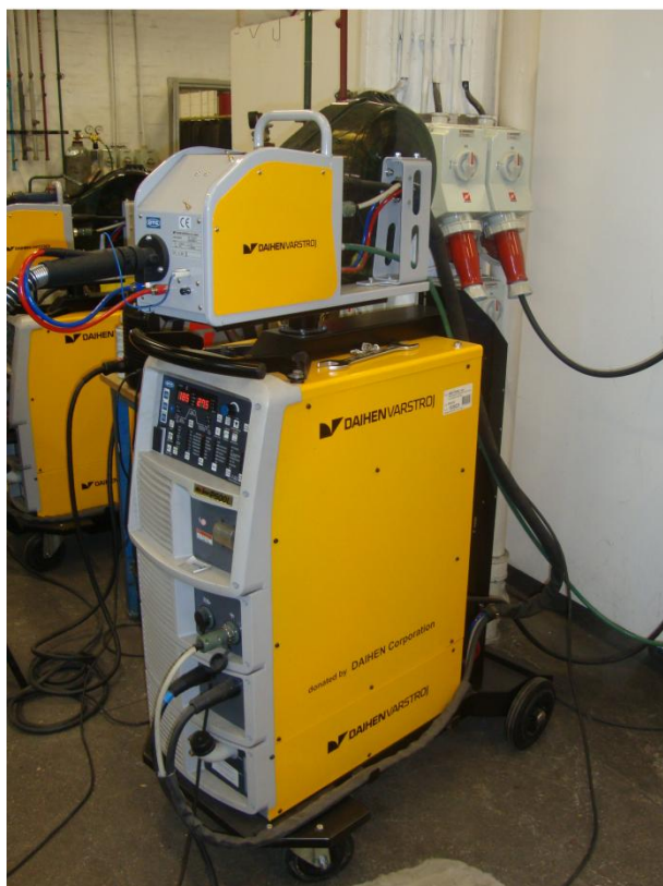
Slika 34. Izvor struje za zavarivanje WB – P500L
