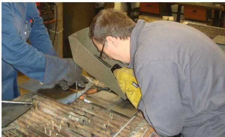
Slika 39. Pozicioniranje ploča i zavarivanje pripoja
