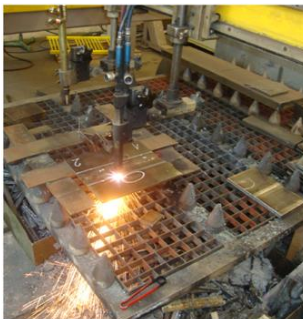
Slika 44. Izrezivanje ploča plinskim postupkom
