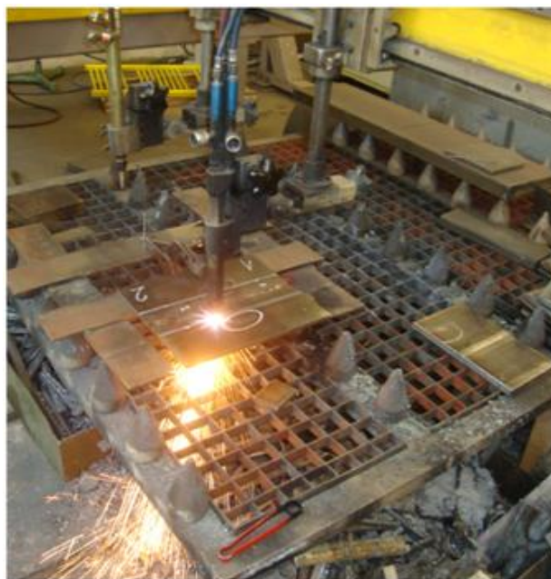
Slika 44. Izrezivanje ploča plinskim postupkom
