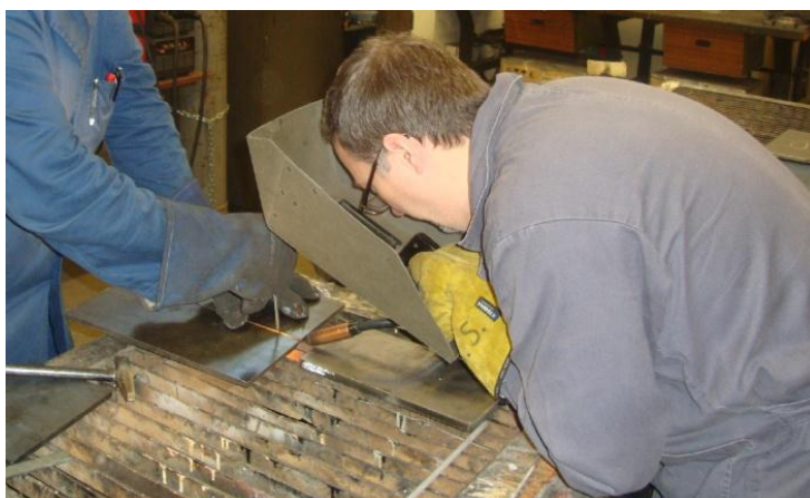
Slika 39. Pozicioniranje ploča i zavarivanje pripoja
