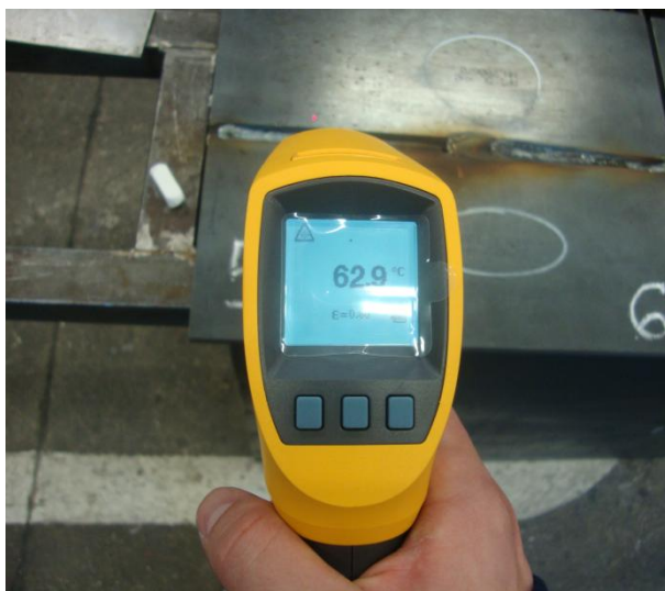
Slika 42. Mjerenje međuprolazne temperature
