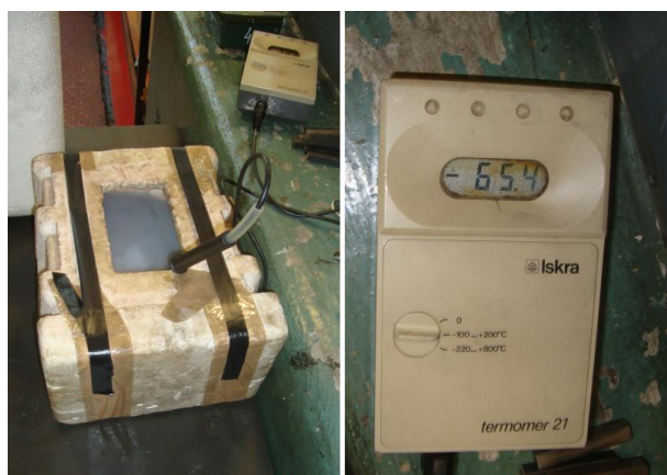
Slika 49. Termostabilna kupka etilnog alkohola i suhog leda
