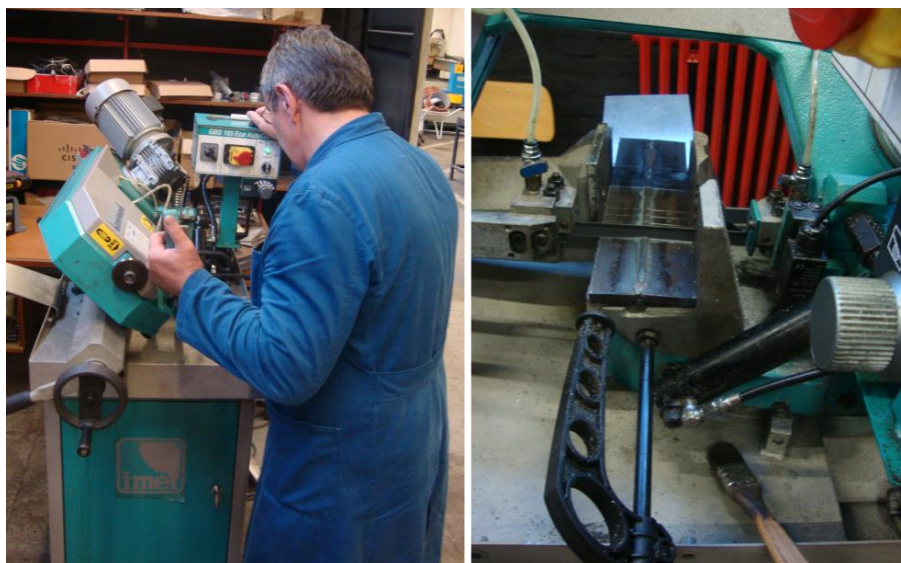
Slika 45. Postupak rezanja na tračnoj pili
