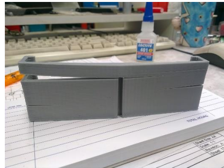
Slika 3.5. Premalo kvašenje između slojeva [13]
