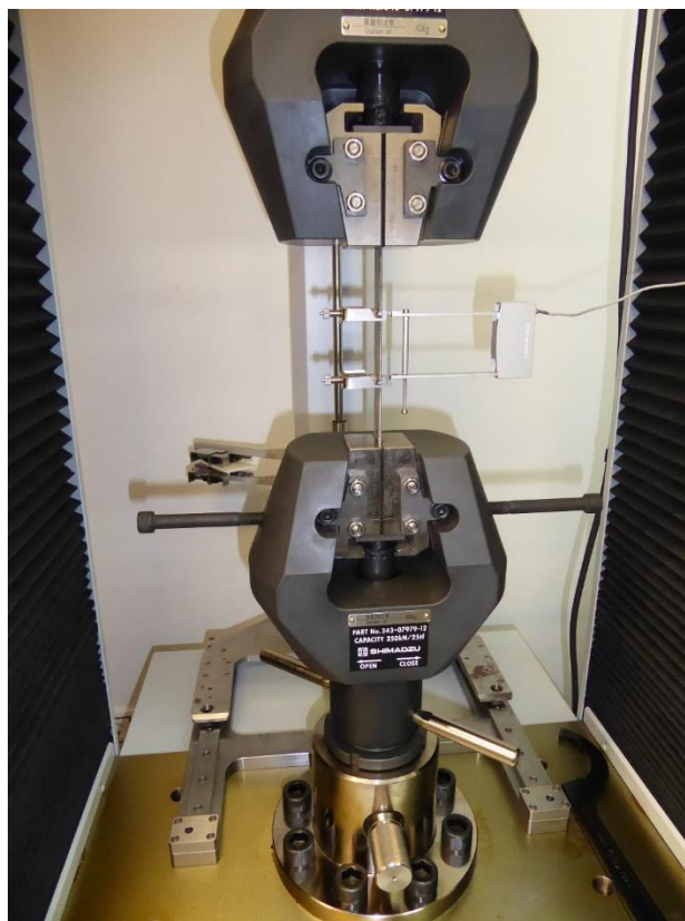
Slika 6.9. Prikaz ispitnog tijela s ekstenziometrom u steznoj čeljusti
