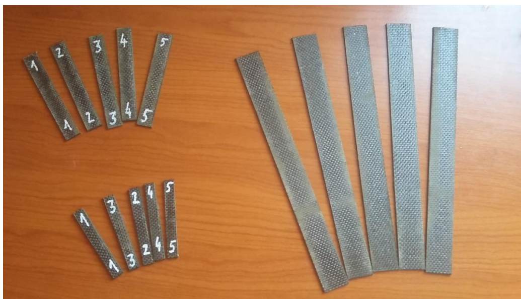
Slika 7.13. Izrezana ispitna tijela za određivanje mehaničkih svojstava
