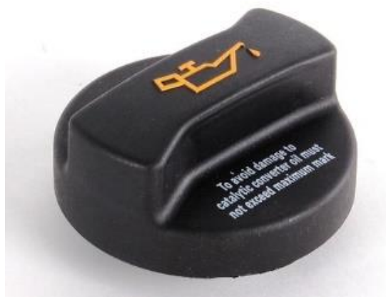
Slika 4.13. Čep od polipropilena ojačanog konoljinim vlaknima [90]
