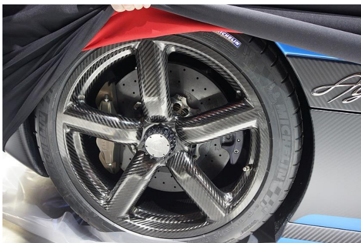
Slika 4.11. Naplatak od epoksidne smole ojačane ugljikovim vlaknima [88]
