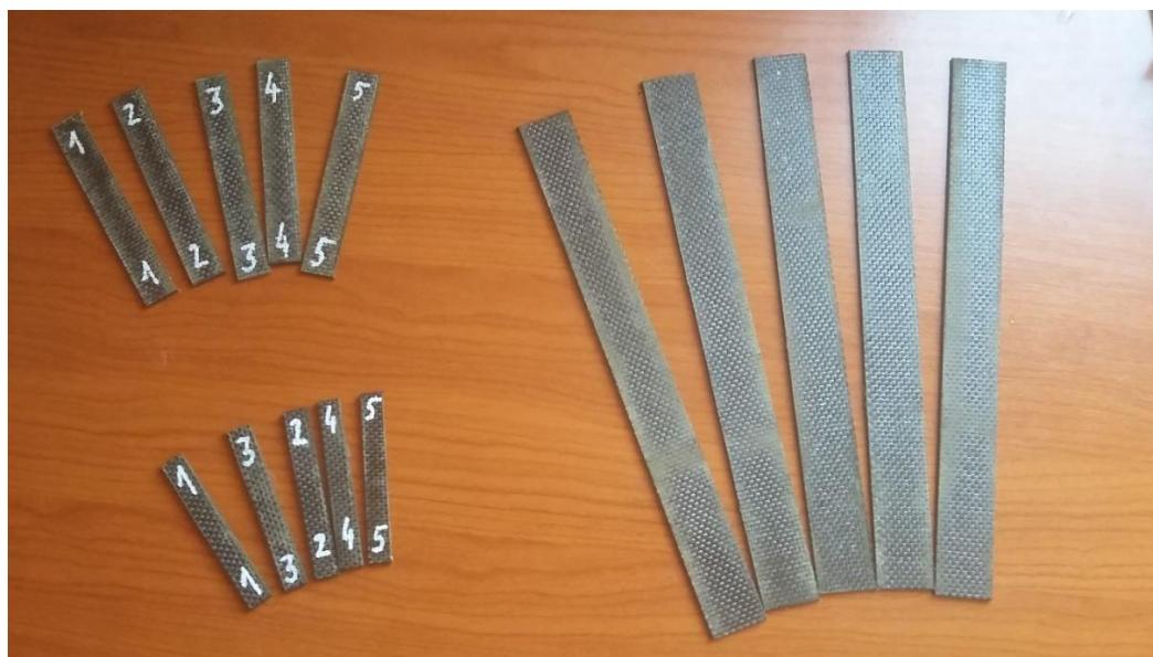
**Slika 7.13. Izrezana ispitna tijela za određivanje mehaničkih svojstava**
