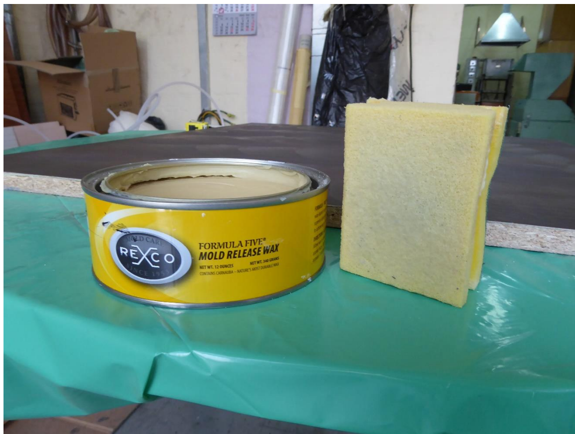
Slika 7.3. Vosak tvrtke Rexco upotrebljavan za pripremu površine kalupa
