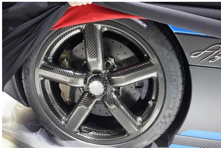
Slika 4.11. Naplatak od epoksidne smole ojačane ugljikovim vlaknima [88]
