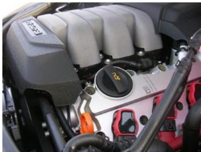
Slika 4.12. Poklopac glave motora kod 3,2 FSI motora [90]
