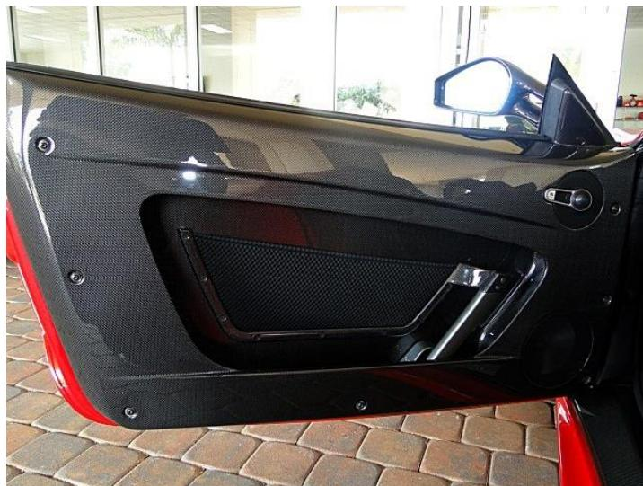
**Slika 4.7. Panel vrata izrađen od matrice ojačane ugljikovim vlaknima [78]**
