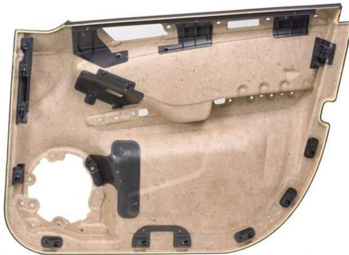
**Slika 2.15. Polipropilen ojačan lanenim vlaknima [48]**
