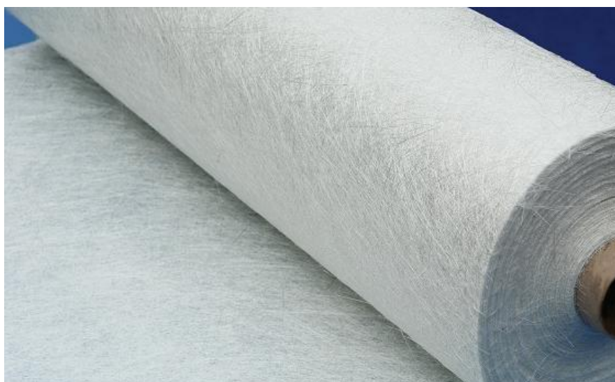
Slika 2.4. Staklena vlakna u obliku mata [10]
