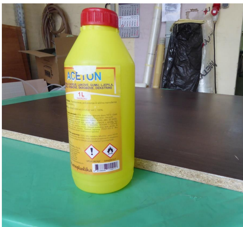
Slika 7.2. Čišćenje površine kalupa acetonom
