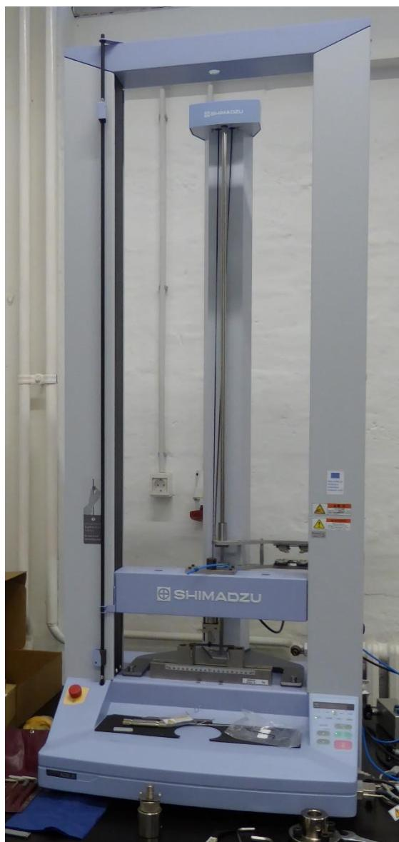
**Slika 6.12. Shimadzu AGS-X za ispitivanje savojnih svojstava**
