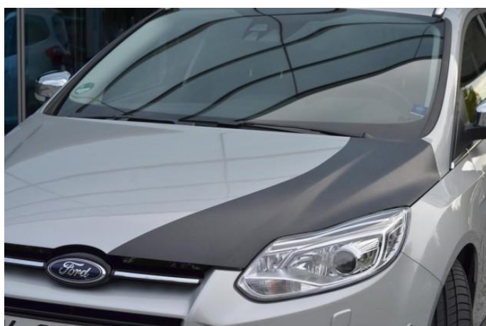
Slika 4.5. Fordov poklopac motora ojačan ugljikovim vlaknima [75]
