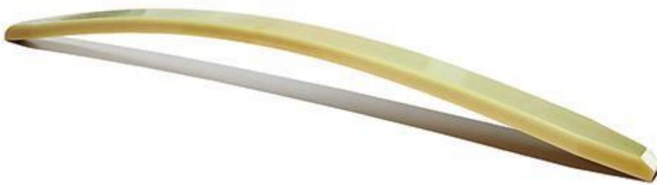
**Slika 4.10. Lisnata Opruga proizvedena RTM postupkom [84]**
