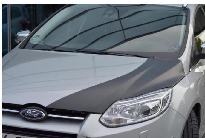
**Slika 4.5. Fordov poklopac motora ojačan ugljikovim vlaknima [75]**
