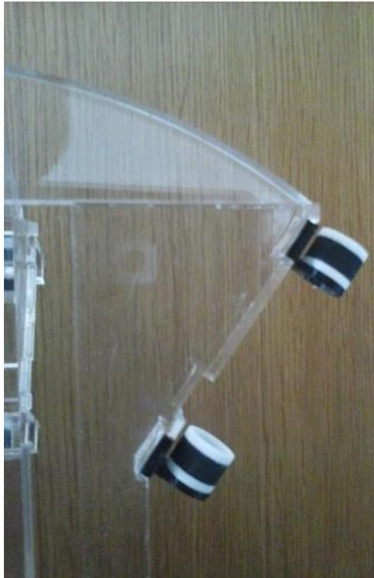
**Slika 40** Postupak sklapanja T-fantoma; SLS čahure na novim nosačima postavljenim u utorima za pločice.
