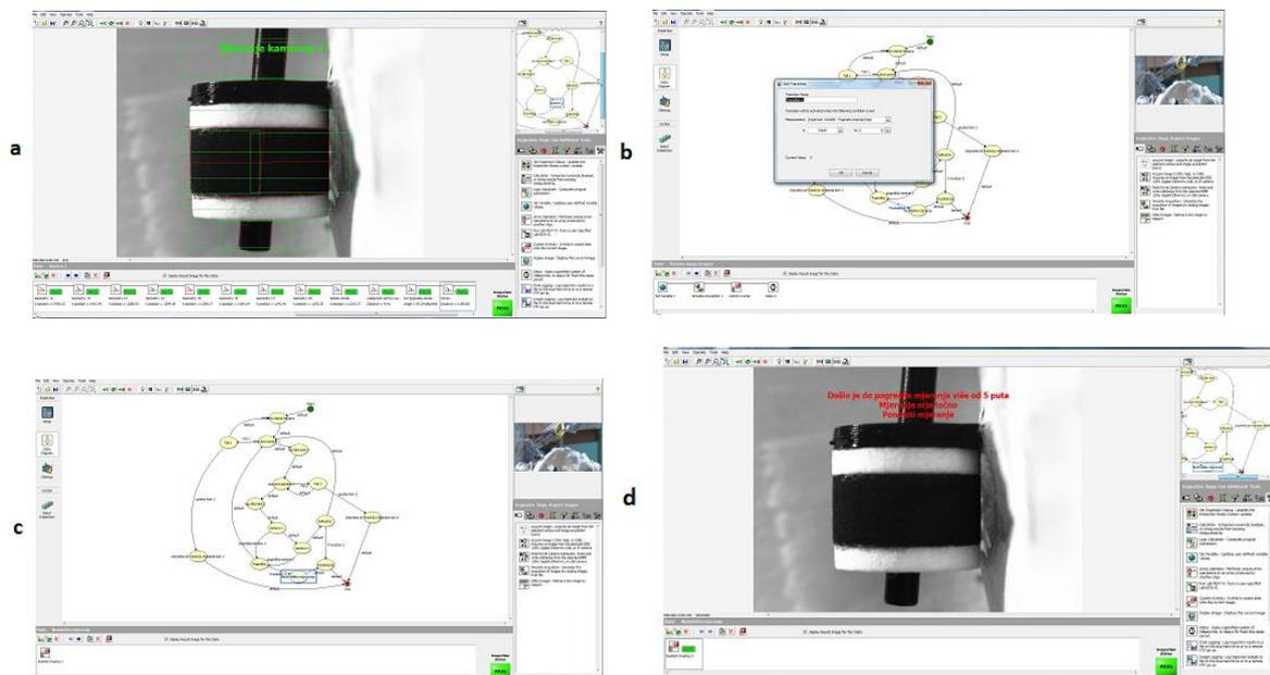
**Slika 64** Koraci „kamera 2“ i „Nestabilno mjerenje“; a) Prikaz mjerenja u koraku „kamera 2“; b) Uvjet za prelazak na korak „Nestabilno mjerenje“; c) Prikaz koraka „Nestabilno mjerenje“ sa svim korištenim naredbama s uvećanim tijekom rada; d) Prikaz korisniku da je došlo do pogreške u koraku „Nestabilno mjerenje“.
