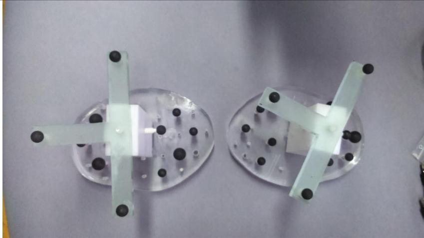
**Slika 26** Fantom za mjerenje točnosti sustava RONNA s plastičnim kuglicama kao ciljnim točkama.
