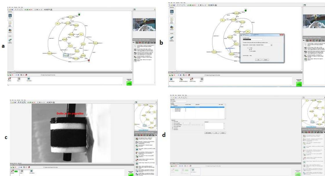
**Slika 63** Korak „Pogreška“; a) Prikaz koraka „Pogreška“ sa svim korištenim naredbama s uvećanim tijekom rada; b) Prikaz uvjeta za prelazak u korak „Pogreška“; Prikaz korisniku da je došlo do pogreške; d) Prikaz povećanja brojila za varijablu „pogreška traženja linija“.
