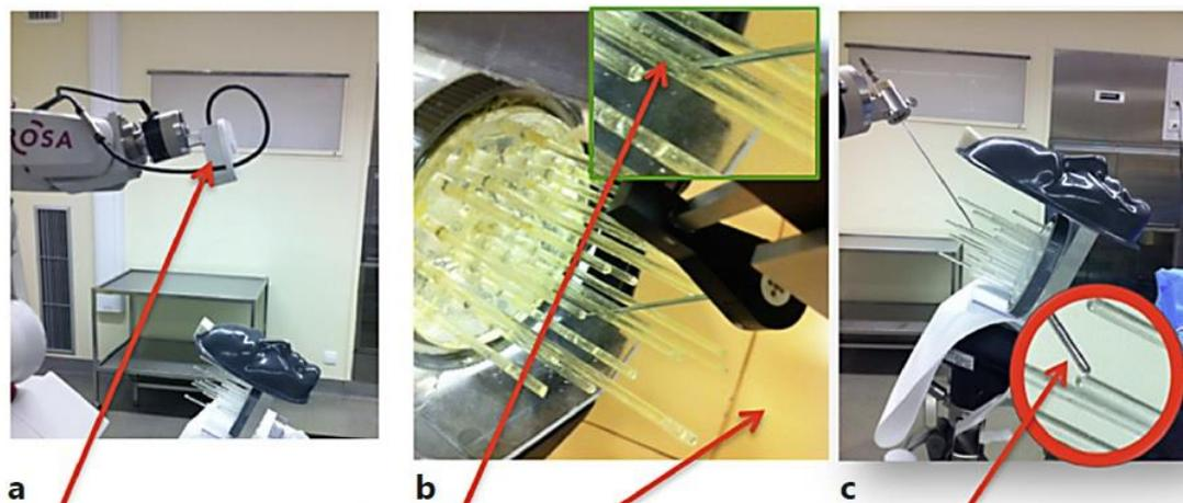
**Slika 22** Postupak FL robotizirane registracije; a) prikaz sustava sa CTom na izvršnom kraju robota koji služi za FL registraciju; b) uvećani prikaz sonde prilikom dolaska do cilja kada je sustav navođen FL registracijom na temelju Cta; c) uvećani prikaz sonde prilikom dolaska do cilja kada je sustav navođen FL registracijom na temelju MRIa; [86].
