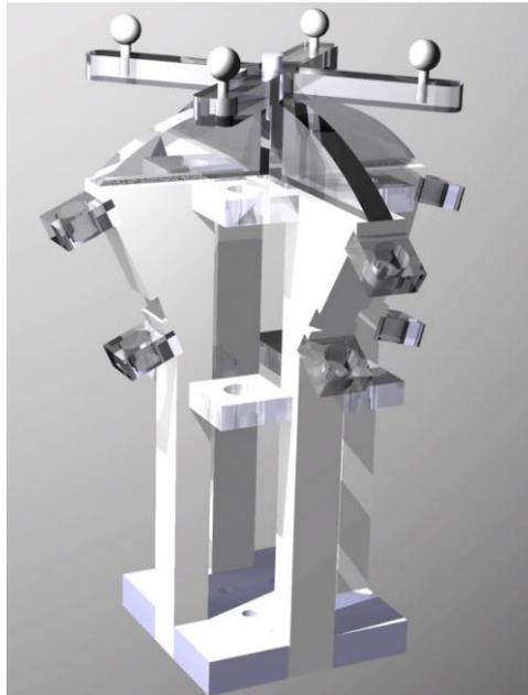
**Slika 31** Četvrti koncept novog fantoma za mjerenje točnosti stereotaktičkih sustava; Napravljena posebna vizualizacija u programu CATIA.
