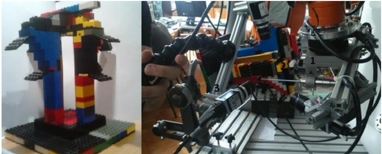
Slika 33 LEGO prototip fantoma; Lijevo: Model T-fantoma od LEGO kocaka; Desno: 1) Vodilica sa sondom, 2) LEGO T-fantom, 3) Stereo-vizijski sustav.
