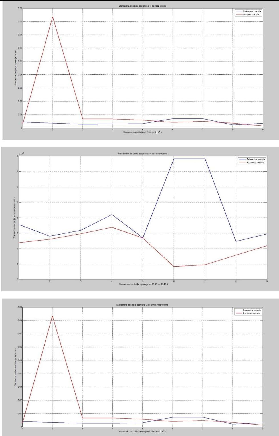
**Slika 80** Usporedni prikaz rezultata standardnih devijacija obje metode kroz vrijeme, gdje su prikazani rezultati za mjerenja pogreške u x osi (gornja slika), y osi (srednja slika) i xy ravnini (donja slika).
