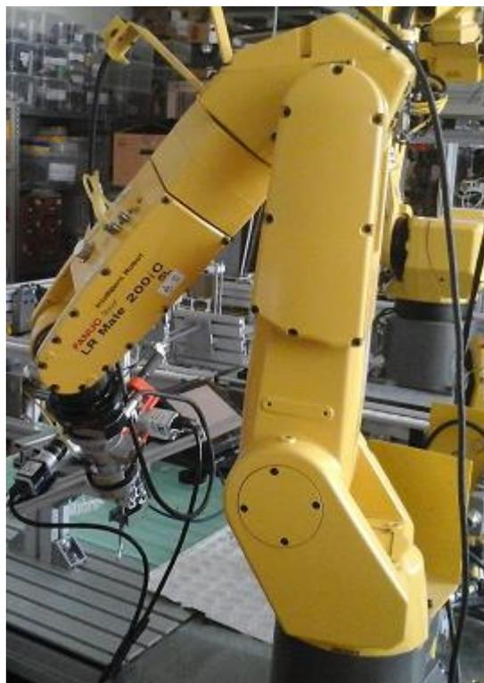
**Slika 50** Fanuc LR Mate 200iC 6DOF robot s postavljenim nosačem s kamerama koje služe kao stereo-vizijski sustav na izvršnom kraju.
