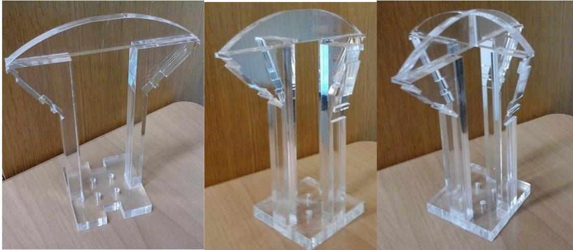
**Slika 35** Postupak sklapanja T-fantoma; Lijevo: lijepljenje prva dva nagiba i glavnog luka; Sredina: Lijepljenje druga dva nagiba na baznu ploču; Desno: lijepljenje druga dva luka i povezivanje s glavnim lukom.
