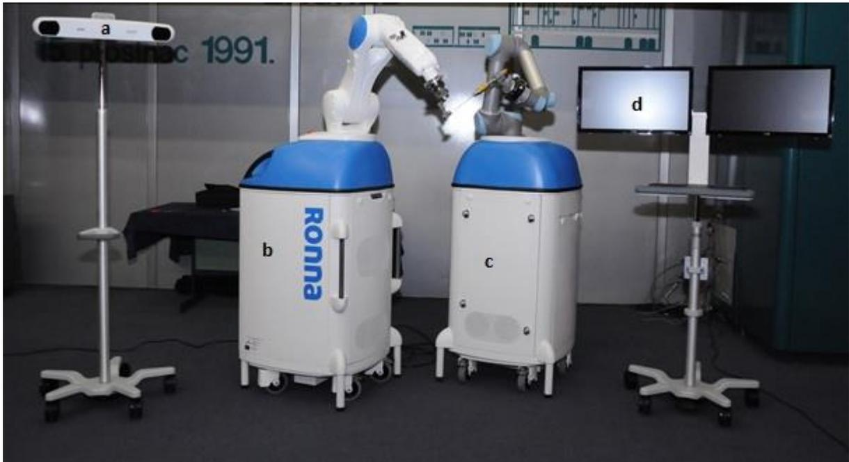
**Slika 9** Sustav za stereotaktičku robotsku neuronavigaciju RONNA; a) RONNAvision modul sa komercijalno dostupnim POLARIS sustavom; b) glavni robot (KUKA KR6) na pomičnom stanku s integriranom upravljačkom jedinicom i napajanjem ; c) pomoćni robot (Kuka LWR 4+) na pomičnom stanku s integriranom upravljačkom jedinicom i napajanjem; d) Ekran za nadzor rada sustava [64].
