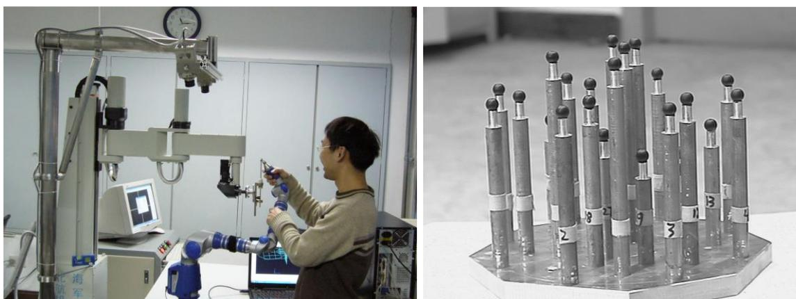
**Slika 23** Fantom za mjerenje Neuromaster sustava; Lijevo: Portabilni sustav FARO koje mjeri vrh sonde pričvršćene na Neuromaster robota; Desno: Fantom sa štapovima i plastičnim kuglicama korišten za mjerenje točnosti sustava [88].
