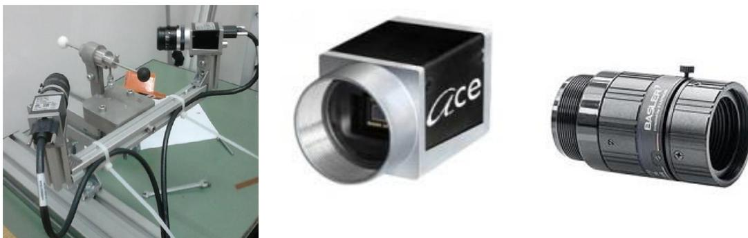
**Slika 43** Basler ace kamera; Lijevo: RONNAvision sustav koji se sastoji od dvije međusobno okomite Basler ace kamere čiji fokus gleda u kuglicu na kraju sonde koja je postavljena u vodilicu spojenu s nosačem za kamere; Sredina: Basler ace kamera bez objektiva; Desno: Objektiv za Basler ace kameru.
