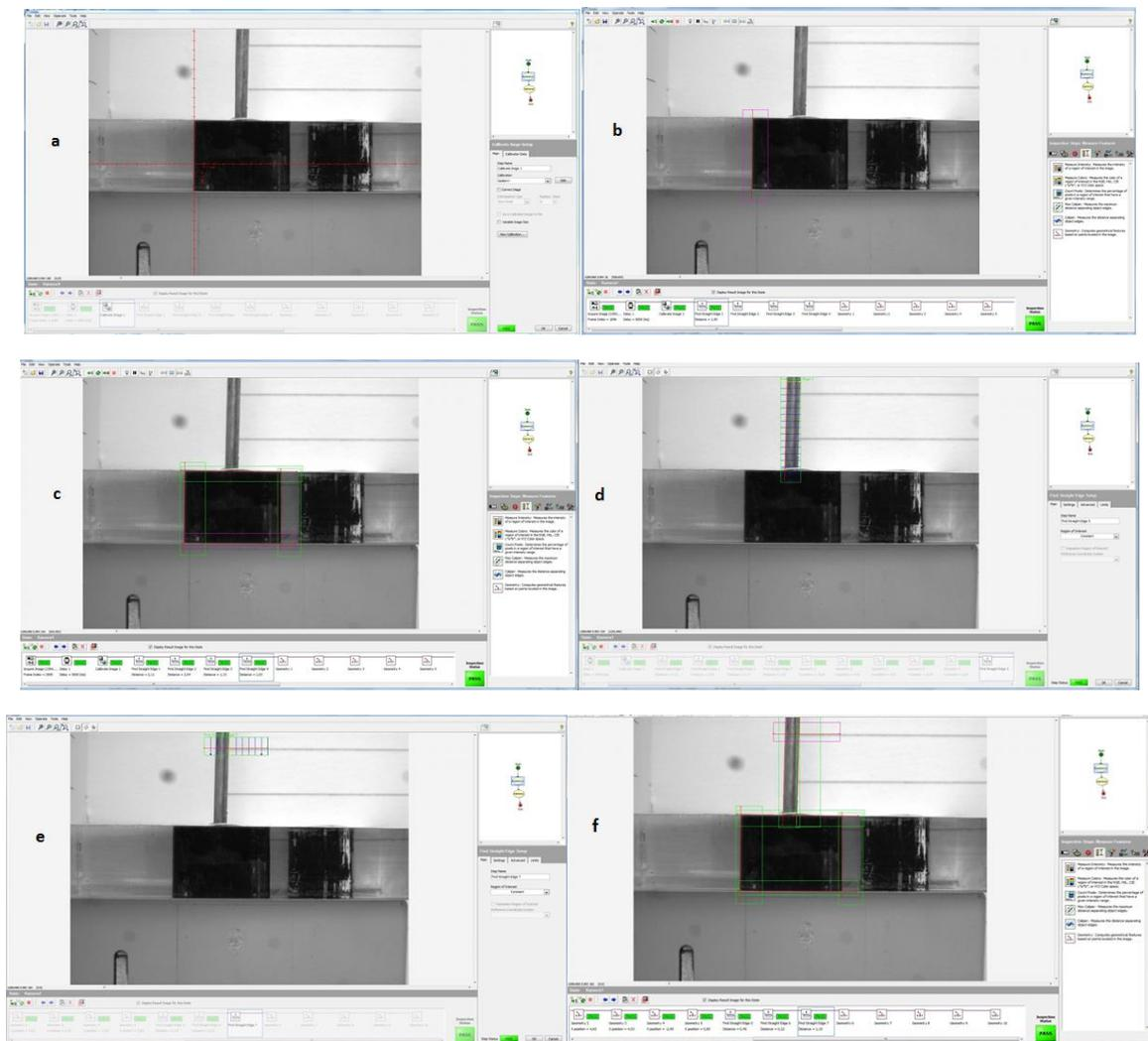
**Slika 44** Traženje linija objekata 1 i 2 u programu NI vision builder putem naredbe „Find straight edge“; a) Kalibracija putem širine objekta 1 koja iznosi u stvarnosti 13 mm; b) traženje linije na lijevom bridu objekta 1; c) Prikaz svih traženih linija na objektu 1; d) Traženje lijevog brida na objektu 2; e) Traženje gornjeg brida na objektu 2; f) Prikaz svih traženih bridova objekta 1 i 2.
