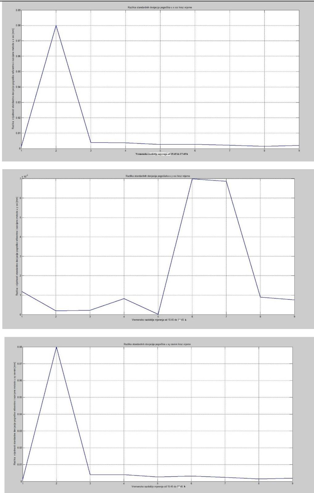
**Slika 81** Usporedni prikaz razlika rezultata standardnih devijacija obje metode kroz vrijeme, gdje su prikazani rezultati za mjerenja pogreške u x osi (gornja slika), y osi (srednja slika) i xy ravni (donja slika).
