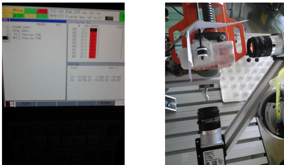
Slika 73 Lijevo: Teach pedant robota Fanuc LR5 200ic; Desno: Nosač za kamere na robotu Fanuc LR5 200ic s kamerom postavljenom za mjerenje pomoću referentne metode.
