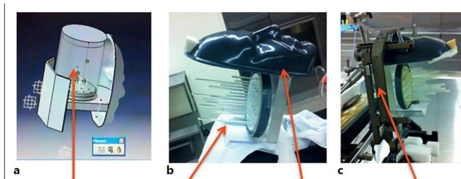
**Slika 21** Fantom korišten za mjerenje ROSA sustava; a) CAD model fantoma s odvojivim spremnikom; b) Stvarni fantom sa prikazom šupljih cijevčica koje predstavljaju ciljne točke i šupljom maskom lica koja služi za FL robotsku registraciju; c) Leksell okvira za koji je učvršćen fantom prilikom mjerenja; [86].
