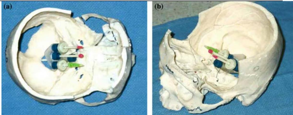
**Slika 15** (a i b) prikazuju tri markera koji predstavljaju ciljne točke tijekom kirurškog postupka. Plastična MRI kompatibilna lubanja s MRI kompatibilnim referentnim samoljepljivim markerima za registraciju [81].
