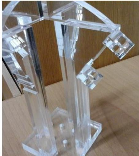
**Slika 36** Postupak sklapanja T-fantoma; lijepljenje pločica na nagibe.
