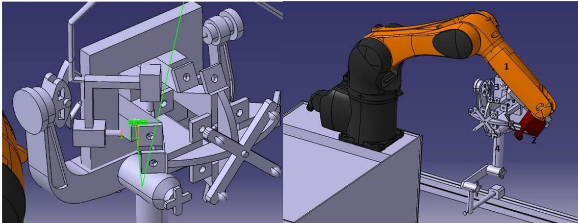
**Slika 32** Simulacija rada sustava s četvrtim konceptom fantoma za sustav RONNA; Lijevo: kamere postavljene tako da se provjeri mogućnost gledanja svake ciljne i ulazne točke svakog od trajektorija; Desno: simulacija prodora sonde u trajektorij. 1) Robot KUKA KR6, 2) Prihvatnica robota s vodicom i sondom, 3) Četvrti koncept fantoma, 4) Mayfield hvataljka.
