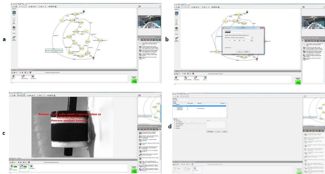
**Slika 57** Korak „pogreška pri traženju objekata kam 1“; a) Prikaz uvjeta za prelazak u korak „pogreška pri traženju objekata kam 1“; b) Prikaz koraka „pogreška pri traženju objekata kam 1“ sa svim korištenim naredbama s uvećanim tijekom rada; c) Prikaz poruke da je došlo do pogreške korisniku; d) Prikaz postavljanja brojila varijable „pogreška kam 1“ na početni iznos u naredbi „Set variable“.
