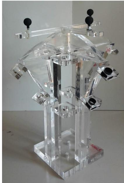
**Slika 39** Postupak sklapanja T-fantoma; Postavljanje sustava markera na lukove. Uzeti u obzir kako na ovoj slici nisu postavljene SLS čahure u svaku od trajektorija.
