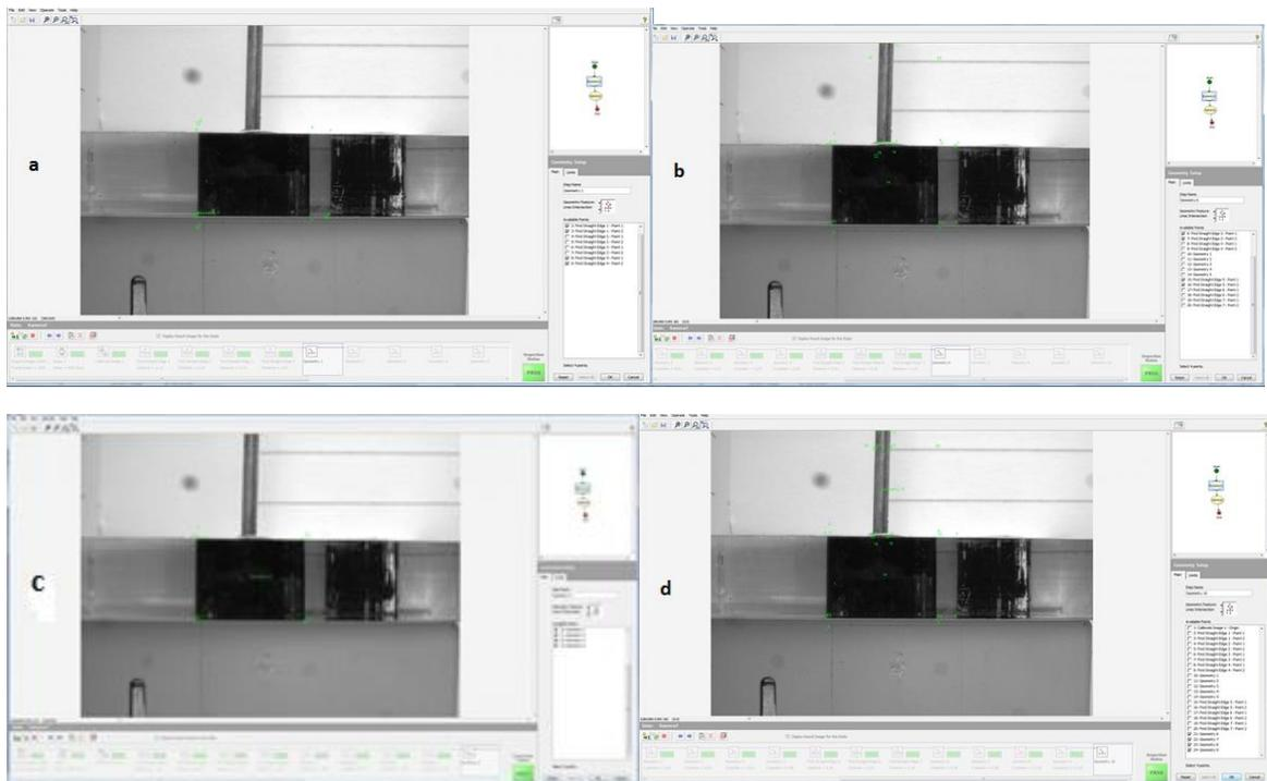
**Slika 45** Definiranje geometrijskih točaka na slici objekata 1 i 2 u programu NI Vision builder putem naredbe „Geometry“; a) definiranje sjecišta dva brida objekta 1 naredbom „Geometry“ s opcijom „Line intersection“; b) definiranje sjecišta dva brida objekta 2 naredbom „Geometry“ s opcijom „Line intersection“; c) definiranje težišta objekta 1 naredbom „Geometry“ s opcijom „Center of mass“; d) definiranje težišta objekta 2 naredbom „Geometry“ s opcijom „Center of mass“.
