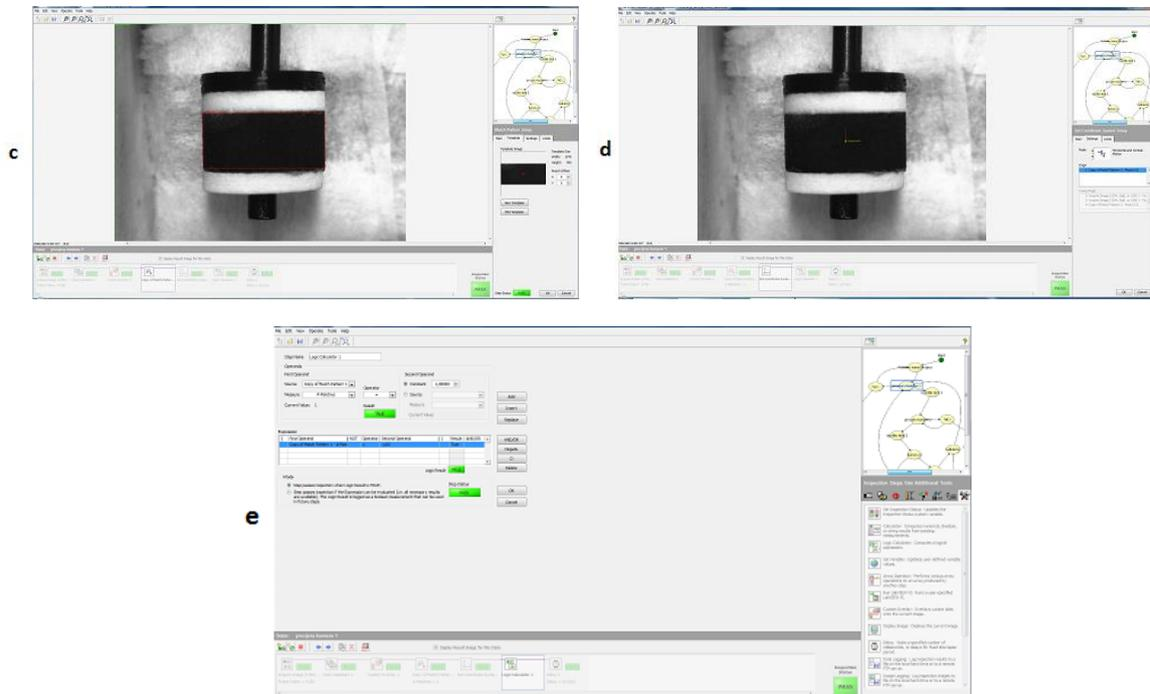
**Slika 55** Korak „provjera kamere 1“; a) Prikaz koraka „provjera kamere 1“ sa svim korištenim naredbama s uvećanim tijekom rada; b) Prikaz naredbe „Vision assistant“; c) Prikaz naredbe „Match pattern“; d) Prikaz naredbe „Set coordinate system“; e) Prikaz naredbe „Logic calculator“.
