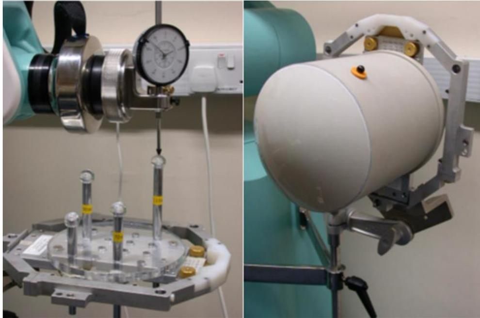
**Slika 19** Pathfinder sustav s cilindričnim fantomom; Lijevo: Pathfinder cilja središte kuglice, dok na izvršnom kraju drži pomičnu mjerku; Desno: cilindrični fantom sa „kožom“ u Mayfield hvataljki s pričvršćenim markerima za registraciju [84].
