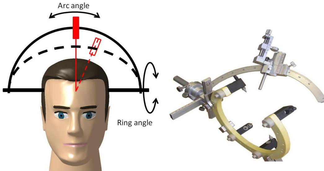
**Slika 4** Definicija stereotaktičkih kuteva prema [11]. Lijevo: Dvije pozicije su prikazane. Početna pozicija okvira i s isprekidanom linijom pozicija nakon rotacije oko obje osi. Primijetiti kako vrh alata ostaje u istoj translacijskoj poziciji; Desno: Zamaranow-Duchovny sustav: Ciljni prsten fiksiran je samo na jednoj strani [19].
