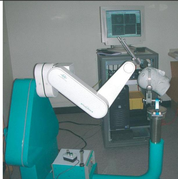
**Slika 6** Neuromate sustav u vlasništvu Reinshawa PLC, UK odobren od CE/FDA; Lijevo : Posljednja službena verzija dostupnog robota s fantomskom glavom pričvršćenom za hvataljku za glavu. Desno : prijašnje verzije neuromate sustava s kontrolnom jedinicom u pozadini slike.
