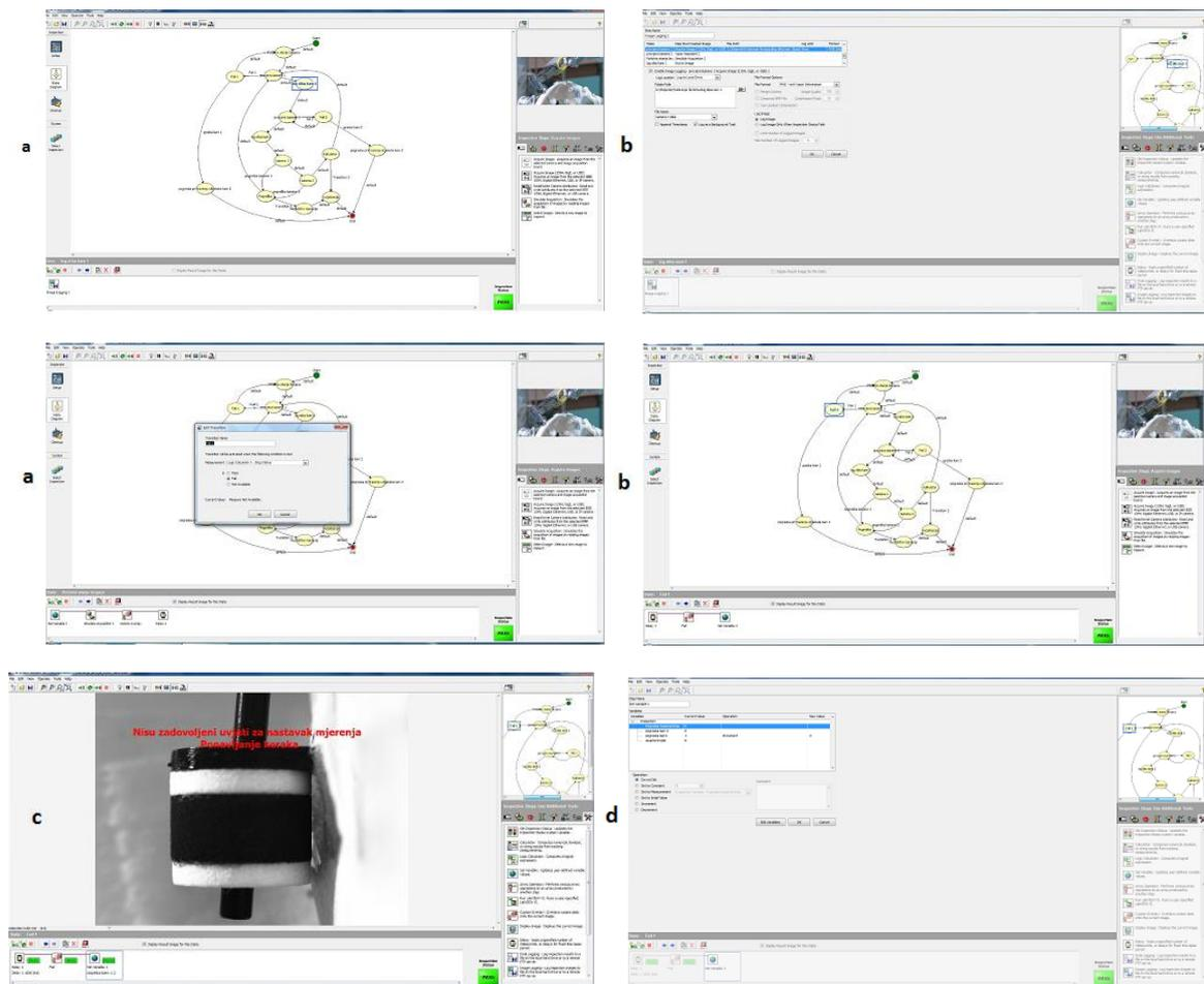
**Slika 56** Korak „Fail 1“; a) Prikaz uvjeta za prelazak u korak „Fail 1“; b) Prikaz koraka „Fail 1“ sa svim korištenim naredbama sa uvećanim tijekom rada; c) Prikaz poruke da je došlo do pogreške korisniku; d) Prikaz povećanja brojila varijable „pogreška kam 1“ u naredbi „Set variable“.
