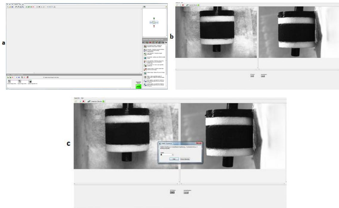
**Slika 52** Postupak namještanja kamere u programu NI Vision builder; a) Program „Pregled kamera“ sa svim korištenim naredbama; b) Slika s obje kamere u korisničkom sučelju; c) Izbornik za odabir programa.
