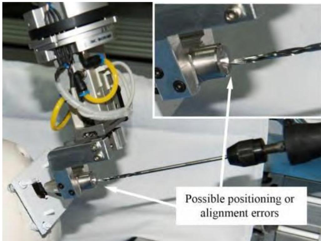
**Slika 11** Automatski način rada sustava RONNA; Kompenzacija mogućih pogrešaka pri pozicioniranju pomoćnog robota koja je osigurana krutošću glavnog robota koji drži vodilicu i nagibom na ulazu u vodilicu [64].
