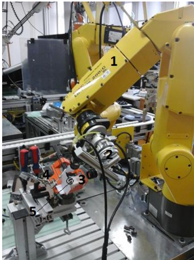
Slika 71 Mjerni laboratorijski postav za provjeru točnosti razvijene metode; 1) Robot Fanuc LR 200ic; 2) Nosač s kamerama; 3) Industrijska stega u kojoj se nalazi SLS čahura; 4) Držač sonde; 5) SLS čahura.
