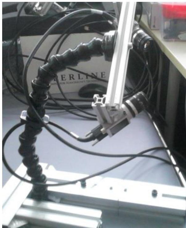
Slika 49 Stalac koji se sastoji od dva fleksibilna „Gooseneck“ GoPro stalka sa nosačem na kojemu se nalaze dvije okomito postavljene industrijske Basler ace kamere.
