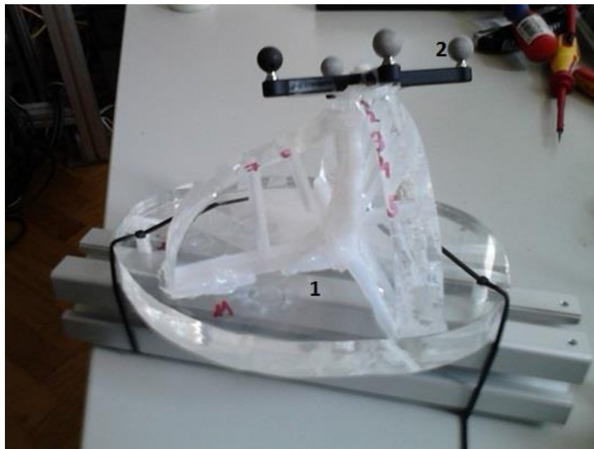
Slika 24 Fantom za mjerenje točnosti sustava RONNA; 1) baza i nagibi fantoma od pleksiglasa s izbušenim trajektorijama; 2) sustav četiri markera (lokalizator).
