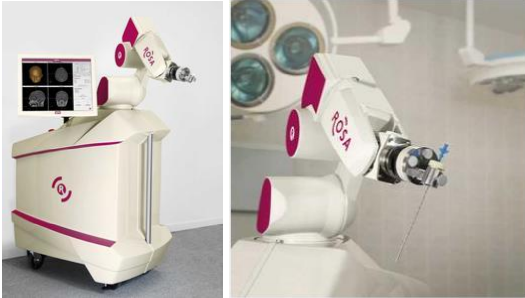
Slika 8 ROSA robot za neurokirurgiju (Medtech S.A.S., Francuska). Lijevo: Robot s korisničkim sučeljem; Desno: Uvećani prikaz držača alata robotskog sustava.
