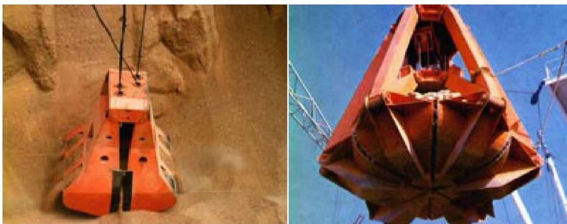
Slika 11. Različite izvedbe grabilica za rasute terete
