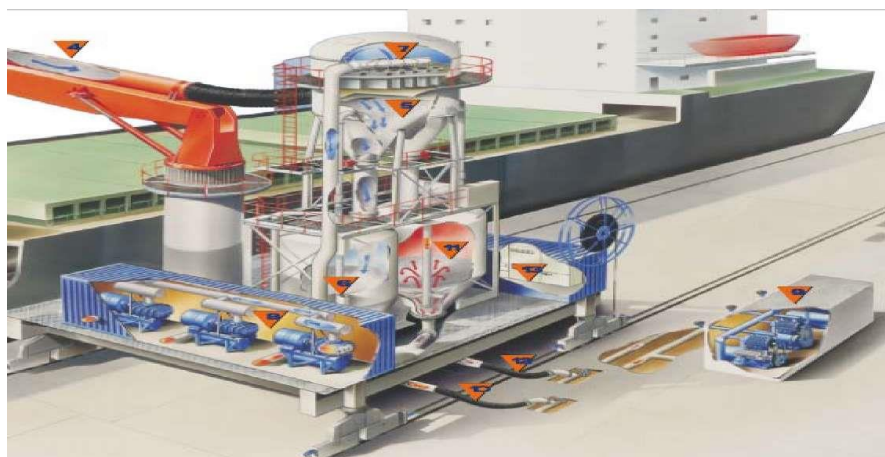
Slika 12. Uređaj za pneumatsko iskrcavanje rasutih tereta na tračnicama
