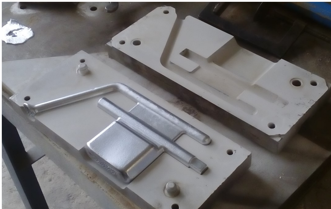
Slika 6.31. Vađenje odljevka iz kokile
