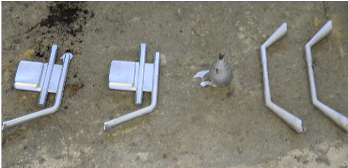
Slika 6.33. Odljevci od osnovne AlSi12 legure
