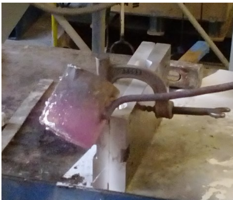
Slika 6.30. Lijevanje odljevka u metalnu kokilu
