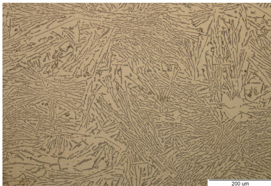
Slika 6.64. Mikrostruktura usitnjenog uzorka – vrh stošca
