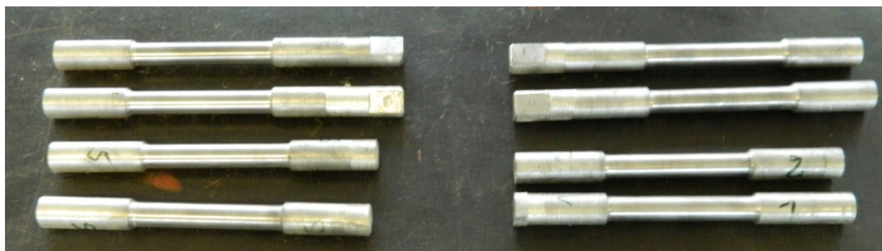
Slika 6.42. Epruvete za statičko vlačno ispitivanje
