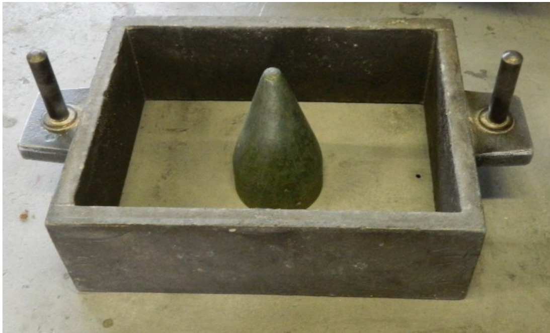
Slika 6.12. Postavljanje modela u kalupnik
