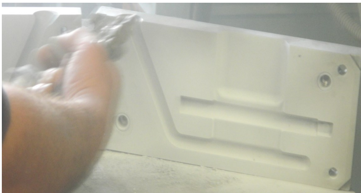
Slika 6.22. Naštrcavanje premaza od cirkonskog praha po unutrašnjem dijelu kokile
