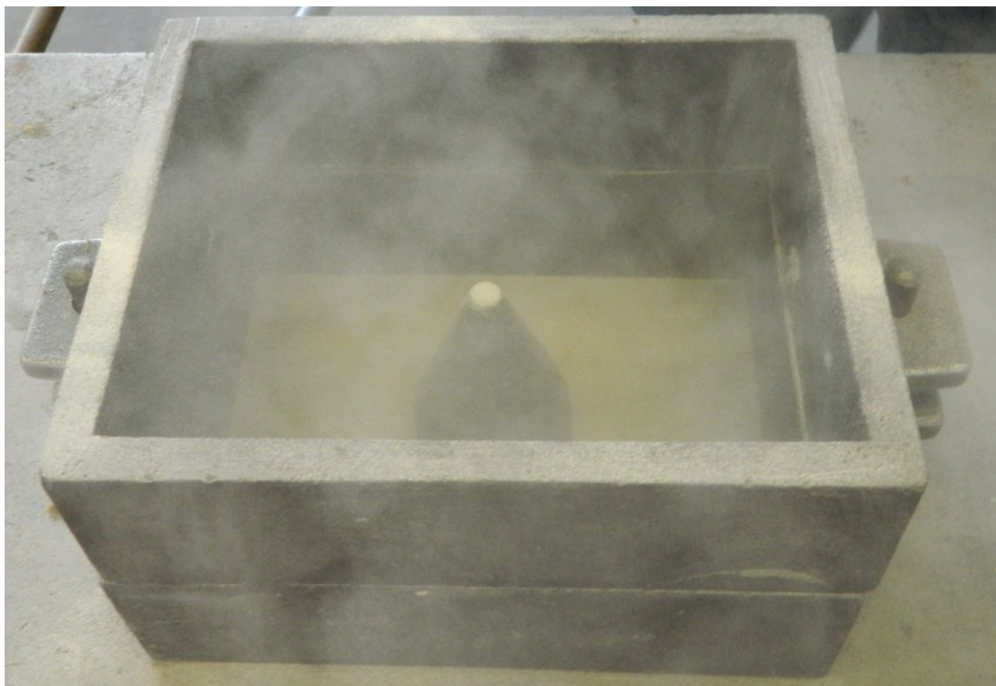
Slika 6.13. Posipavanje modela praškom likapodij
