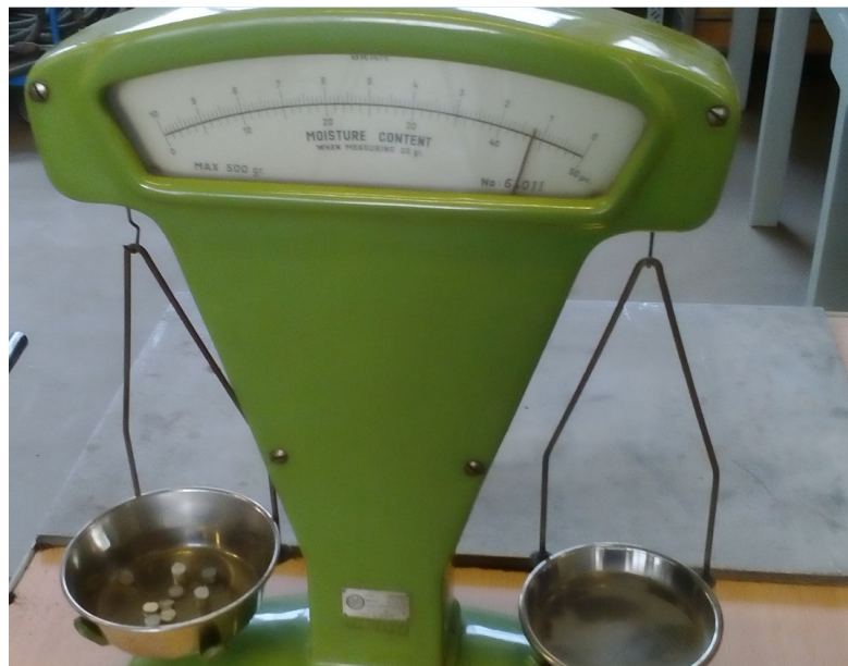
Slika 6.35. Vaganje predlegure AlTi5B1 na polužnoj vagi
