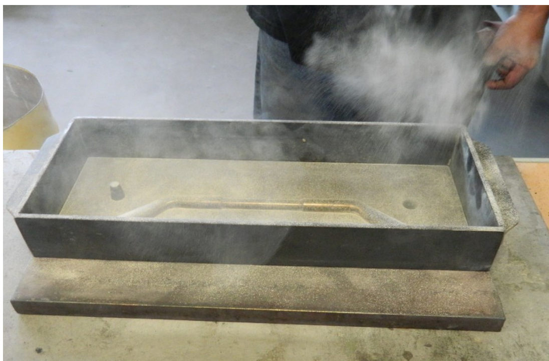
Slika 6.4. Posipavanje modela praškom likapodij
