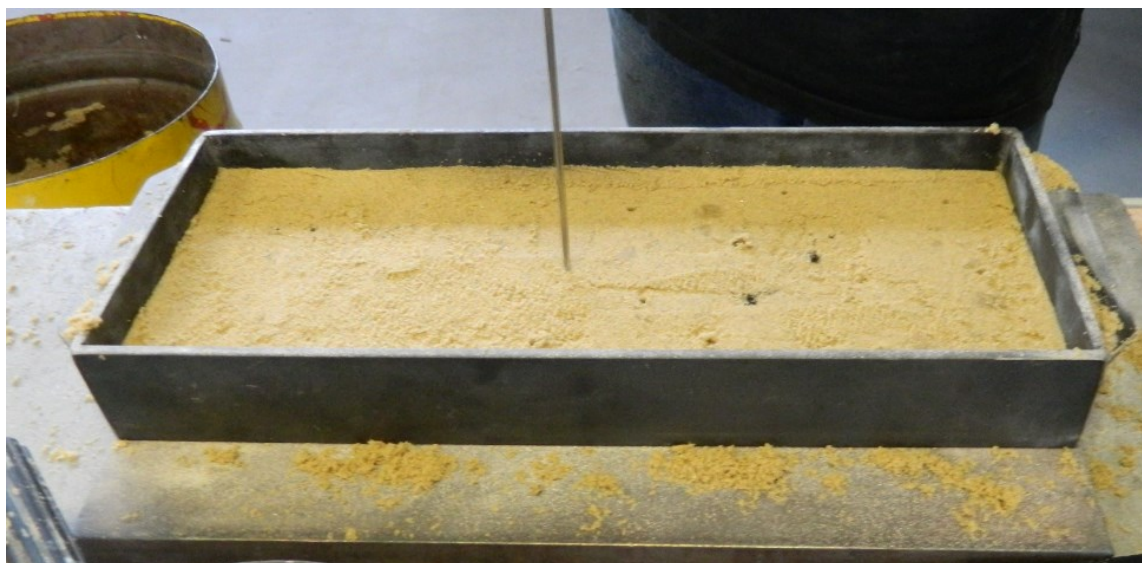
Slika 6.7. Bušenje odušaka u kalupu
