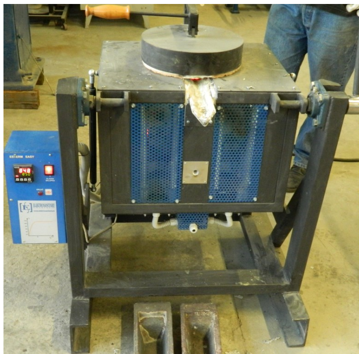
Slika 6.24. Peć za pripremu taljevine
