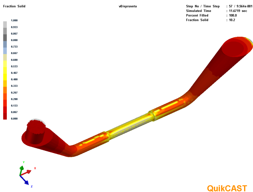
Slika 6.51. Početak skrućivanja epruvete
