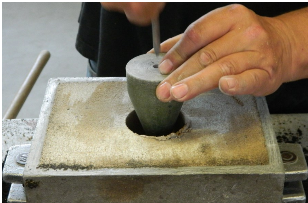
Slika 6.18. Vađenje modela iz kalupa
