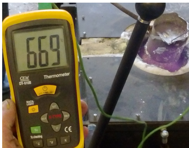
Slika 6.36. Mjerenje temperature taljevine nakon obrade
