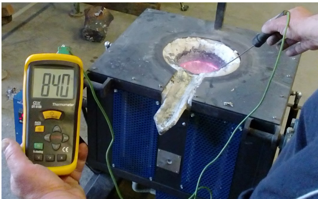
Slika 6.27. Mjerenje temperature taljevine
