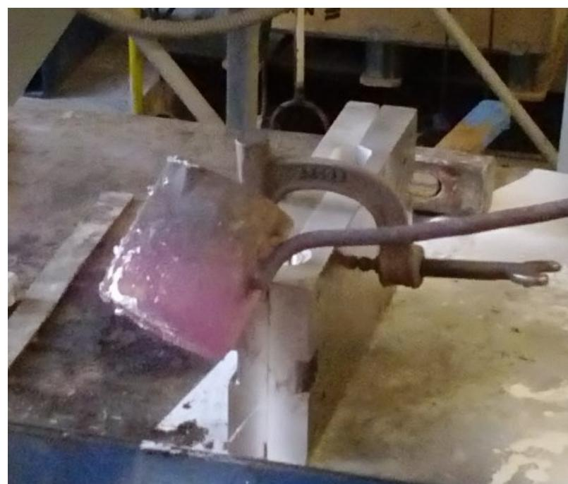
Slika 6.30. Lijevanje odljevka u metalnu kokilu
