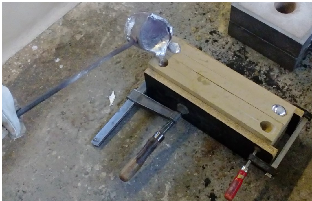
Slika 6.28. Lijevanje u kalupe izrađene postupkom vodeno staklo-CO 2
