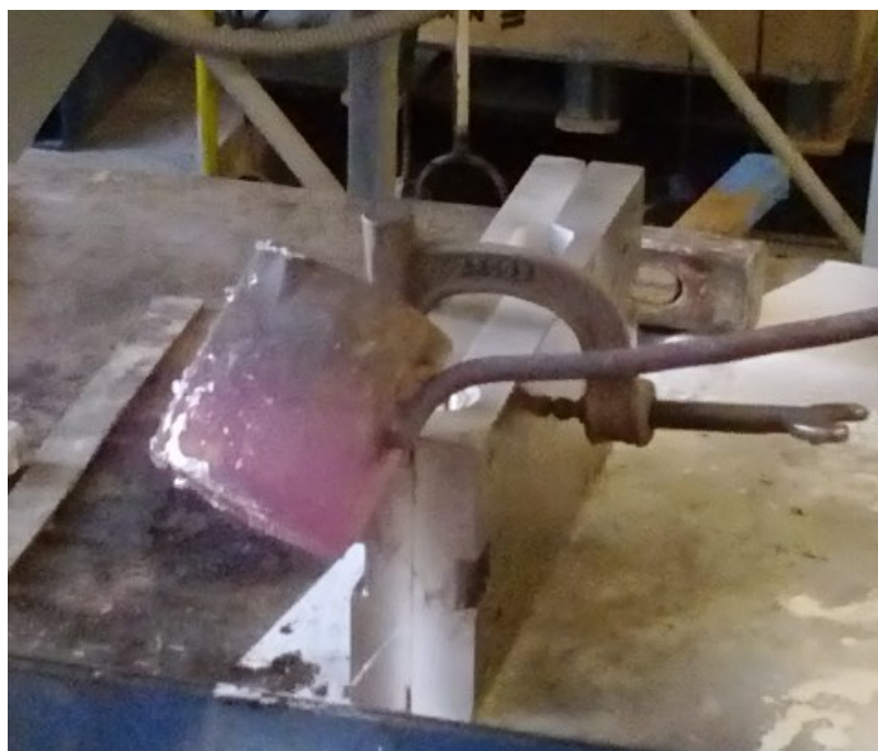
Slika 6.30. Lijevanje odljevka u metalnu kokilu
