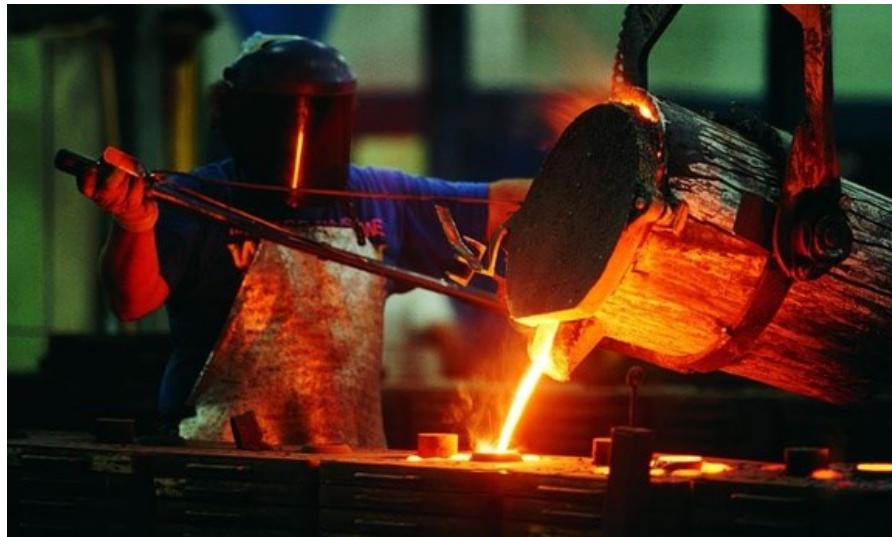
Slika 2.1. Lijevanje metala u kalup [4]
