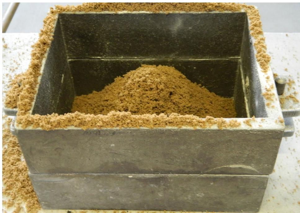
Slika 6.14. Nasipavanje modelnog pijeska
