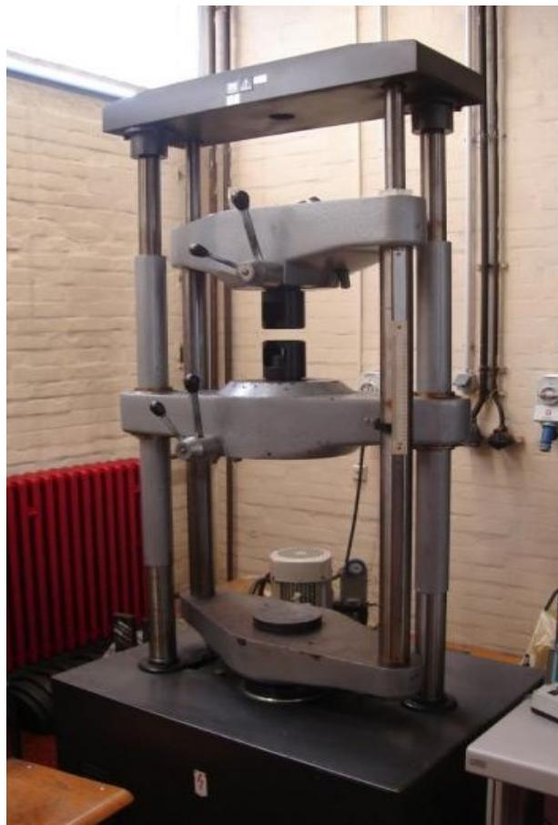
Slika 6.44. Hidraulička kidalica „VEB WPM“
