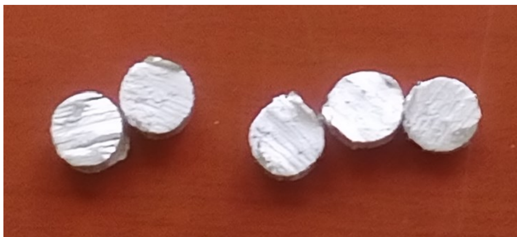
Slika 6.34. Tanke kriške predlegure AlTi5B1
