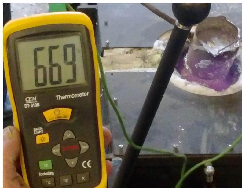
Slika 6.36. Mjerjenje temperature taljevine nakon obrade
