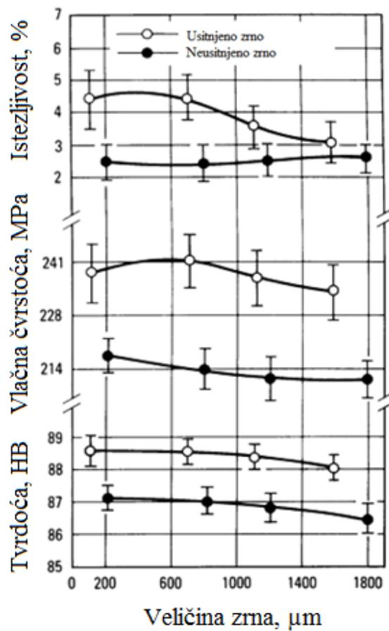
Slika 5.3. Mehanička svojstva legure A356 sa usitnjjenim i neusitnjjenim zrnom [19]
