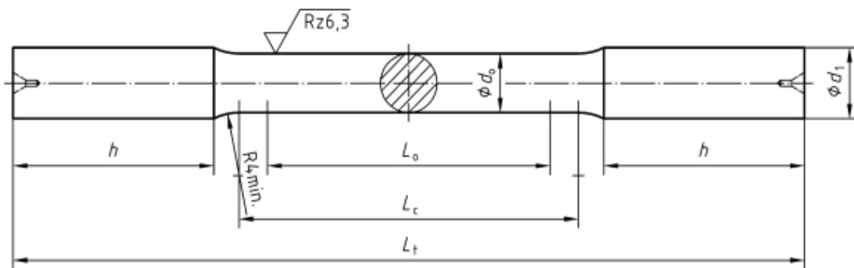
Slika 6.41. Dimenzije epruvete
