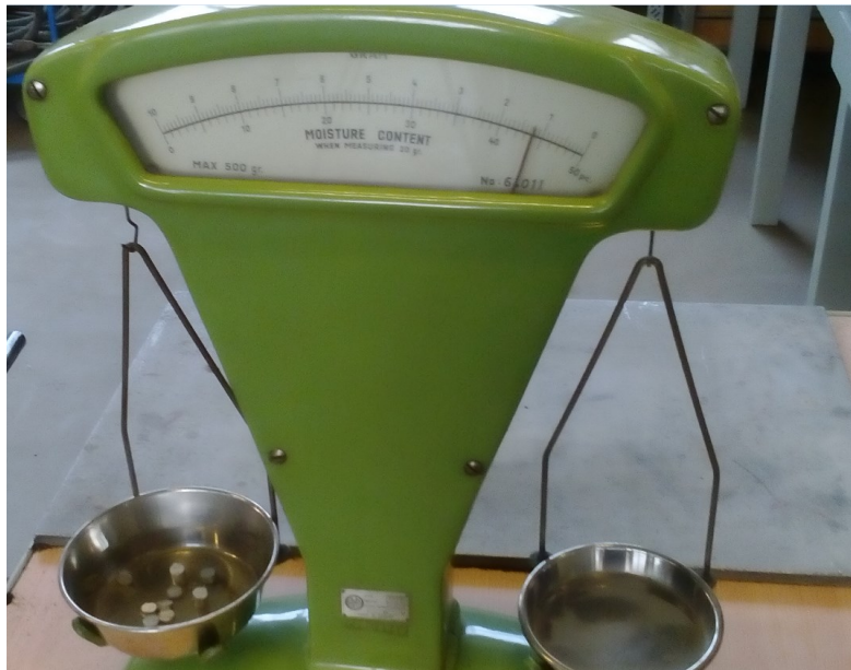
Slika 6.35. Vaganje predlegure AlTi5B1 na polužnoj vagi
