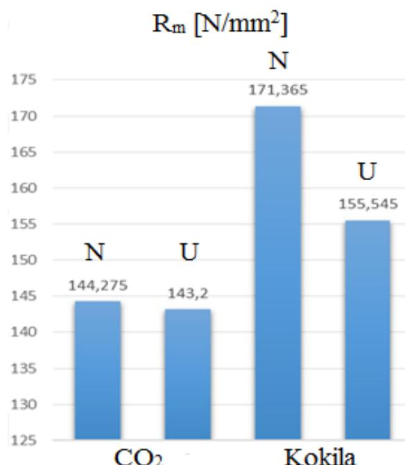
Slika 6.67. Grafički prikaz rezultata vlačne čvrstoće  $R_m$
