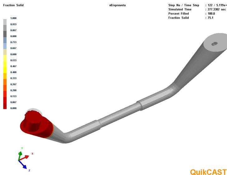
Slika 6.53. Završetak skrućivanja epruvete
