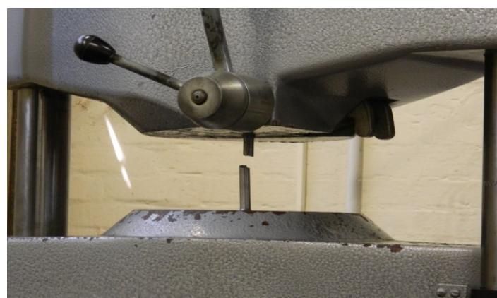
Slika 6.47. Lom epruvete
