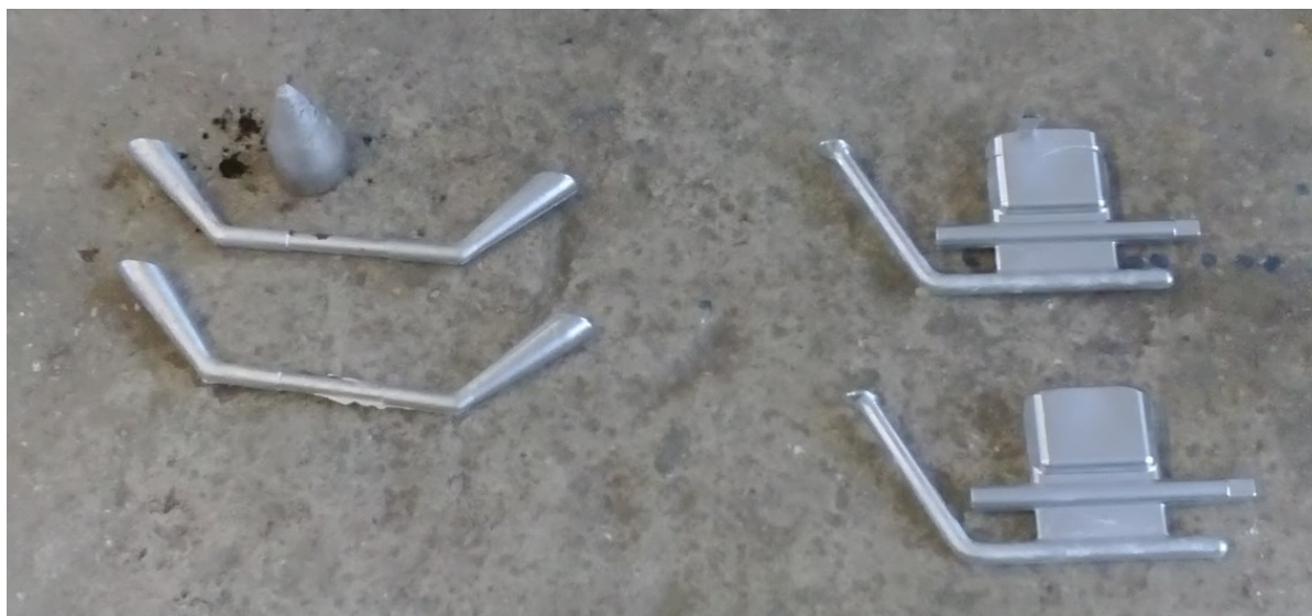
Slika 6.37. Odljevci od AlSi12 legure obrađene AlTi5B1 predlegurom
