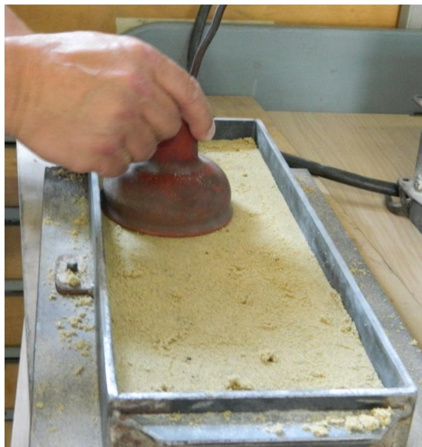
Slika 6.8. Očvršćivanje kalupne mješavine propuhivanjem plinom CO<sub>2</sub>
