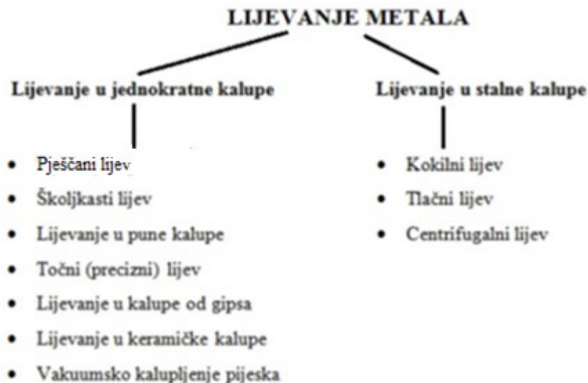
Slika 2.4. Podjela postupaka lijevanja metala [6]
