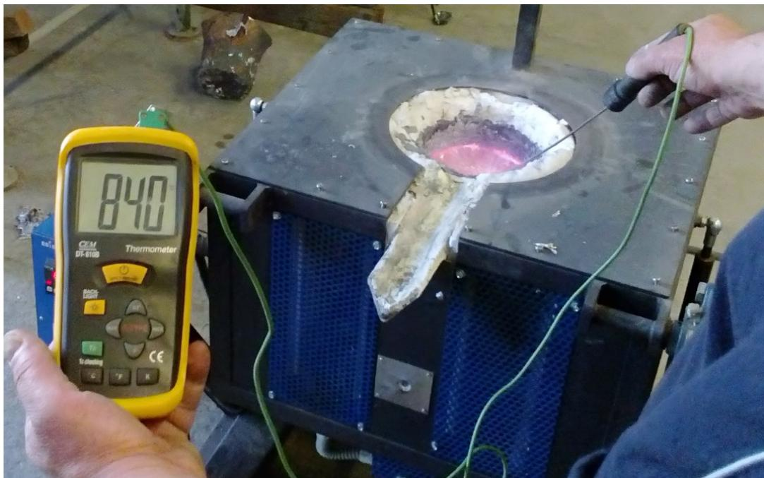
Slika 6.27. Mjerenje temperature taljevine
