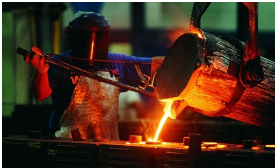
Slika 2.1. Lijevanje metala u kalup [4]
