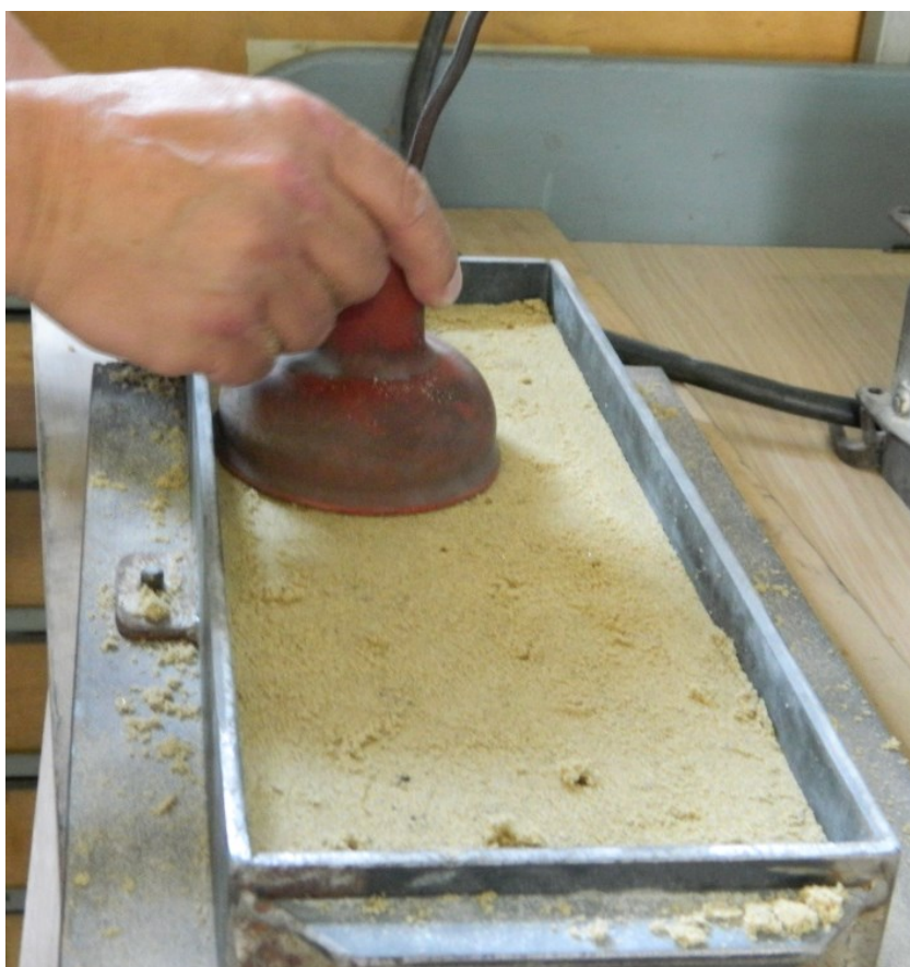
Slika 6.8. Očvršćivanje kalupne mješavine propuhivanjem plinom CO 2
