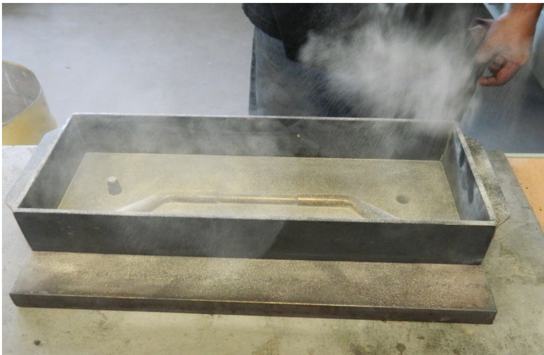
Slika 6.4. Posipavanje modela praškom likapodij
