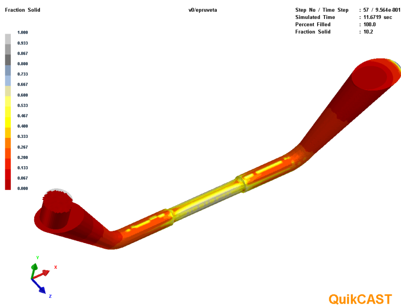
Slika 6.51. Početak skrućivanja epruvete
