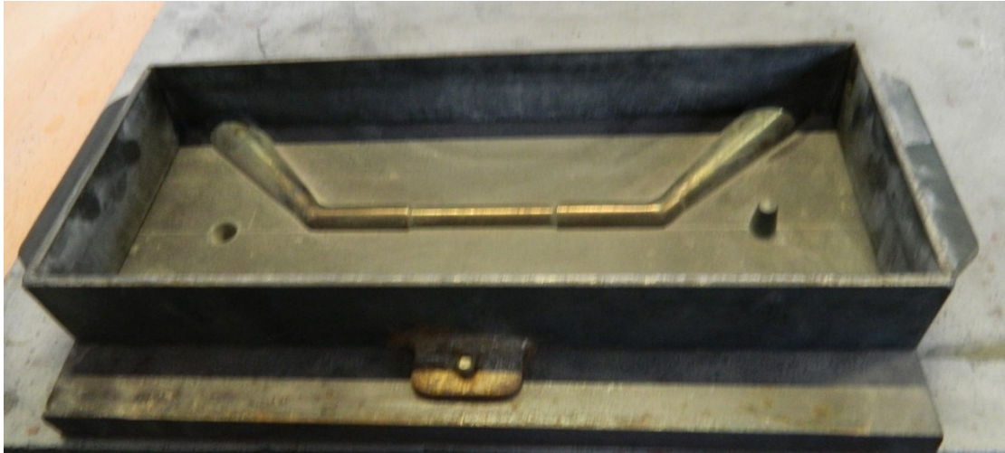
Slika 6.3. Kalupnik s modelom
