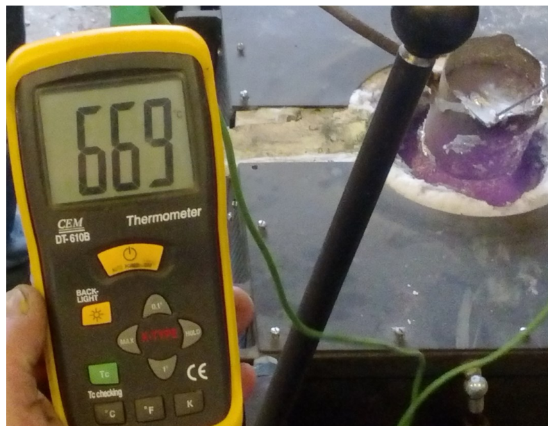
Slika 6.36. Mjerenje temperature taljevine nakon obrade
