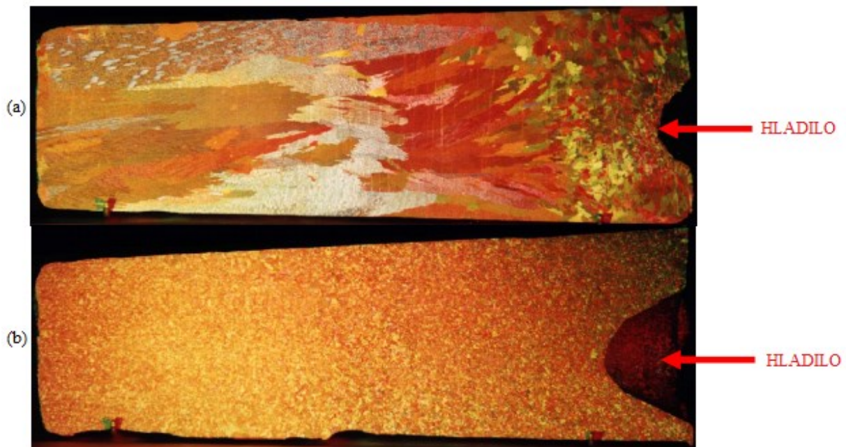
Slika 5.1. Struktura zrna odljevka od 3004 legure ((a) neusitnjena, (b) usitnjena sa 10 ppm B dodanog u obliku AlTiB predlegure) [20]
