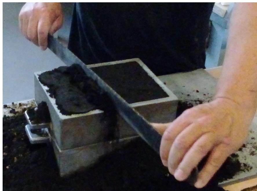
Slika 6.17. Odstranjivanje viška kalupne mješavine
