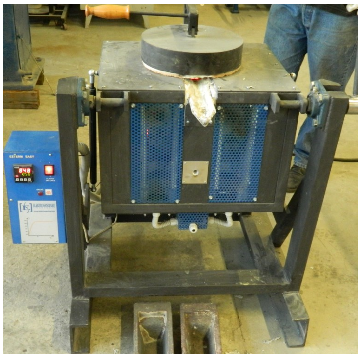
Slika 6.24. Peć za pripremu taljevine
