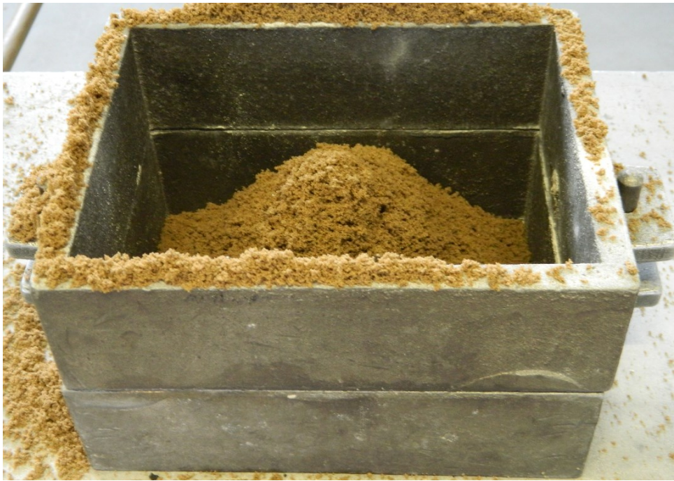
Slika 6.14. Nasipavanje modelnog pijeska
