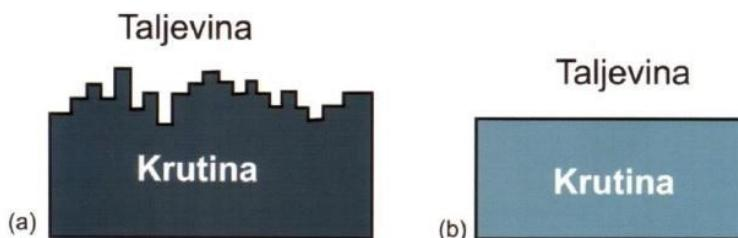
Slika 4.4. Shematski prikaz granične površine kruto/tekuće: (a) atomski gruba (hrapava) ili difuzna granična površina površina [12]
