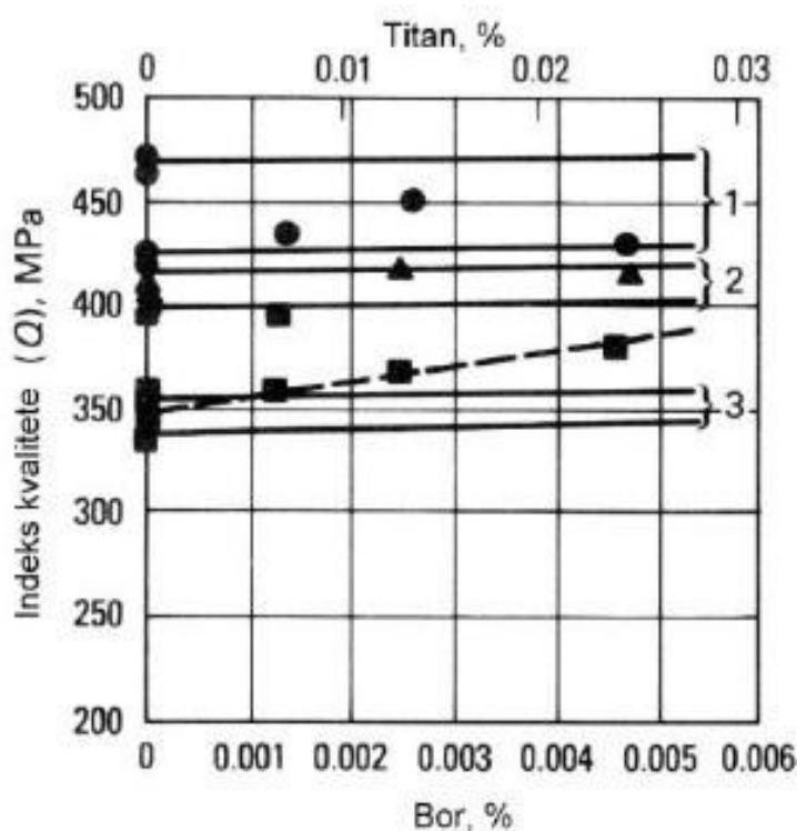
Slika 5.2. Utjecaj titan-bor (Ti-B) cjepliva na Al-Si leguru kao funkciju sadržaja titana i brzine hlađenja (1 – 1,5 °C/s, 2 – 0,5 °C/s, 3 – 0,08 °C/s) [19]
