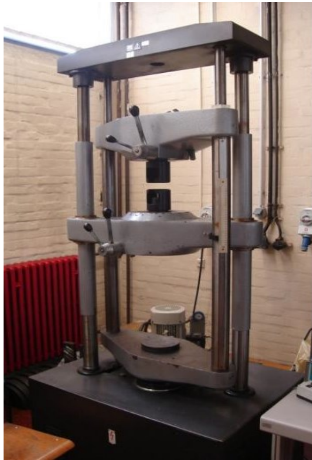
Slika 6.44. Hidraulička kidalica „VEB WPM“
