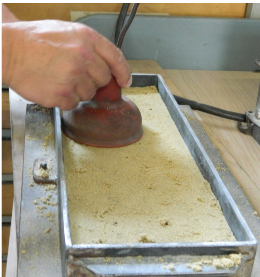
Slika 6.8. Očvršćivanje kalupne mješavine propuhivanjem plinom CO 2
