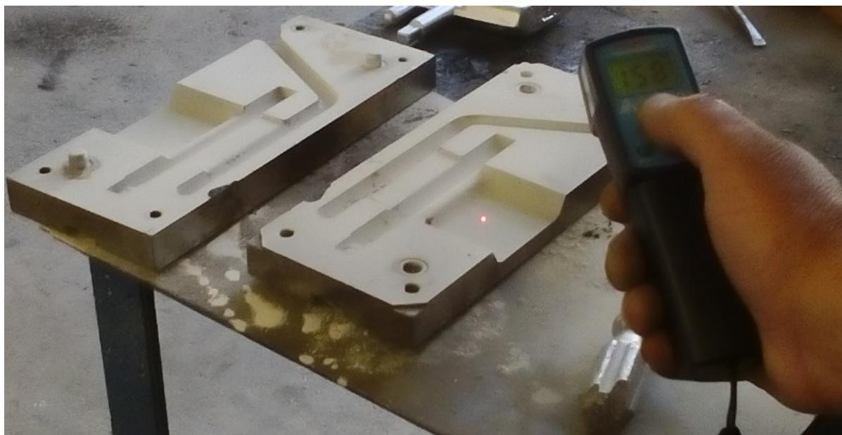
Slika 6.21. Mjerenje temperature kokile pomoću pirometra
