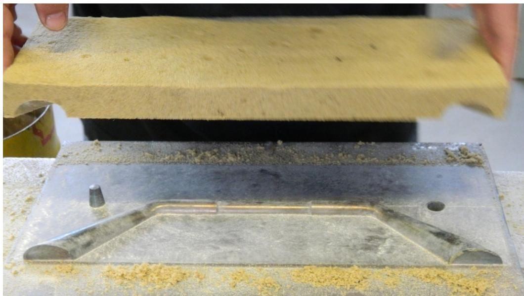
Slika 6.9. Vađenje jednog dijela kalupa iz kalupnika
