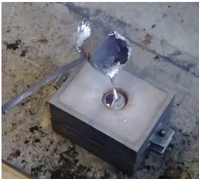
Slika 6.29. Lijevanje stošca u kalup od svježe kalupne mješavine
