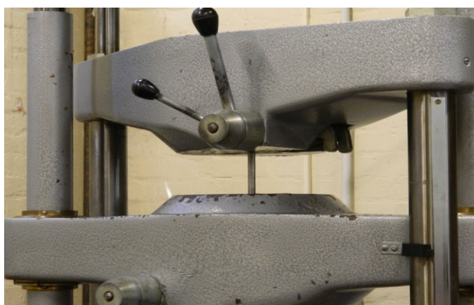
Slika 6.46. Početak statičkog vlačnog ispitivanja epruvete
