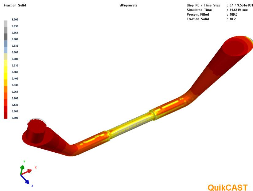
Slika 6.51. Početak skrućivanja epruvete
