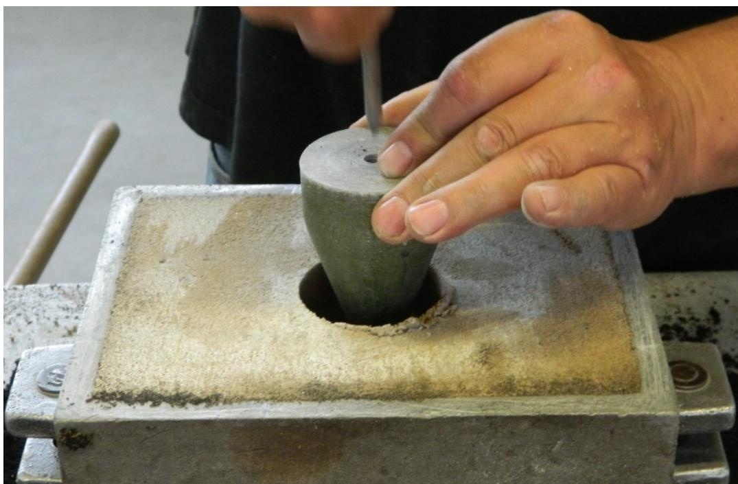
Slika 6.18. Vađenje modela iz kalupa
