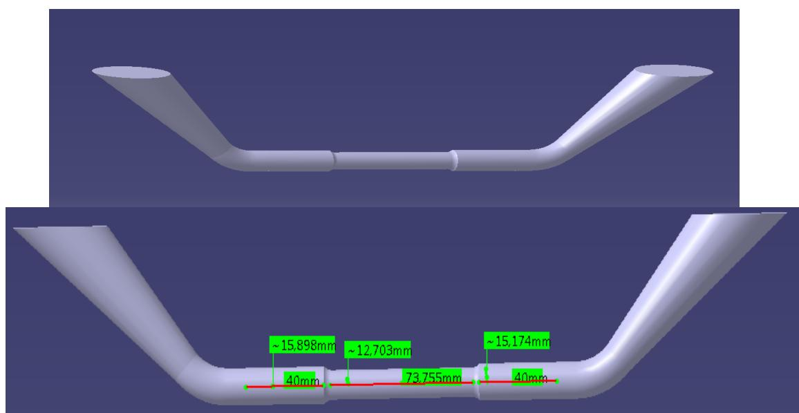
Slika 6.1. Model epruvete
