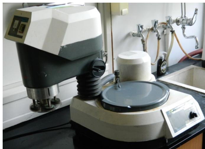
Slika 6.38. Stroj za brušenje „Buehler“
