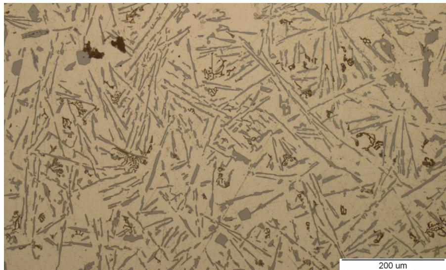
Slika 6.61. Mikrostruktura neusitnjene uzorka - vrh stošca
