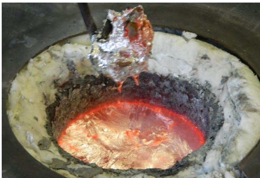
Slika 6.26. Skidanje troske iz taljevine
