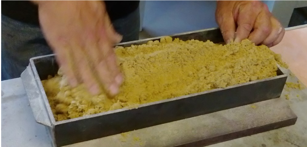
Slika 6.5. Popunjavanje kalupnika kalupnom mješavinom
