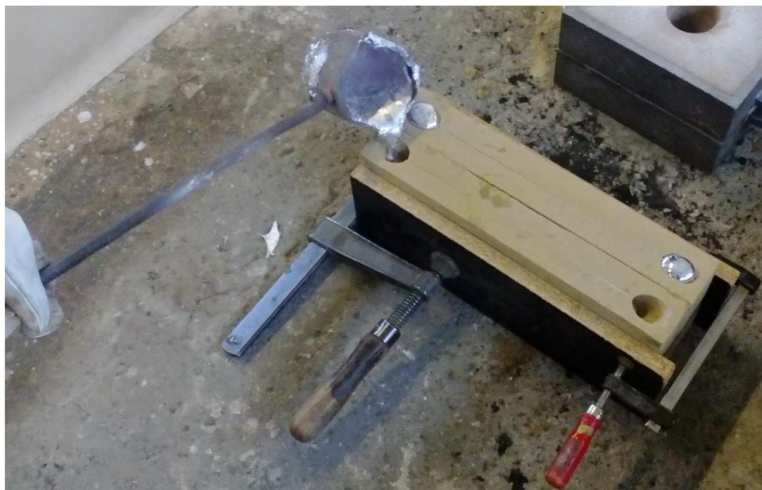
Slika 6.28. Lijevanje u kalupe izrađene postupkom vodeno staklo-CO<sub>2</sub>
