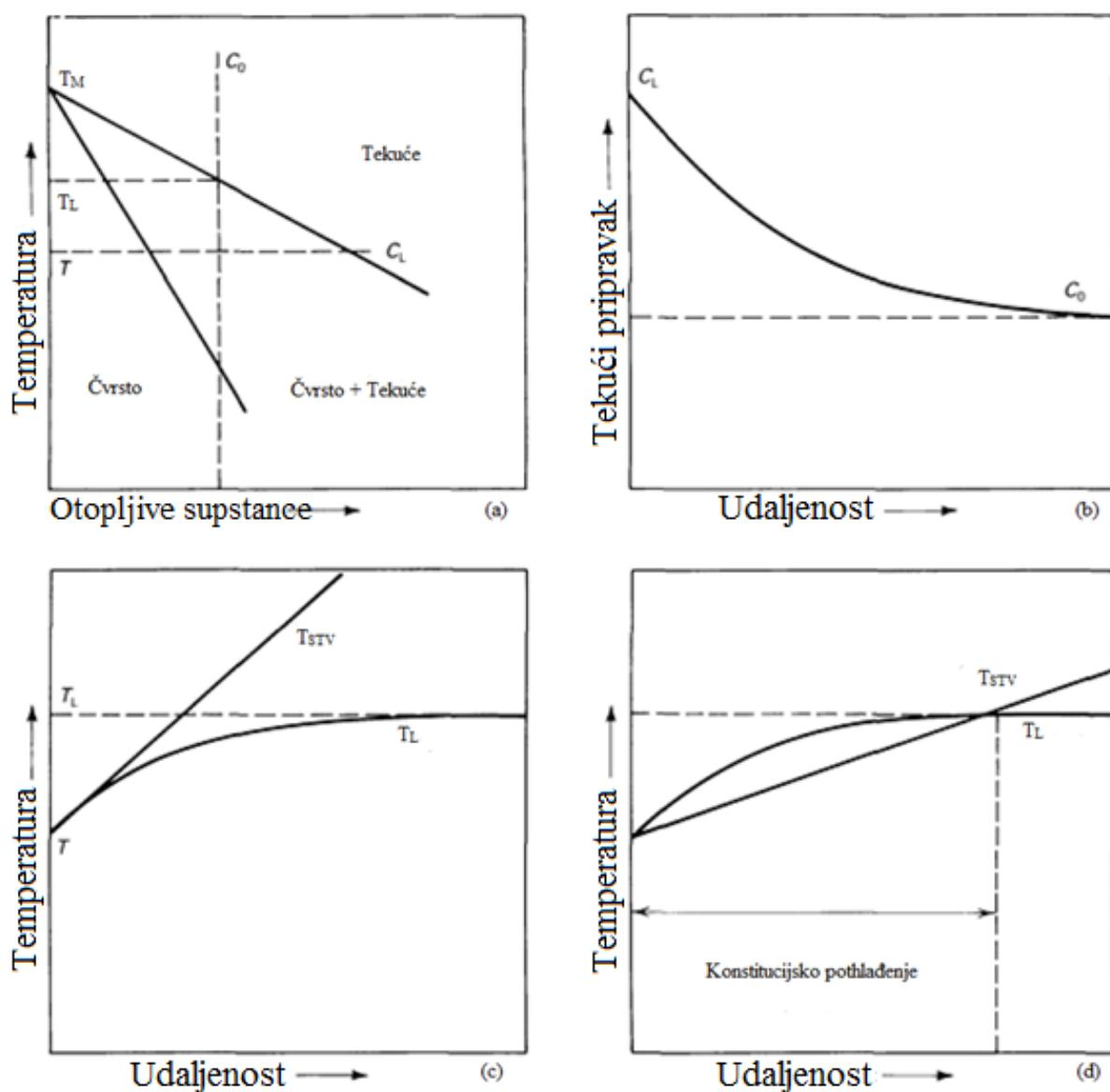
Slika 5.5. Konstitucijsko pothlađenje tijekom očvršćivanja legure s sastavom  $C_0$ , (a) fazni dijagram, (b) sloj obogaćen otopljivim supstancama ispred površine čvrsto/tekuće, (c) stabilno sučelje, (d) nestabilno sučelje [19]
