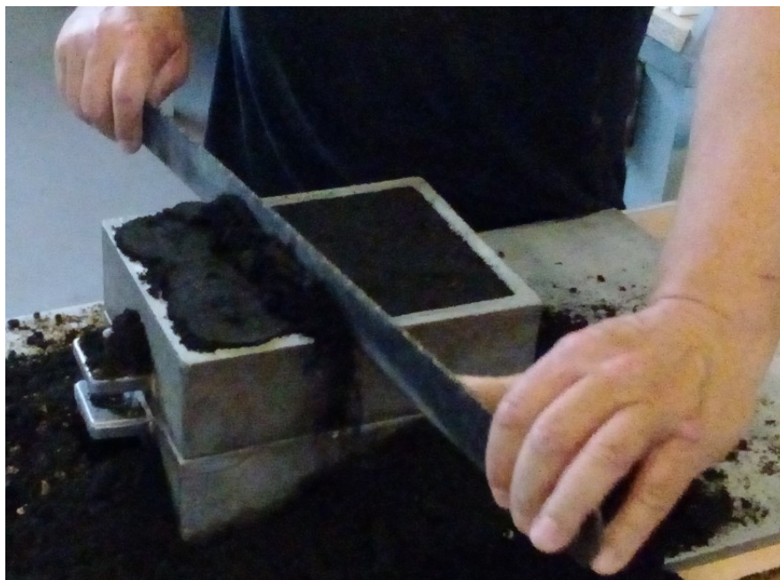
Slika 6.17. Odstranjivanje viška kalupne mješavine
