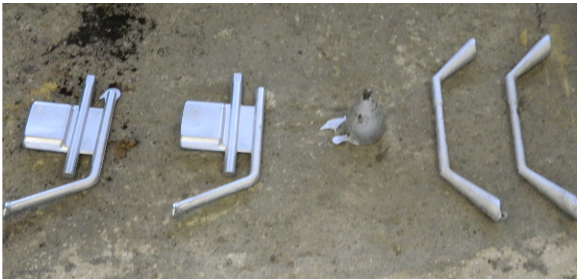
Slika 6.33. Odljevci od osnovne AlSi12 legure
