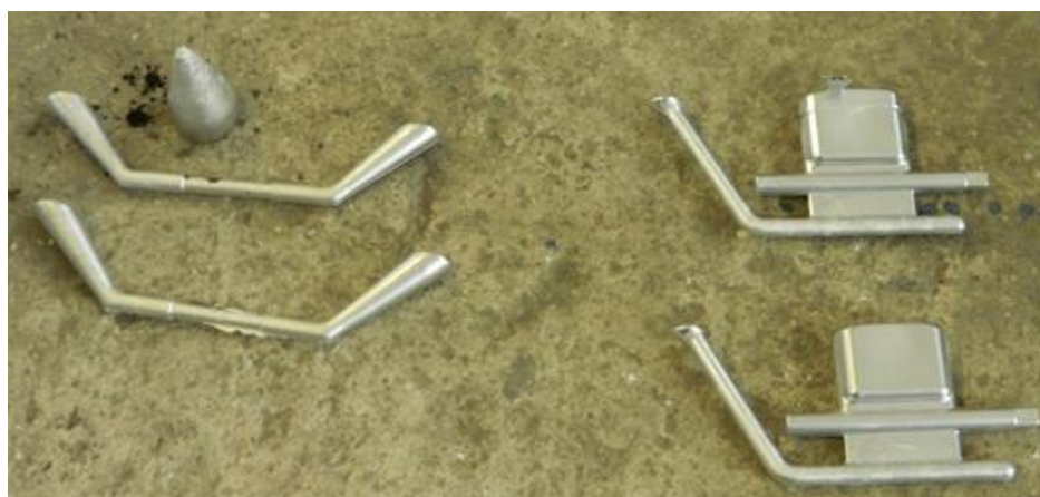
Slika 6.31. Odljevci od taljevine modificirane natrijem
