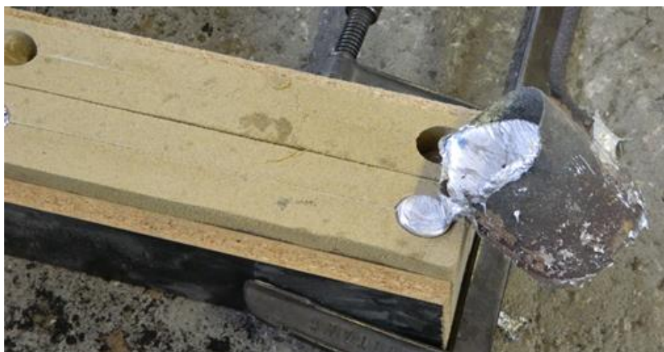
Slika 6.30. Ulijevanje modificirane taljevine u kalup izrađen postupkom vodeno staklo-CO 2
