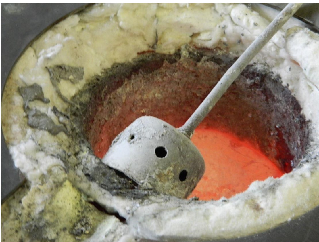
Slika 6.28. Grijanje modifikatora u zvonu za uranjanje
