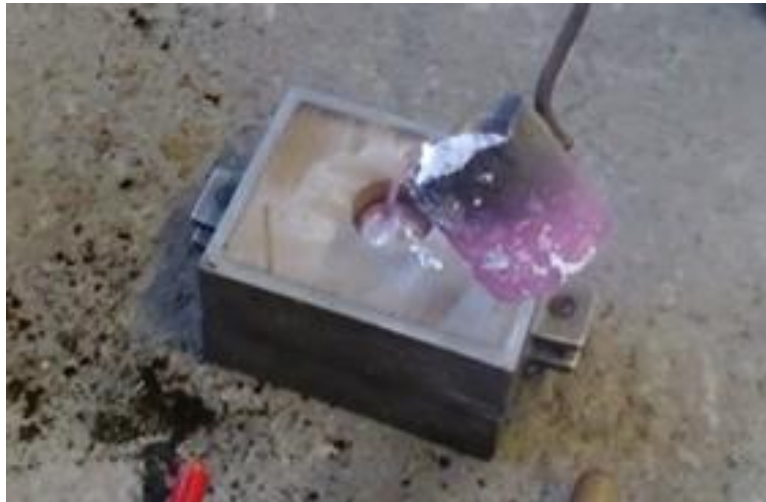
Slika 6.24. Lijevanje stošca u kalup od svježe kalupne mješavine
