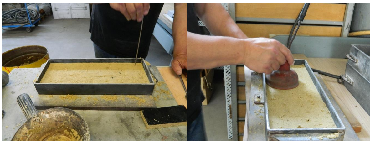
Slika 6.11. Izrada odušaka u kalupnoj mješavini (lijevo) te očvršćivanje mješavine CO 2 plinom (desno)
