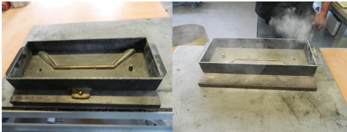
Slika 6.8. Kalupnik (lijevo), posipanje kalupnika likapodijem (desno)
