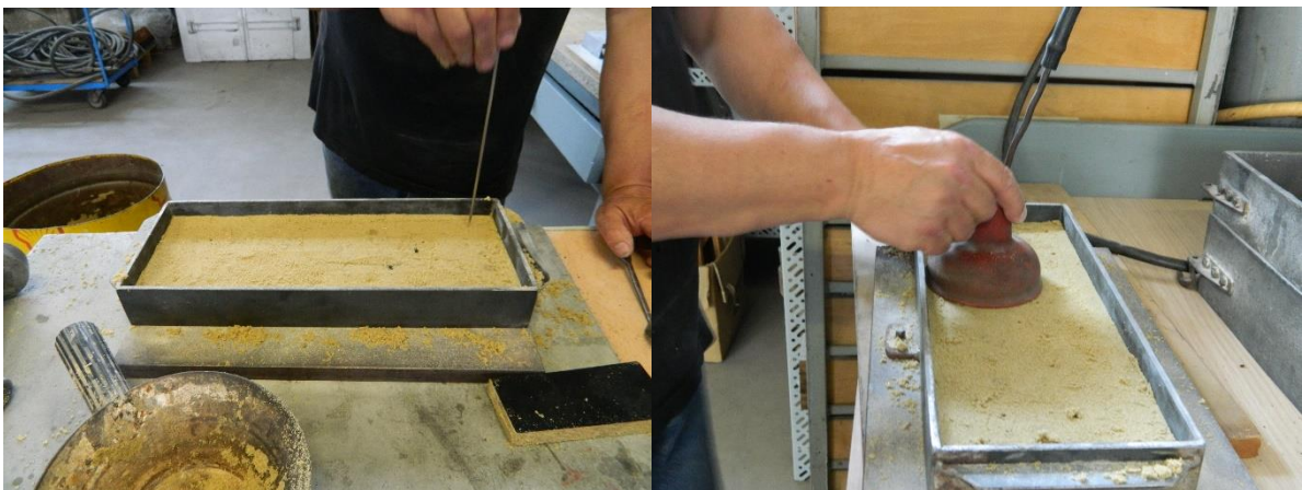
Slika 6.11. Izrada odušaka u kalupnoj mješavini (lijevo) te očvršćivanje mješavine CO 2 plinom (desno)
