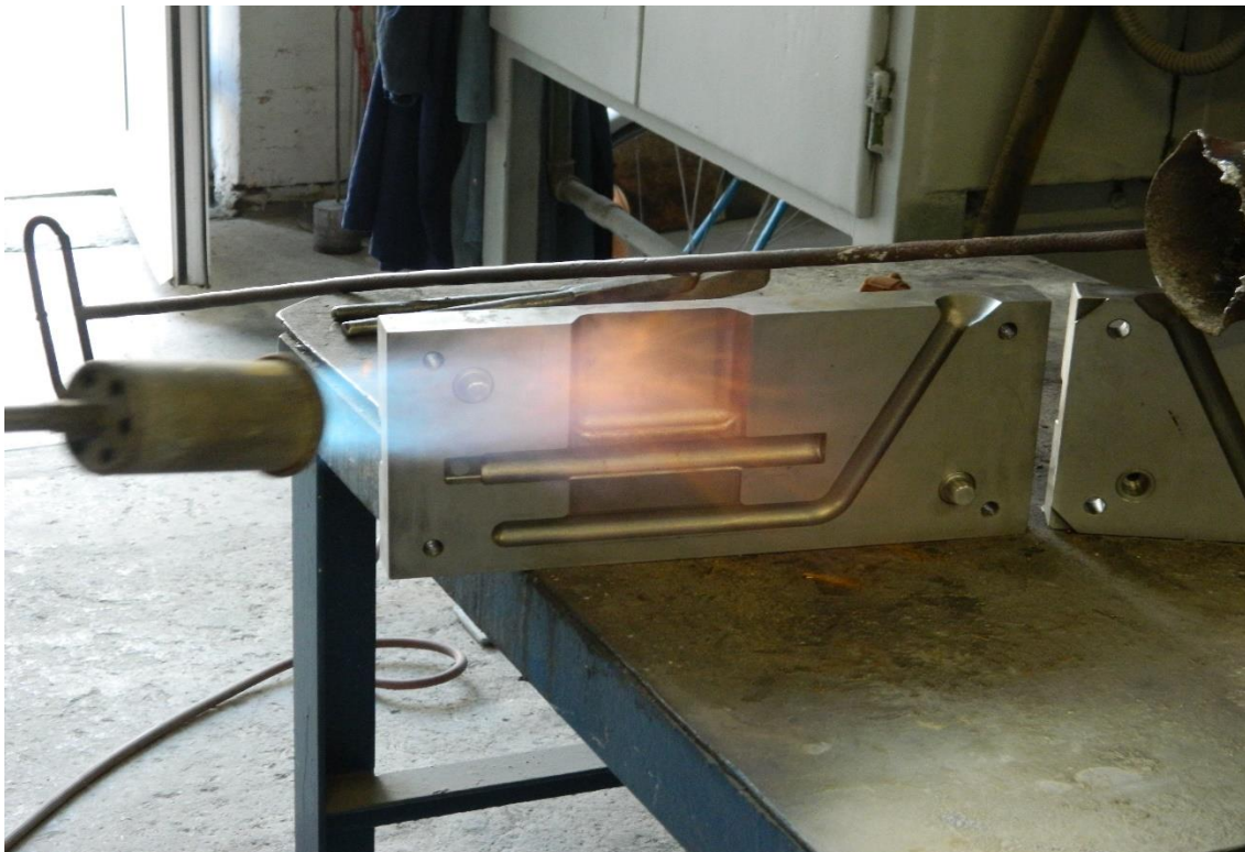
Slika 6.19. Predgrijavanje kokile i lonca za prijenos taljevine
