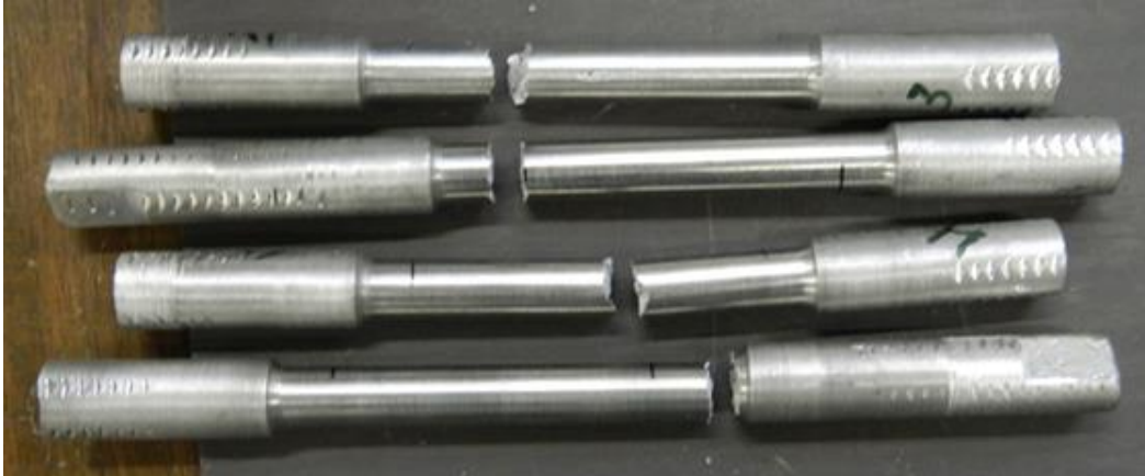
Slika 6.44. Epruvete nakon kidanja
