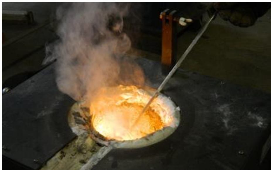
Slika 6.29. Uranjanje modifikatora u taljevinu
