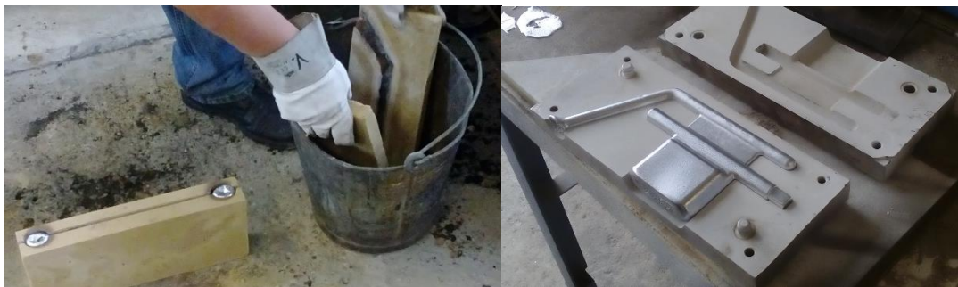
Slika 6.25. Vađenje odljevka iz kalupa vodeno staklo-CO 2 (lijevo), kokila (desno)
