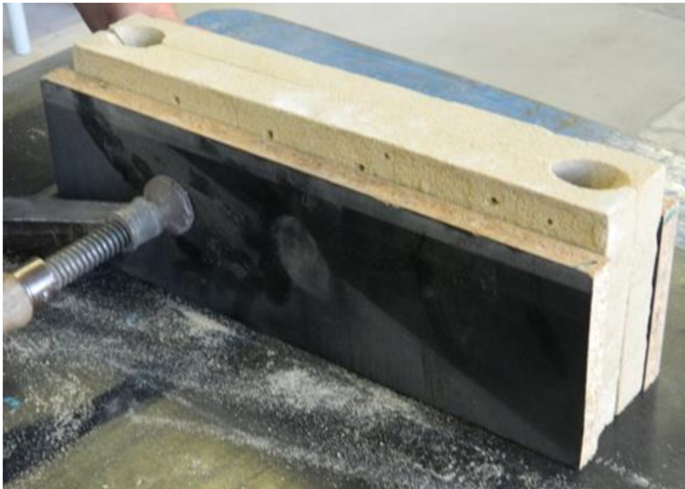
Slika 6.13. Kalup spreman za ulijevanje
