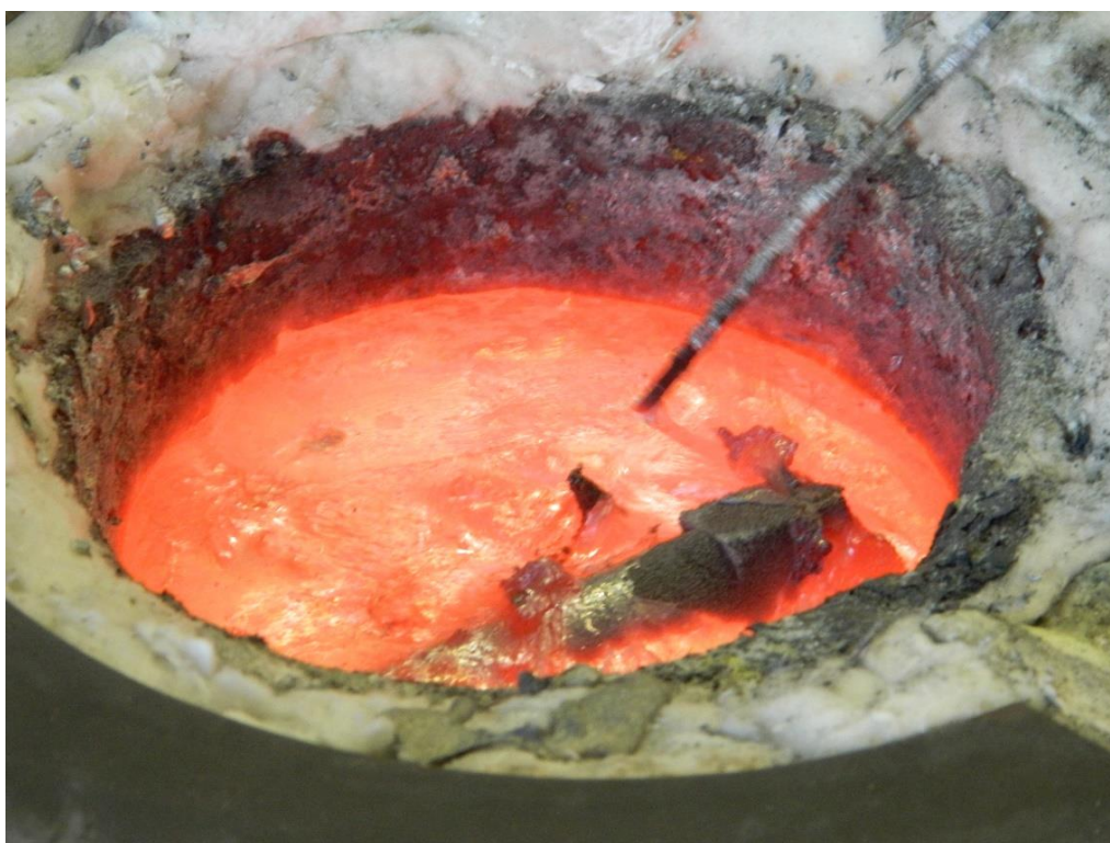
Slika 6.21. Uklanjanje troske s vrha taline
