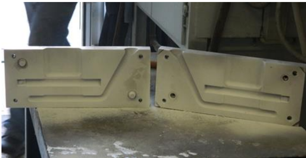
Slika 6.20. Kokila poprskana cirkonskim premazom
