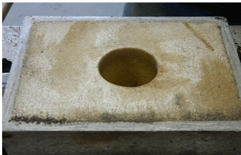
Slika 6.18. Kalup spreman za ulijevanje
