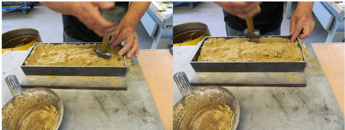
Slika 6.10. Sabijanje kalupne mješavine
