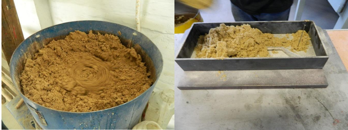
Slika 6.9. Miješanje kalupne smjese (lijevo) te njeno usipanje u kalupnik (desno)
