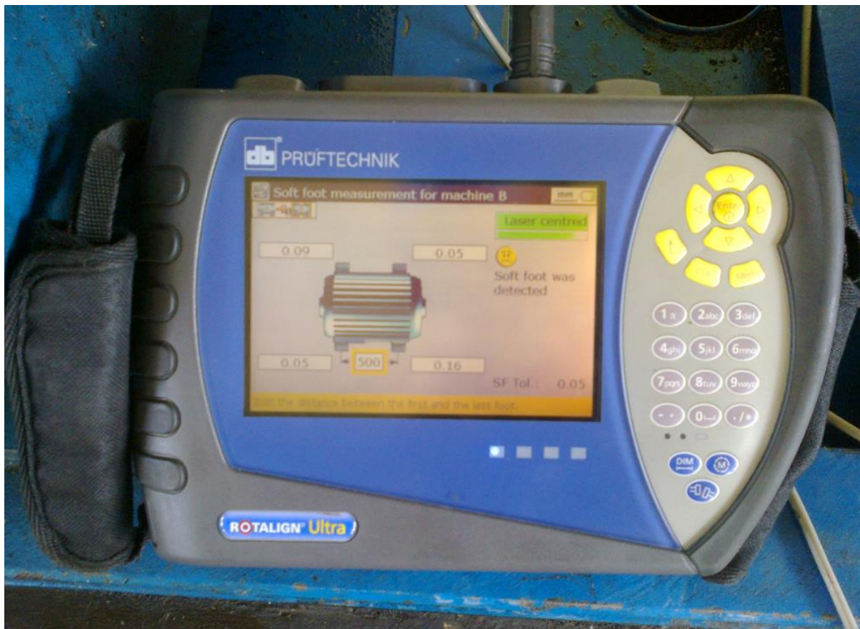
Slika 43. Postupak detekcije i otklanjanja „soft foot“
