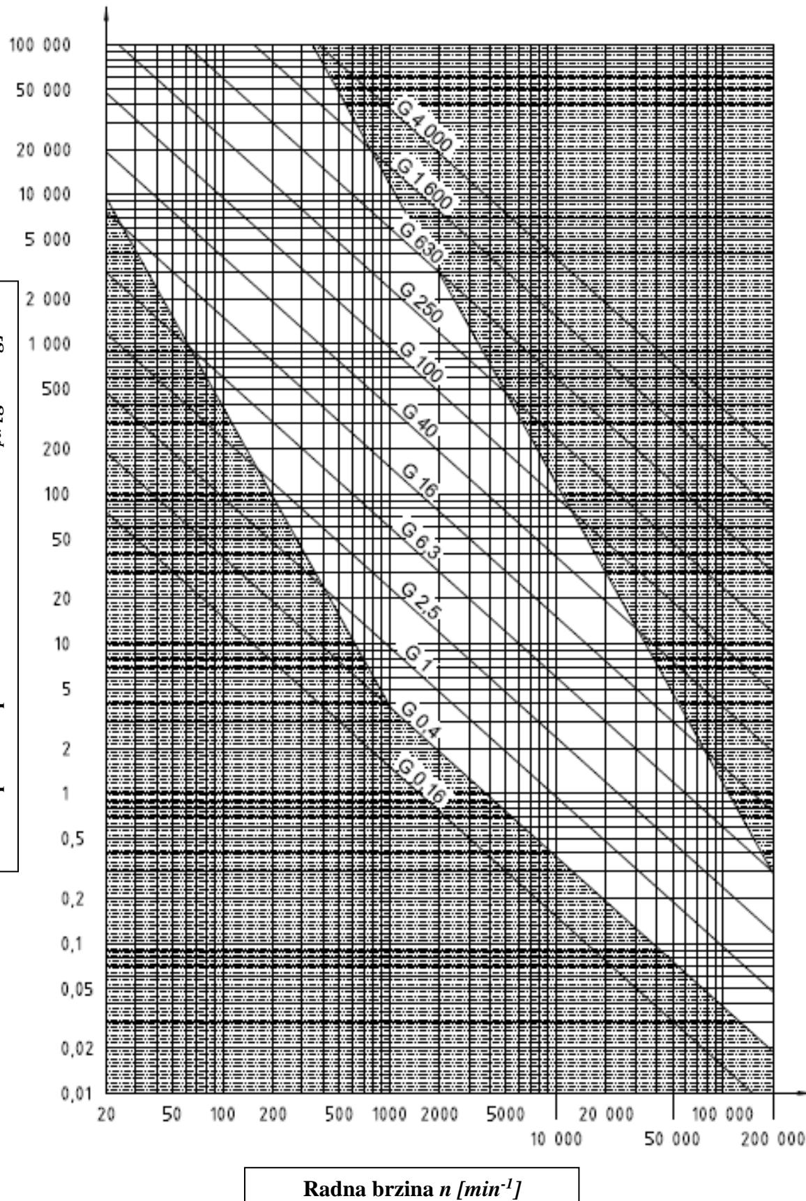
Slika 4. Dopušteni specifični debalans u ovisnosti o brzini rotacije i kvaliteti izvedbe [1]
