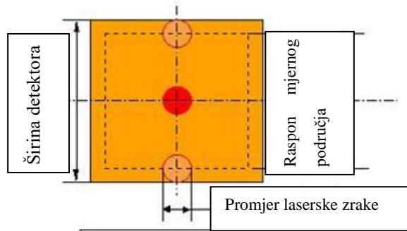
**Slika 23. Prikaz mjerne površine laserskog detektora[1]**
