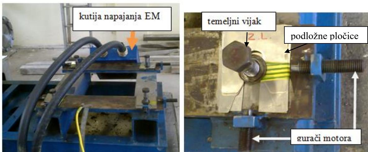
**Slika 35. Prikaz temeljnih vijaka, gurača i napajanja elektromotora**
