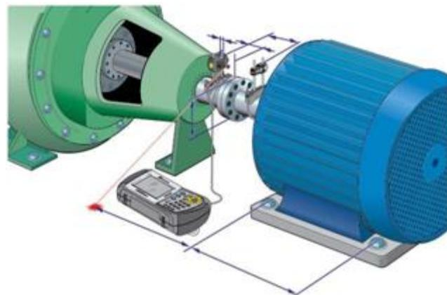
Slika 21. Prikaz laserskog centriranja strojeva s jednim laserom [1]
