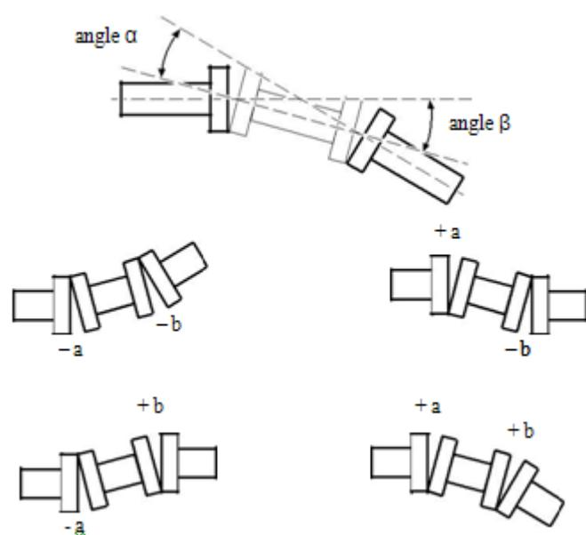
Slika 17. Pomoćni alati kod pozicioniranja stroja [1]
