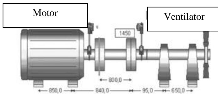
**Slika 25. Primjer centriranja s odstojnikom kraćim od 1000mm [1]**
