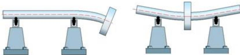
**Slika 8. Progib vratila ovisno o razmještaju mase [1]**
