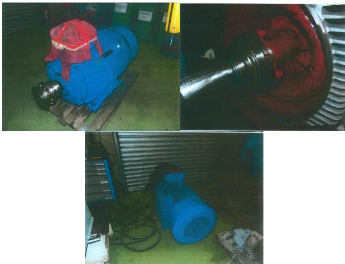
Slika 32. Elektromotor po dolasku u radionicu, rastavljen, repariran i ispitana [11]
