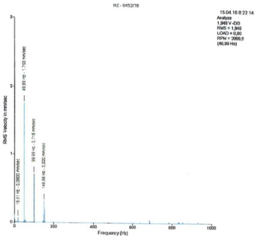
Slika 49. Spektar vibracijskog signala PS za y os
