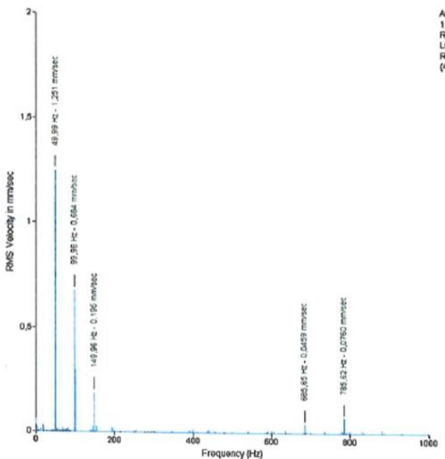
Slika 48. Spektar vibracijskog signala PS za x os
