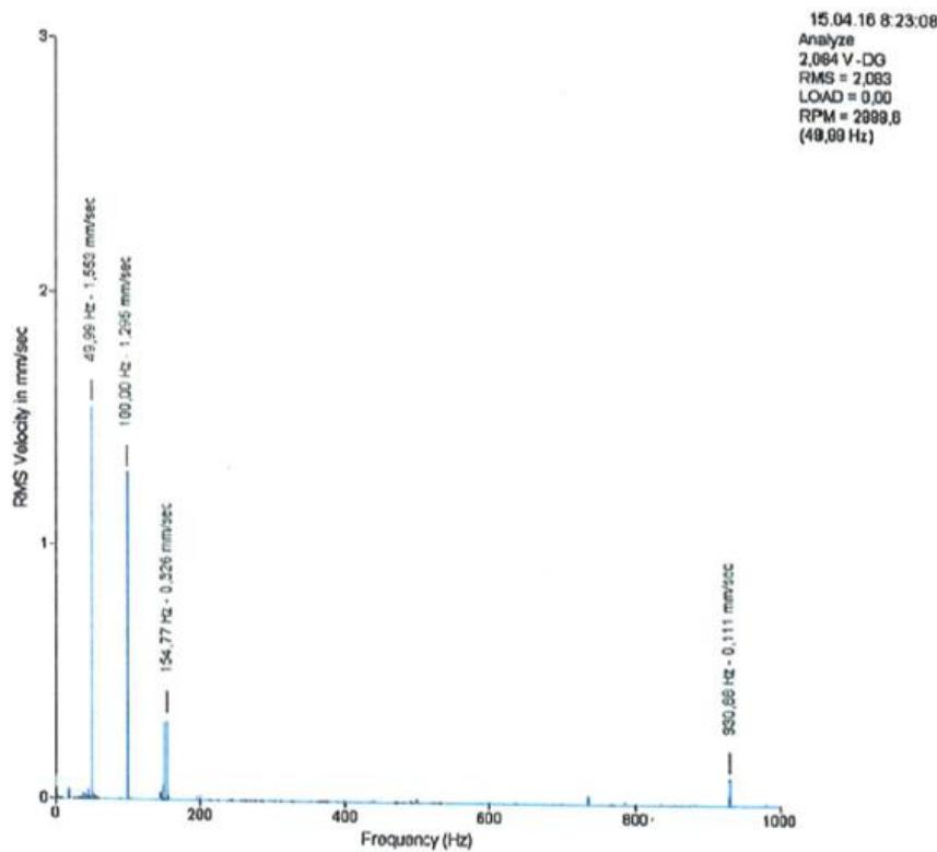
Slika 52. Spektar vibracijskog signala SS za y os
