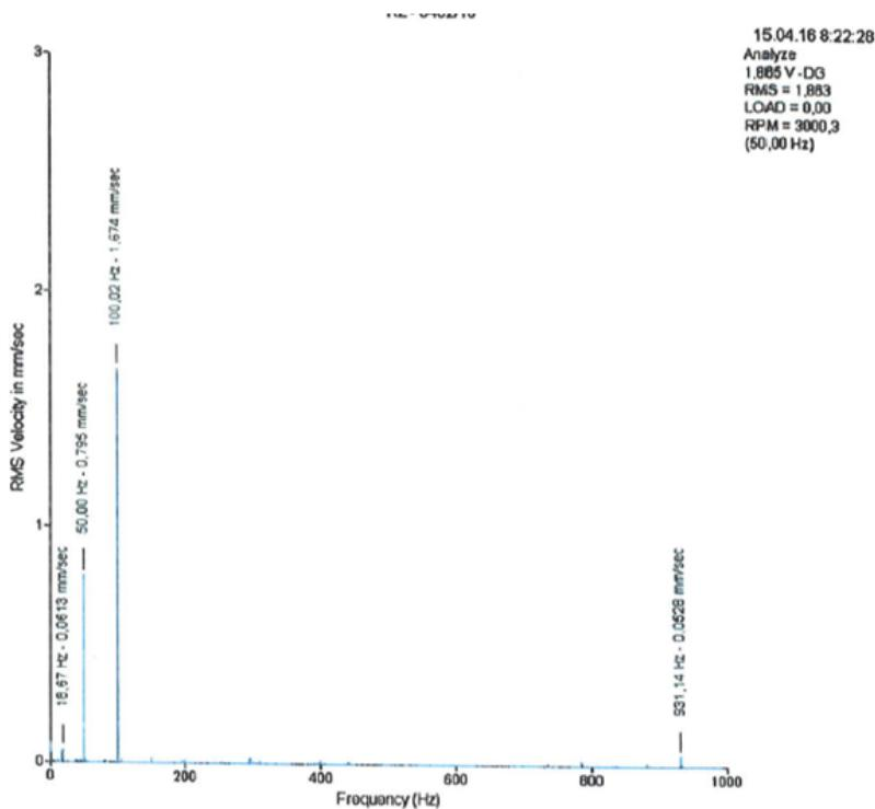
Slika 50. Spektar vibracijskog signala PS za z os
