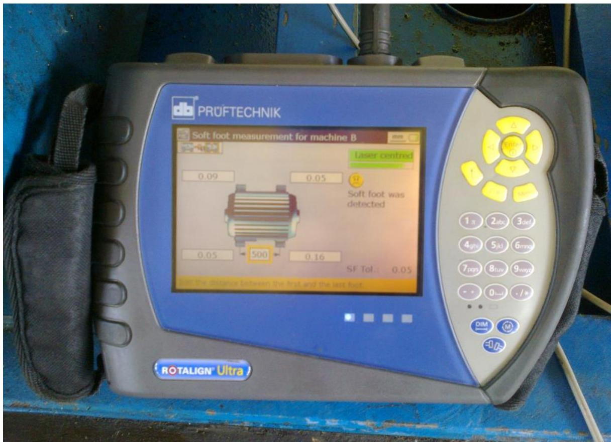
Slika 43. Postupak detekcije i otklanjanja „soft foota“
