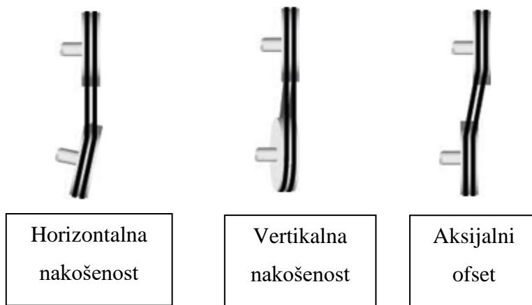
Slika 27. Moguće vrste nepravilnosti kod remenica [1]
