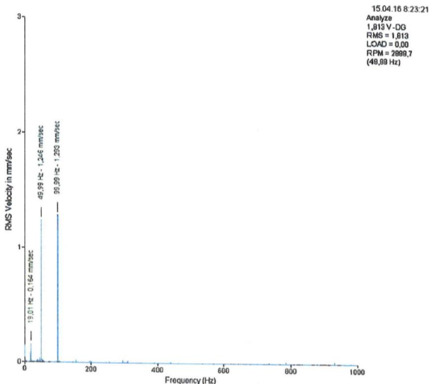
Slika 53. Spektar vibracijskog signala SS za z os
