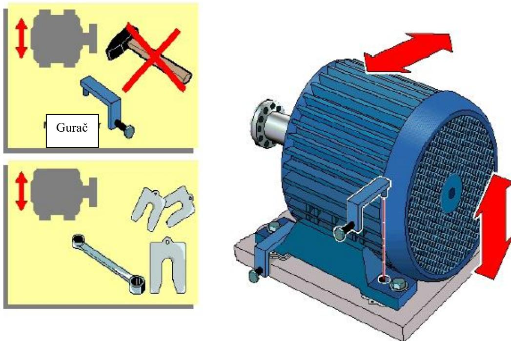
Slika 18. Alati za pomoć kod pozicioniranja stroja [1]
