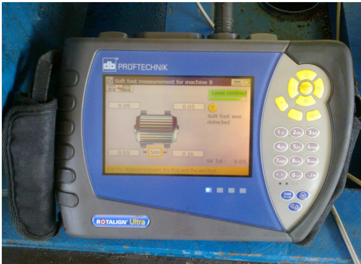
Slika 43. Postupak detekcije i otklanjanja „soft foot“
