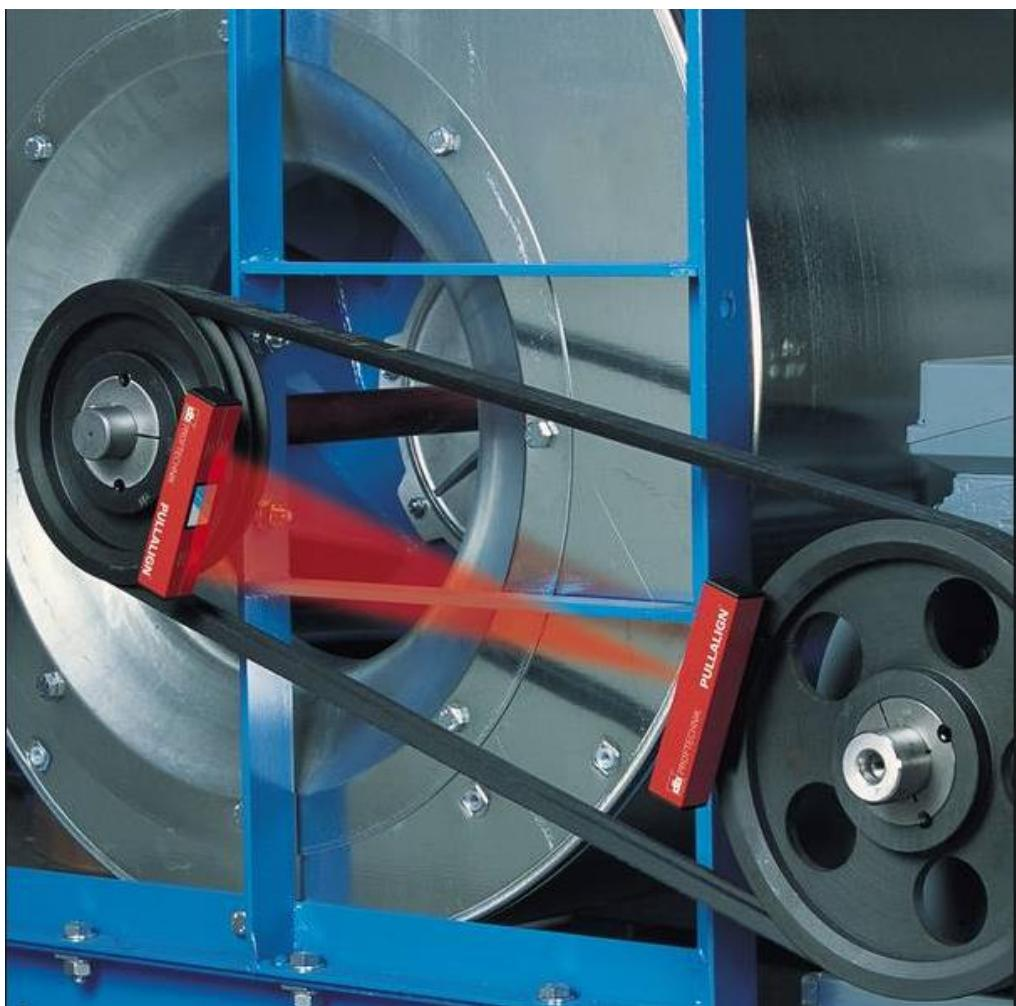
Slika 28. Montiranje sustava PullAlign za lasersko centriranje na remenice [10]
