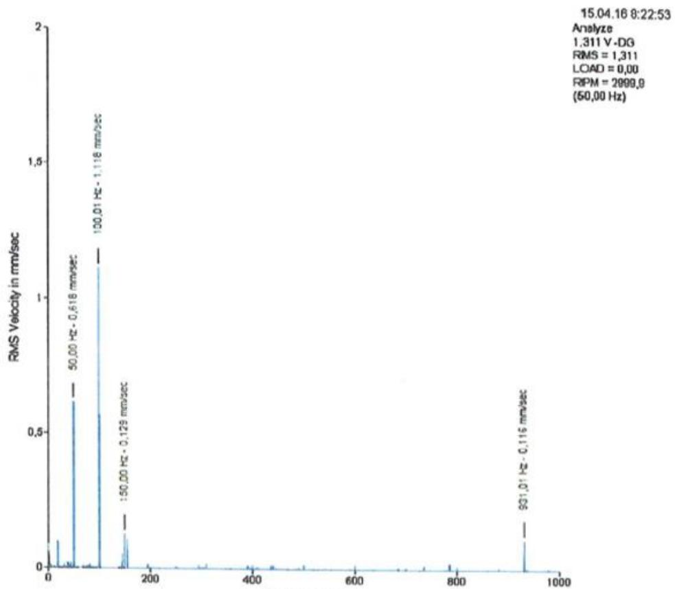
Slika 51. Spektar vibracijskog signala SS za x os
