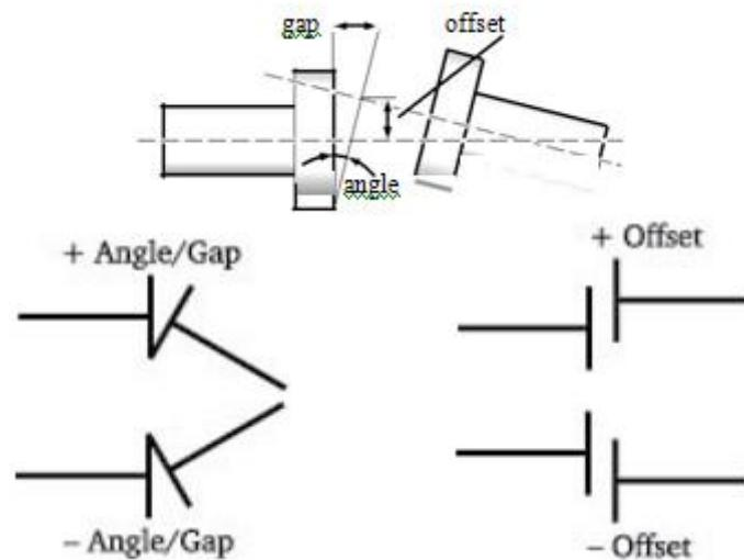
Slika 16. Mogući položaji kod centriranja strojeva s spojkom bez odstojnika[1]
