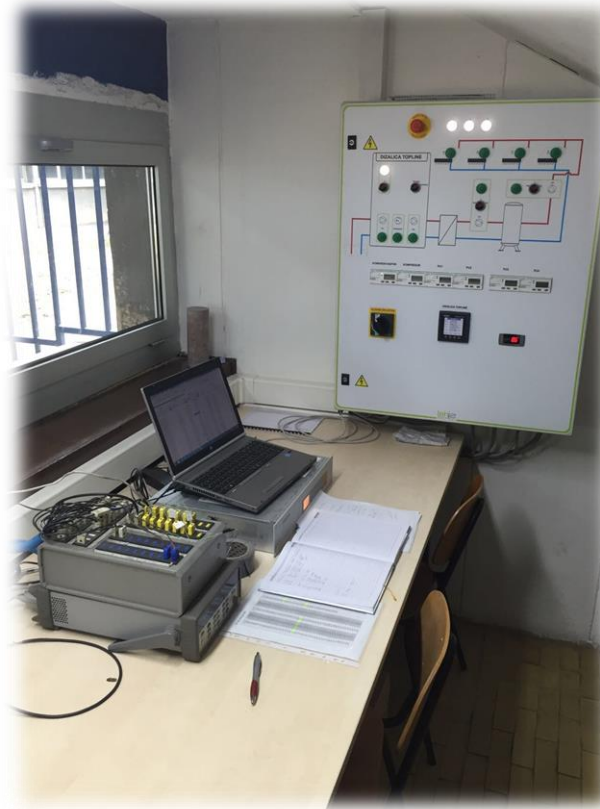
Slika 6-8. Sustav za praćenje i pohranu parametara rada tijekom rada
