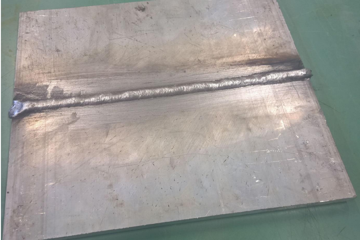
Slika 27. Korijen zavara uzorka B
