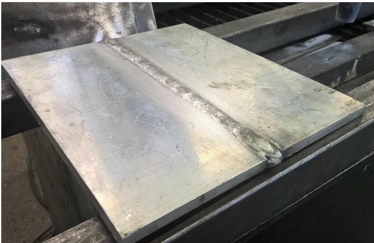
Slika 24. Lice zavara uzorka A
