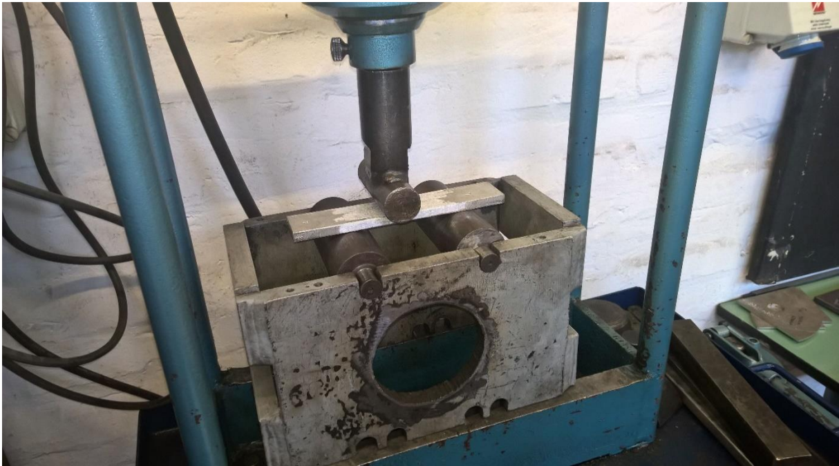
Slika 39. Ispitivanje savijanjem u Laboratoriju za zavarivanje FSB
