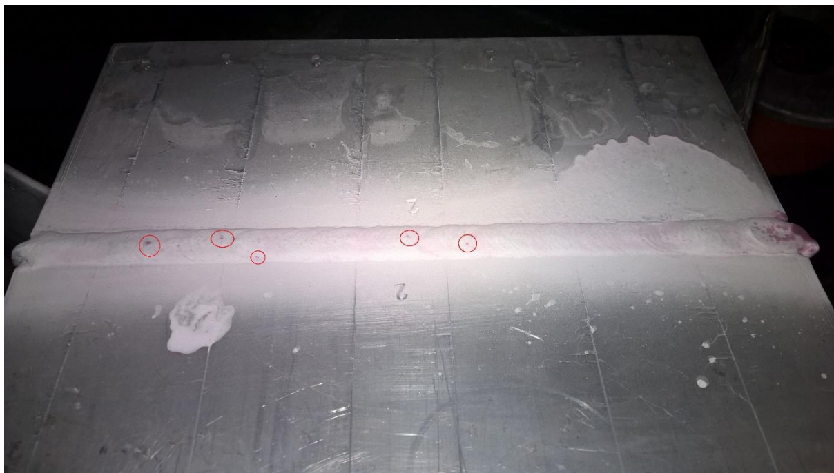
Slika 30. Lice zavara uzorka B nakon ispitivanja penetrantima
